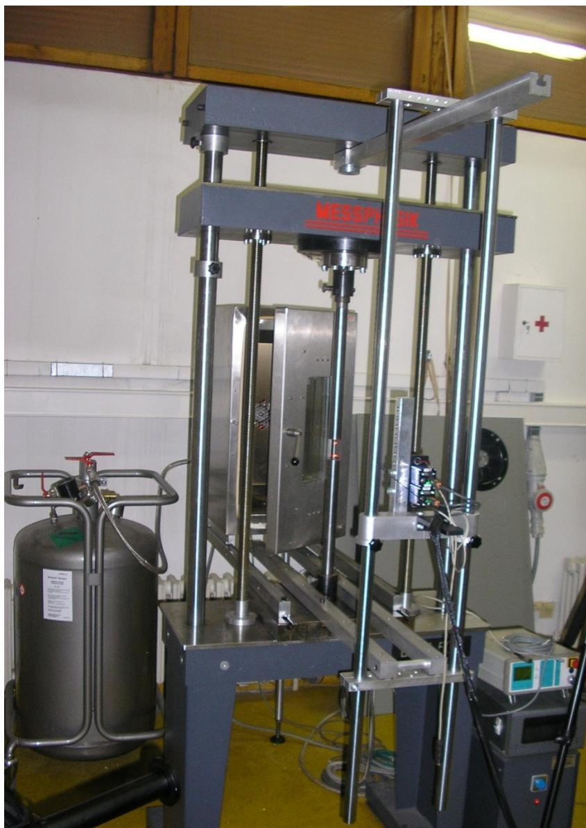
Slika 5.1 Statička kidalica Messphysik Beta 50-5
