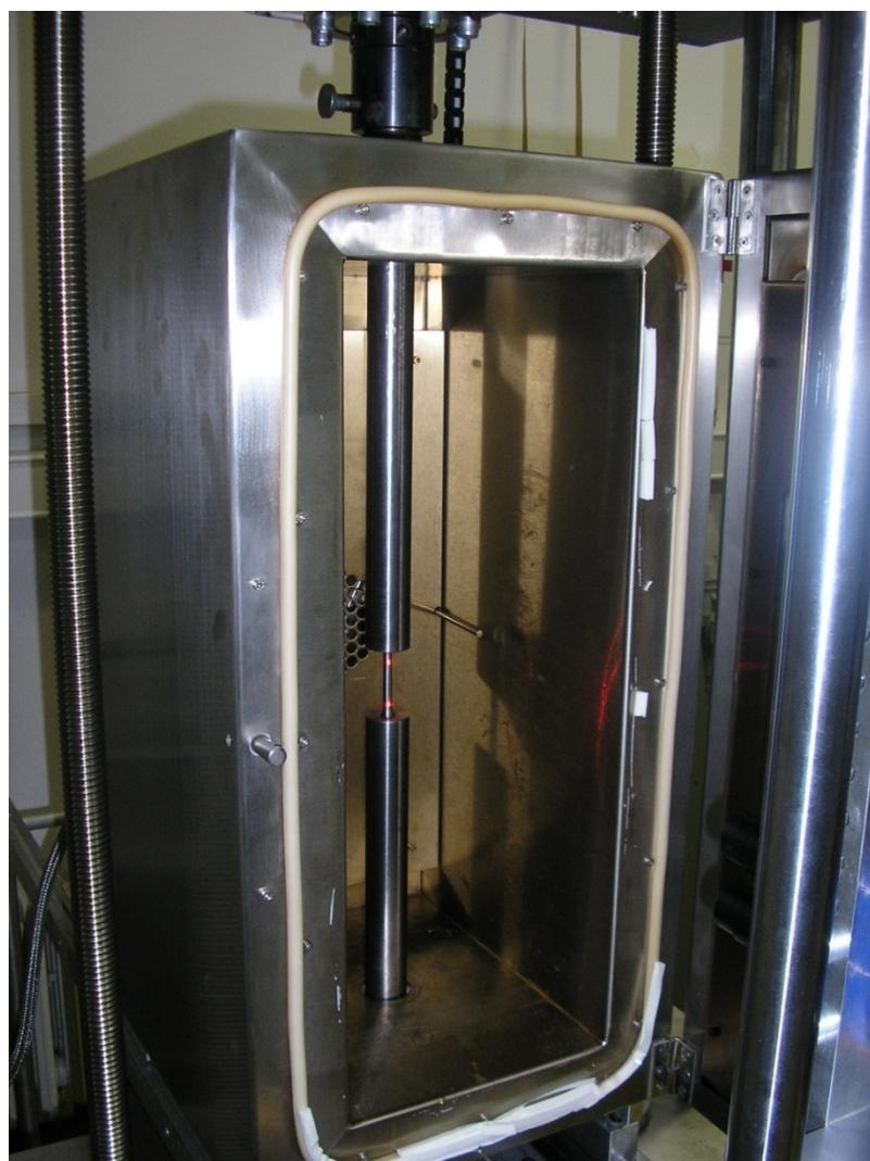
Slika 5.8 Epruveta učvršćena u navojne šipke
