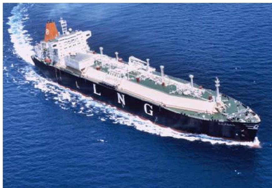
Slika 2.1 LNG brod s membranskim spremnicima
