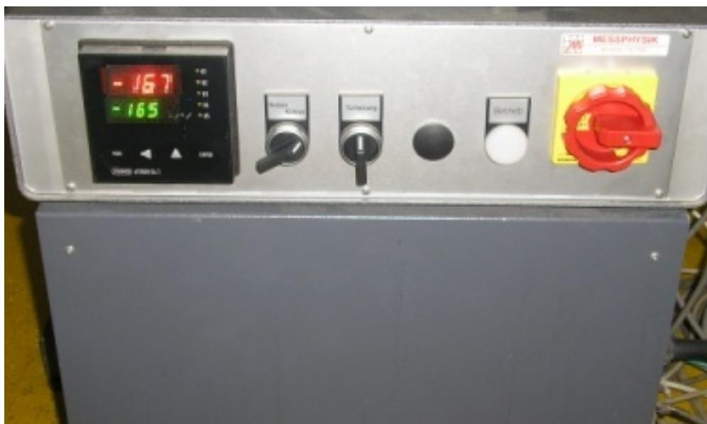
Slika 5.9 Uređaj za regulaciju temperature
