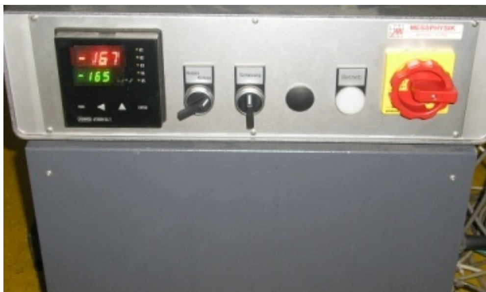
Slika 5.9 Uređaj za regulaciju temperature
