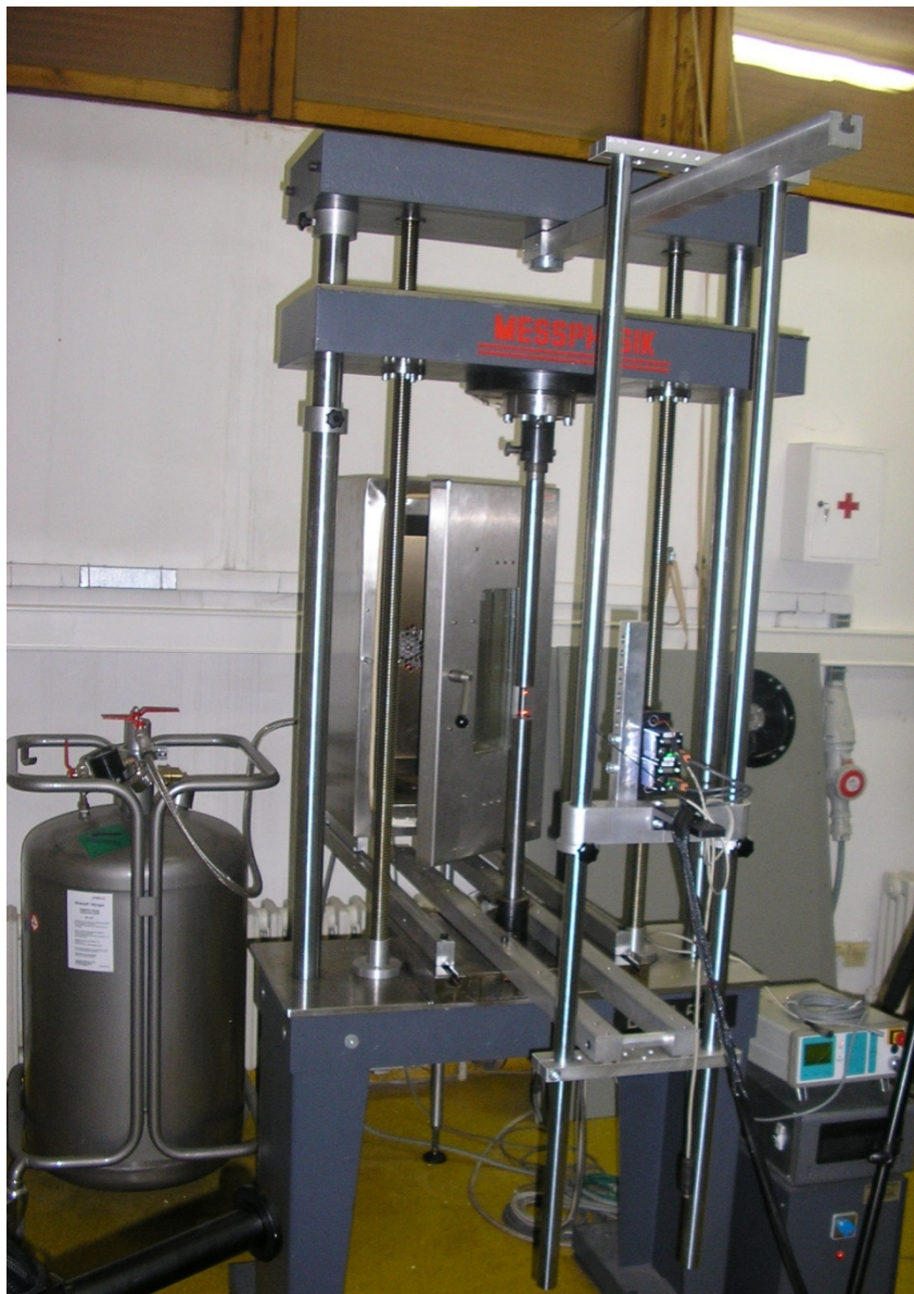
Slika 5.1 Statička kidalica Messphysik Beta 50-5
