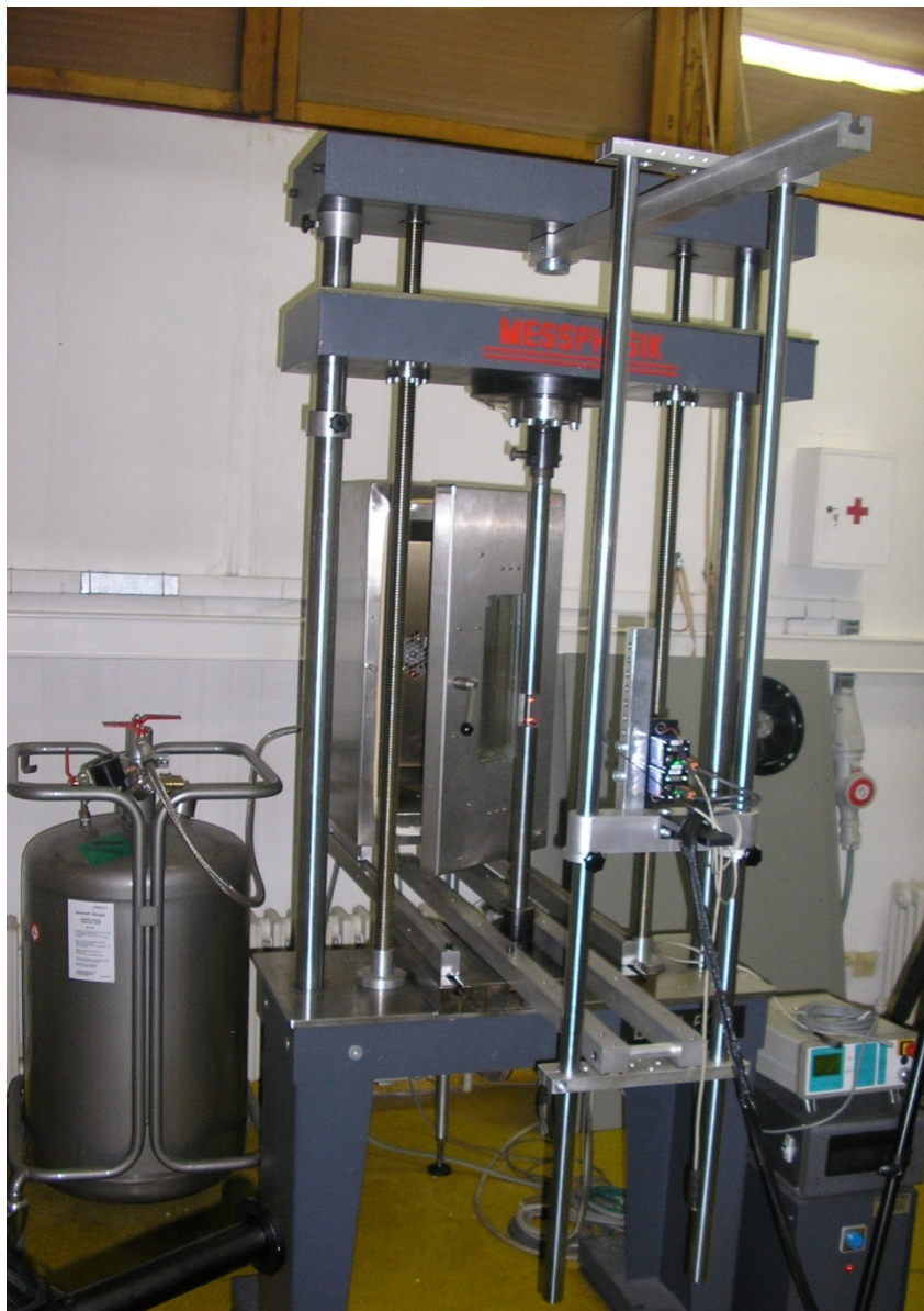
Slika 5.1 Statička kidalica Messphysik Beta 50-5
