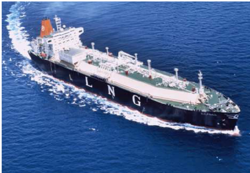
Slika 2.1 LNG brod s membranskim spremnicima
