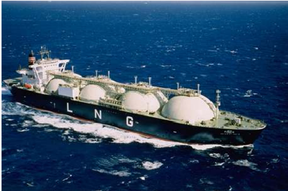
Slika 2.3 LNG brod sa sfernim tankovima
