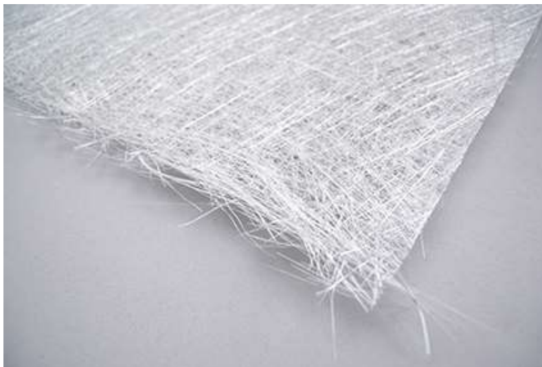
Slika 2.5. Mat staklenih vlakana proizvođača Hacotech [11]
