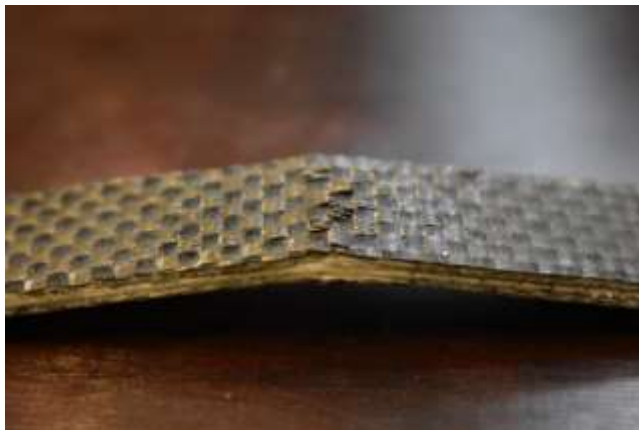
Slika 6.38. Oštećenje ispitnog tijela UMT-S-2 uslijed ispitivanja
