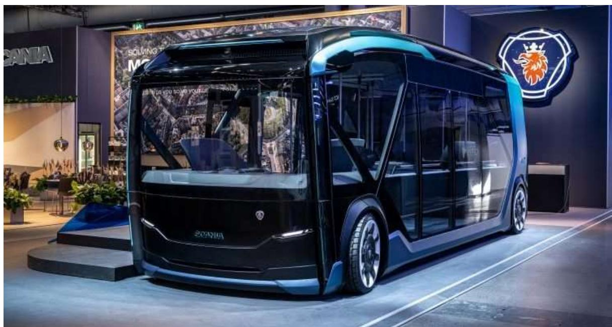
Slika 3.9 *Scania NXT* modularni električni autobus [23]
