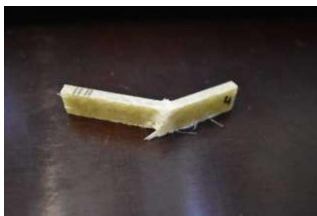
Slika 6.39. Oštećenje ispitnog tijela M-S-4 uslijed ispitivanja
