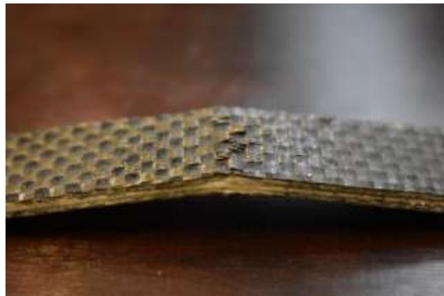
Slika 6.38. Oštećenje ispitnog tijela UMT-S-2 uslijed ispitivanja
