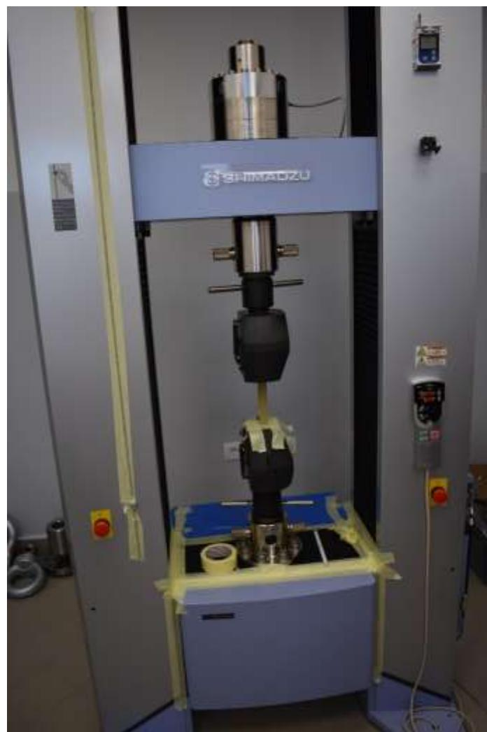
Slika 6.28. Kidalica *Shimadzu AG-X plus*
