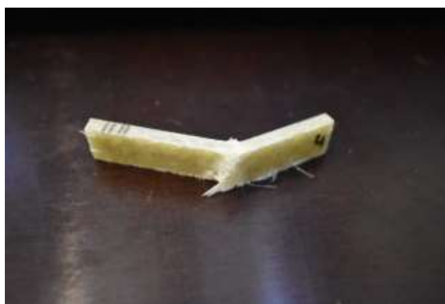
Slika 6.38. Oštećenje ispitnog tijela UMT-S-2 uslijed ispitivanja
