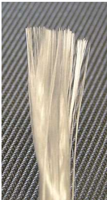
Slika 2.4 Struk staklenih vlakana [10]
