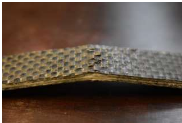
Slika 6.38. Oštećenje ispitnog tijela UMT-S-2 uslijed ispitivanja
