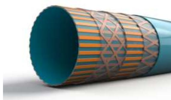
Slika 4.8. Princip *pullwinding* postupka tvrtke EXEL [27]
