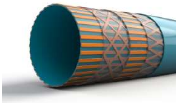
Slika 4.8. Princip pullwinding postupka tvrtke EXEL [27]
