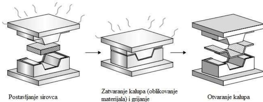
Slika 4.9. Postupak izravnog toplog prešanja [28]
