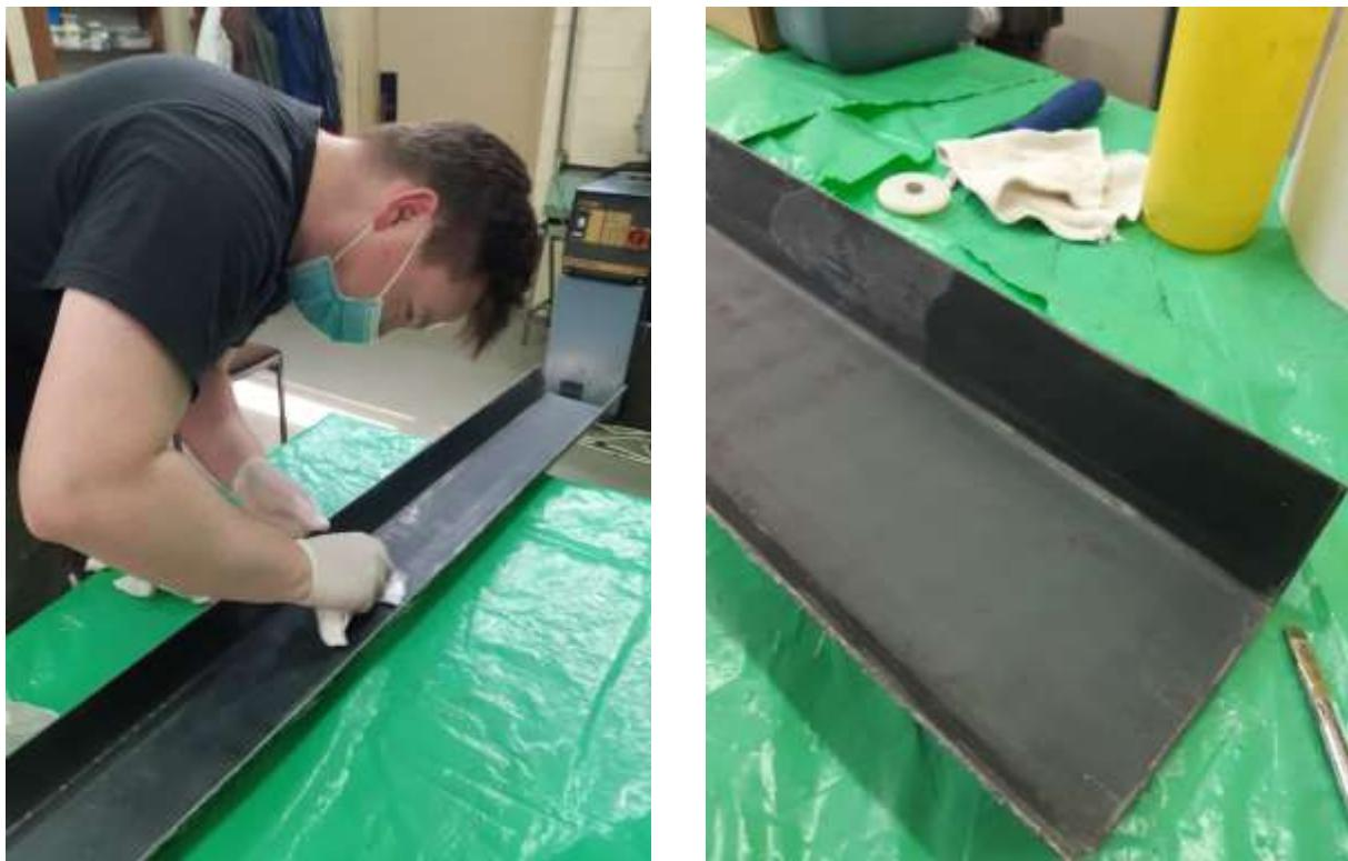
Slika 6.4 Nanošenje i poliranje odvajala
