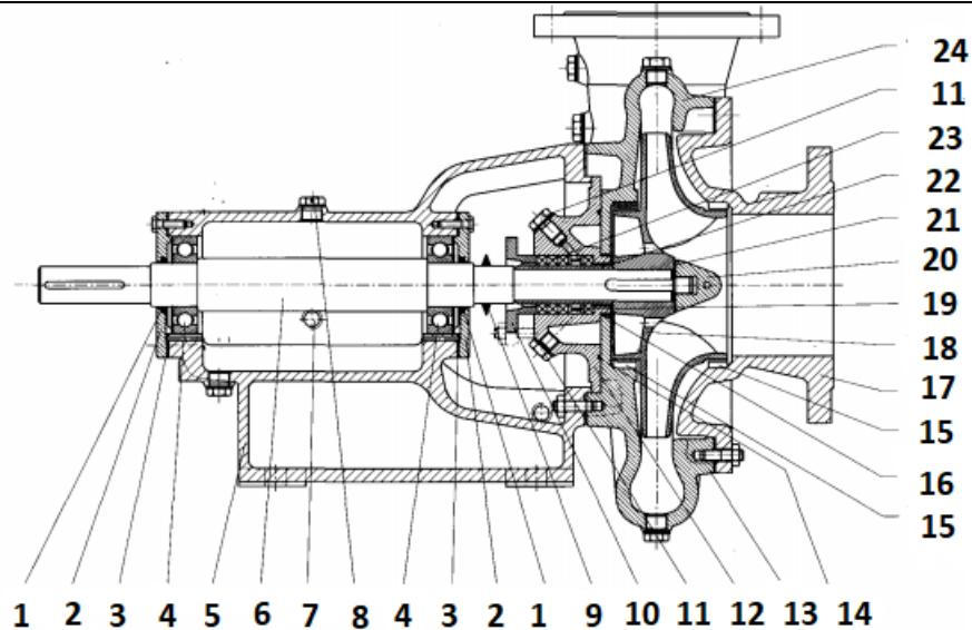
**Slika 28. Presjek pumpe [13]**
