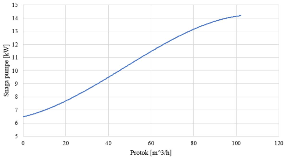
**Slika 38. Snaga pumpe u ovisnosti o protoku**
