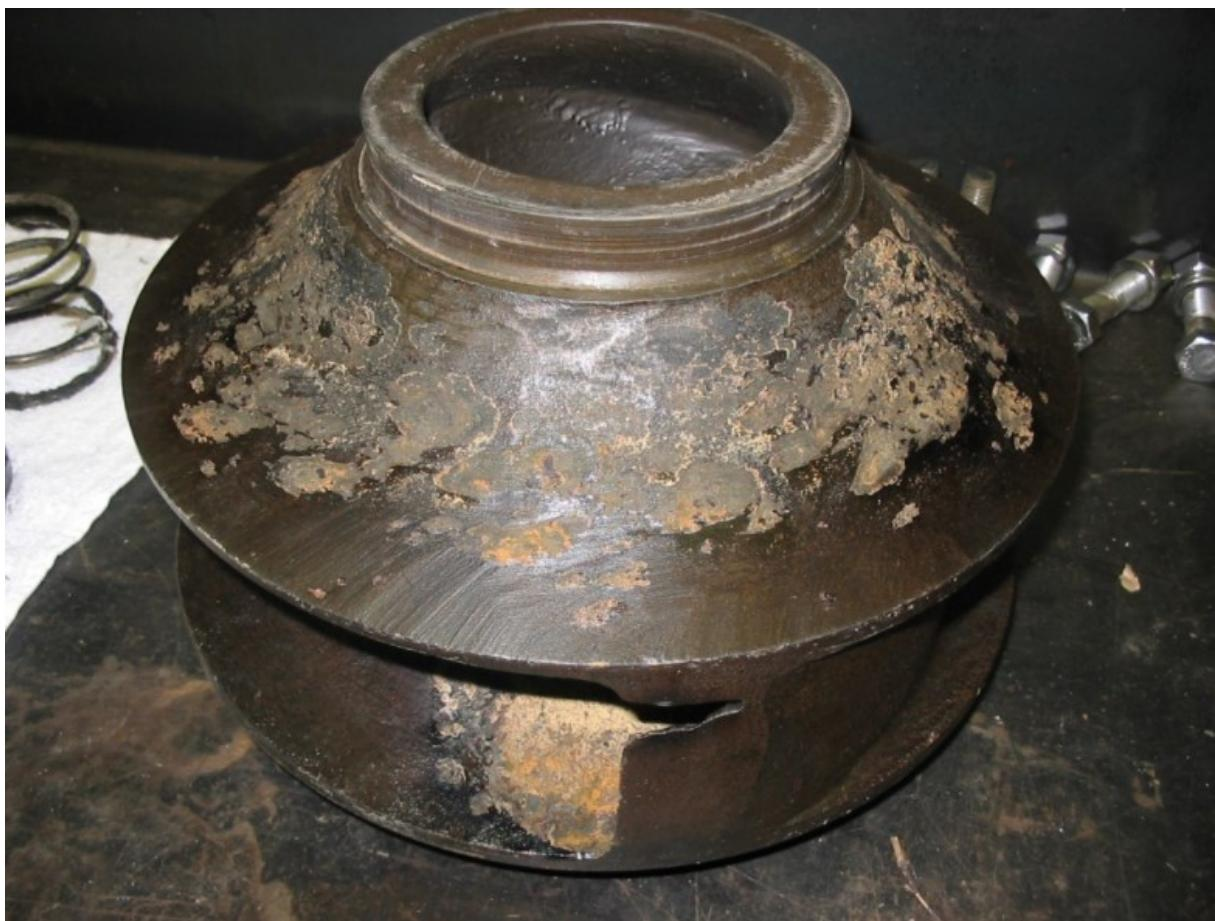
Slika 17. Rotor pumpe oštećen kavitacijom [7]
