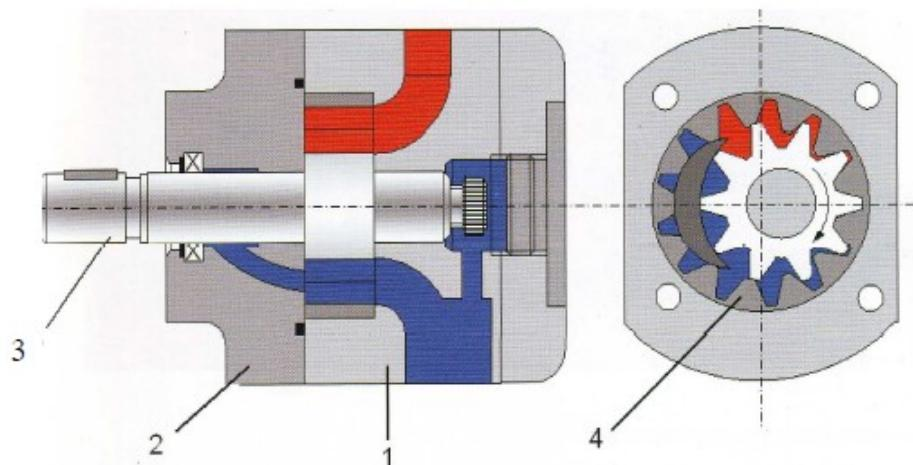
Slika 5. Zupčasta pumpa sa unutarnjim ozubljenjem [3]
