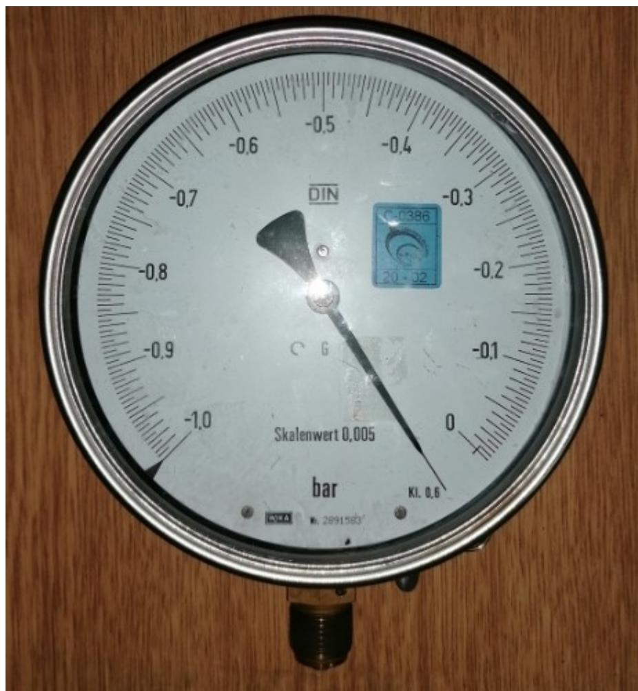
**Slika 30. Vakuummetar**
