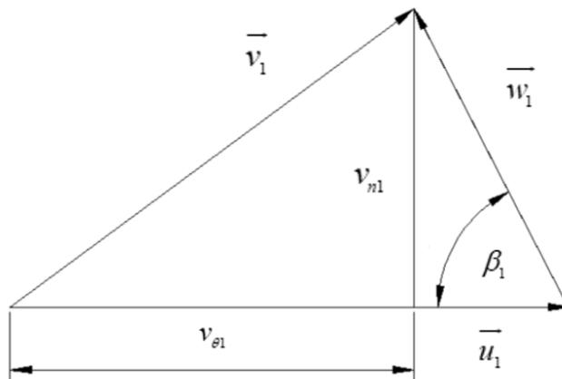
Slika 15. Trokut brzina na ulazu rotora [5]
