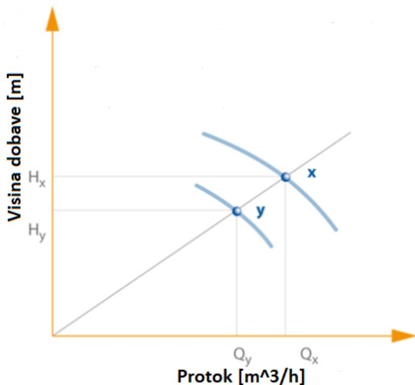
Slika 24. Utjecaj redukcije rotora na karakteristiku pumpe [10]
