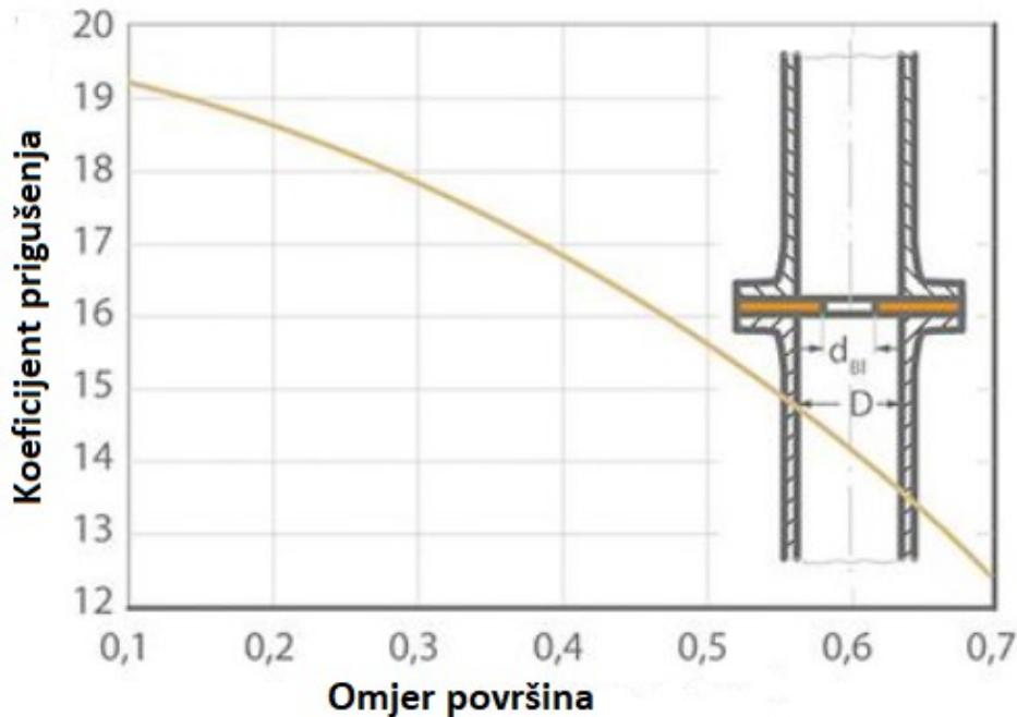
Slika 26. Ovisnost koeficijenta prigušenja o omjeru površina [12]
