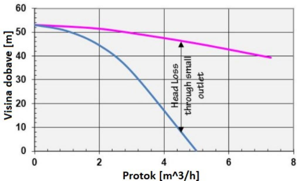
Slika 25. Prikaz prigušene karakteristike pumpe [11]
