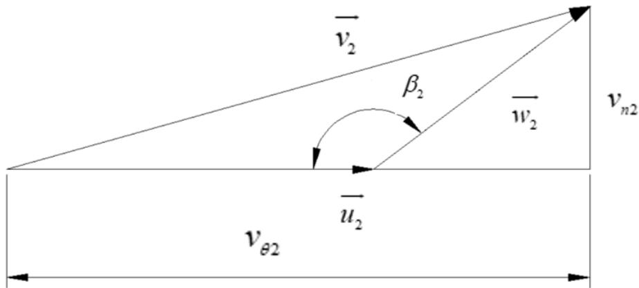
**Slika 16. Trokut brzina na izlazu iz rotora [5]**
