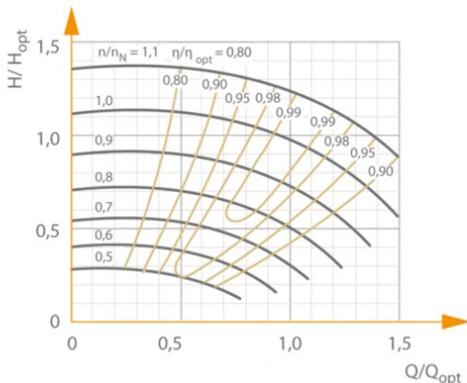
Slika 23. Karakteristika centrifugalne pumpe [9]
