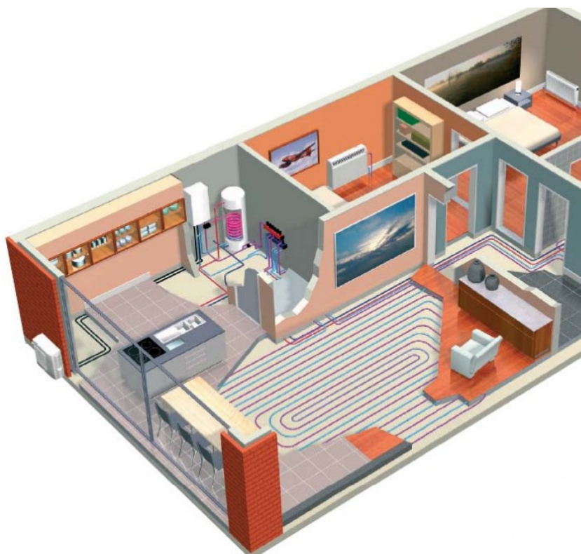
Slika 9. Shematski prikaz sustava zrak-voda dizalice topline [10]
