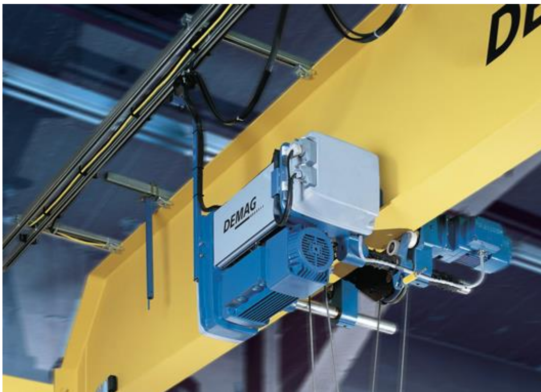
Slika 2. Mosni granik s jednim glavnim nosačem [1]
