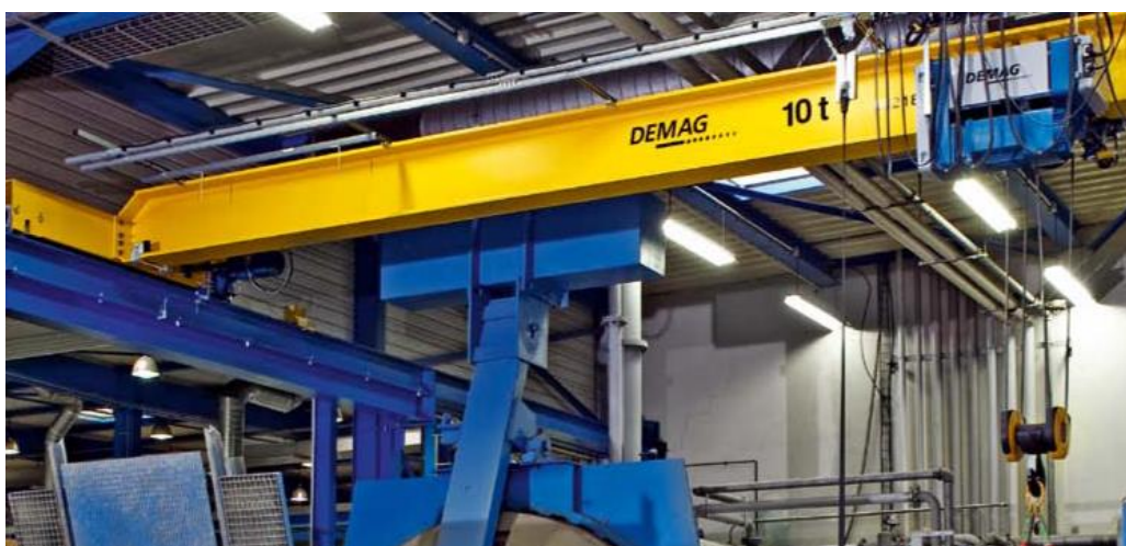
Slika 4. Mosni granik sa jednim glavnim nosačem [2]
