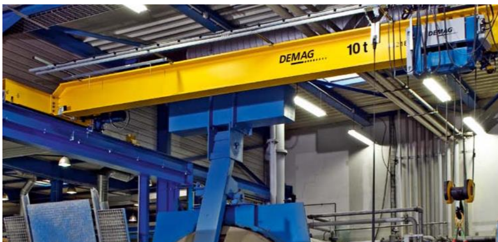
Slika 4. Mosni granik sa jednim glavnim nosačem [2]
