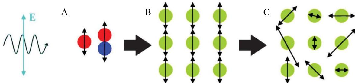
**Slika 3.11** Pretvorba energije tijekom mikrovalnog zagrijavanja: (A) električno polje, E, uzrokuje oscilacije nabijenih čestica i dipolnu polarizaciju unutar krutine (B) što dovodi do vibracija rešetki (C) koje su zatim „termalizirane“ uslijed proizvoljnih ravnotežnih toplinskih gibanja [56]
