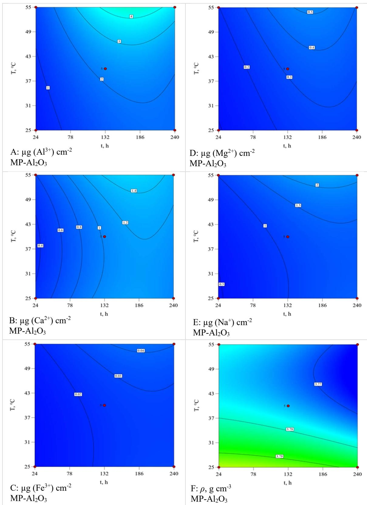
**Slika 7.46** Konturni dijagrami količina eluiranih iona (A)  $\text{Al}^{3+}$ , (B)  $\text{Ca}^{2+}$ , (C)  $\text{Fe}^{3+}$ , (D)  $\text{Mg}^{2+}$  i (E)  $\text{Na}^{+}$  iz  $\text{Al}_2\text{O}_3$  keramike te (F) gustoće  $\text{Al}_2\text{O}_3$  keramike sinterirane u hibridnoj mikrovalnoj peći (MP- $\text{Al}_2\text{O}_3$ ) nakon izlaganja u  $\text{HNO}_3$  u ovisnosti o vremenu i temperaturi pri konstantnoj koncentraciji  $\text{HNO}_3$   $1,25 \text{ mol dm}^{-3}$
