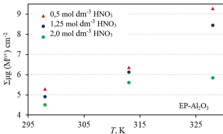
**Slika 7.38** Ukupna količina eluiranih iona ovisno o temperaturi u različitim koncentracijama  $\text{HNO}_3$  iz  $\text{Al}_2\text{O}_3$  keramike sinterirane u električnoj peći (EP- $\text{Al}_2\text{O}_3$ )
