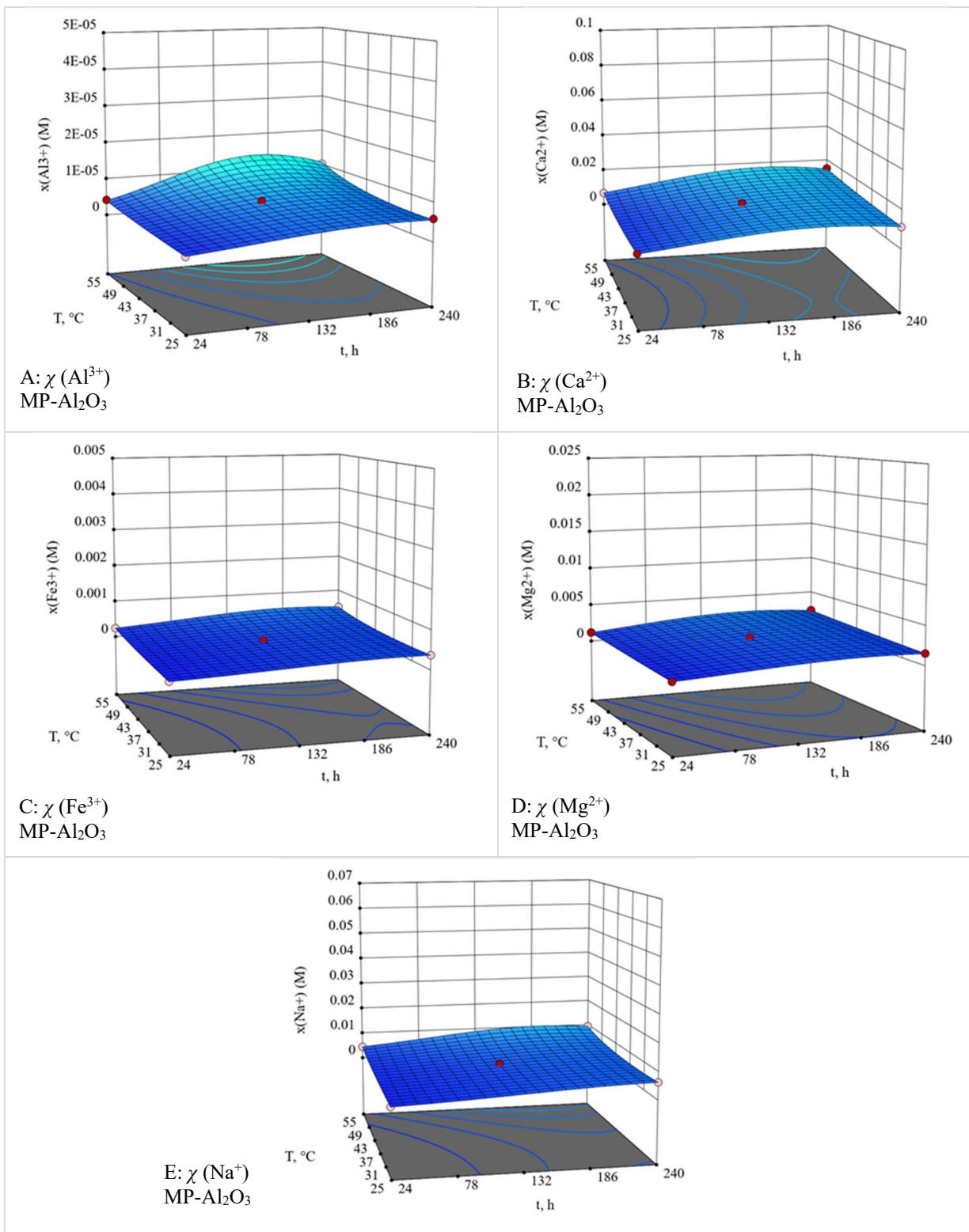
**Slika 7.52** 3D dijagrami stupnjeva otapanja (A)  $\text{Al}^{3+}$ , (B)  $\text{Ca}^{2+}$ , (C)  $\text{Fe}^{3+}$ , (D)  $\text{Mg}^{2+}$  i (E)  $\text{Na}^+$  iona iz  $\text{Al}_2\text{O}_3$  keramike sinterirane u hibridnoj mikrovalnoj peći (MP- $\text{Al}_2\text{O}_3$ ) u ovisnosti o vremenu i temperaturi pri konstantnoj koncentraciji  $\text{HNO}_3$   $1,25 \text{ mol dm}^{-3}$
