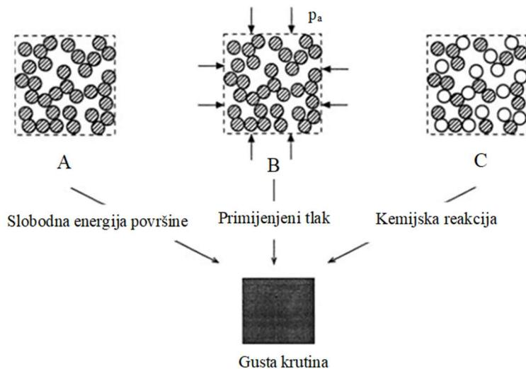
**Slika 3.1** Pokretačke sile sinteriranja: (A) slobodna energija površine, (B) primjenjeni tlak i (C) kemijska reakcija [55]
