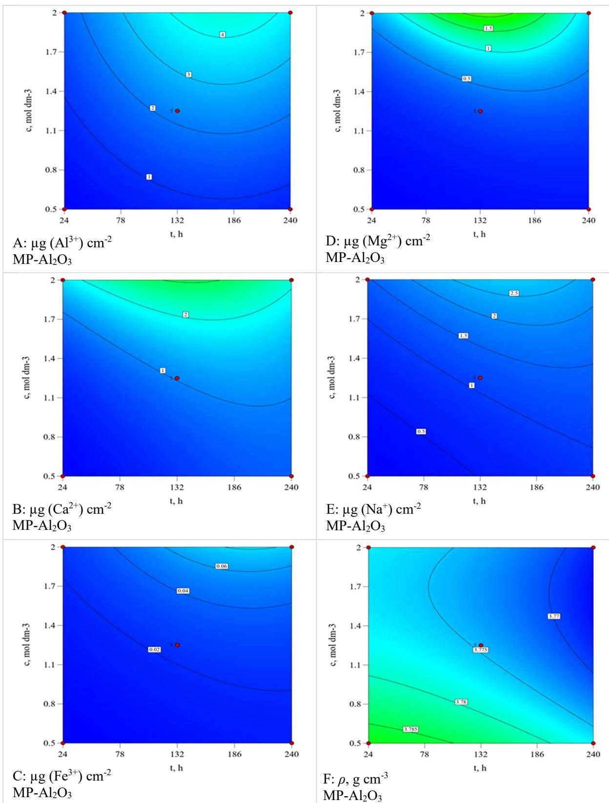
**Slika 7.47** Konturni dijagrami količina eluiranih iona (A)  $\text{Al}^{3+}$ , (B)  $\text{Ca}^{2+}$ , (C)  $\text{Fe}^{3+}$ , (D)  $\text{Mg}^{2+}$  i (E)  $\text{Na}^{+}$  iz aluminijeve oksidne ( $\text{Al}_2\text{O}_3$ ) keramike te (F) gustoće  $\text{Al}_2\text{O}_3$  keramike sinterirane u hibridnoj mikrovalnoj peći ( $\text{MP-Al}_2\text{O}_3$ ) nakon izlaganja u  $\text{HNO}_3$  u ovisnosti o vremenu i koncentraciji  $\text{HNO}_3$  pri konstantnoj temperaturi 40°C
