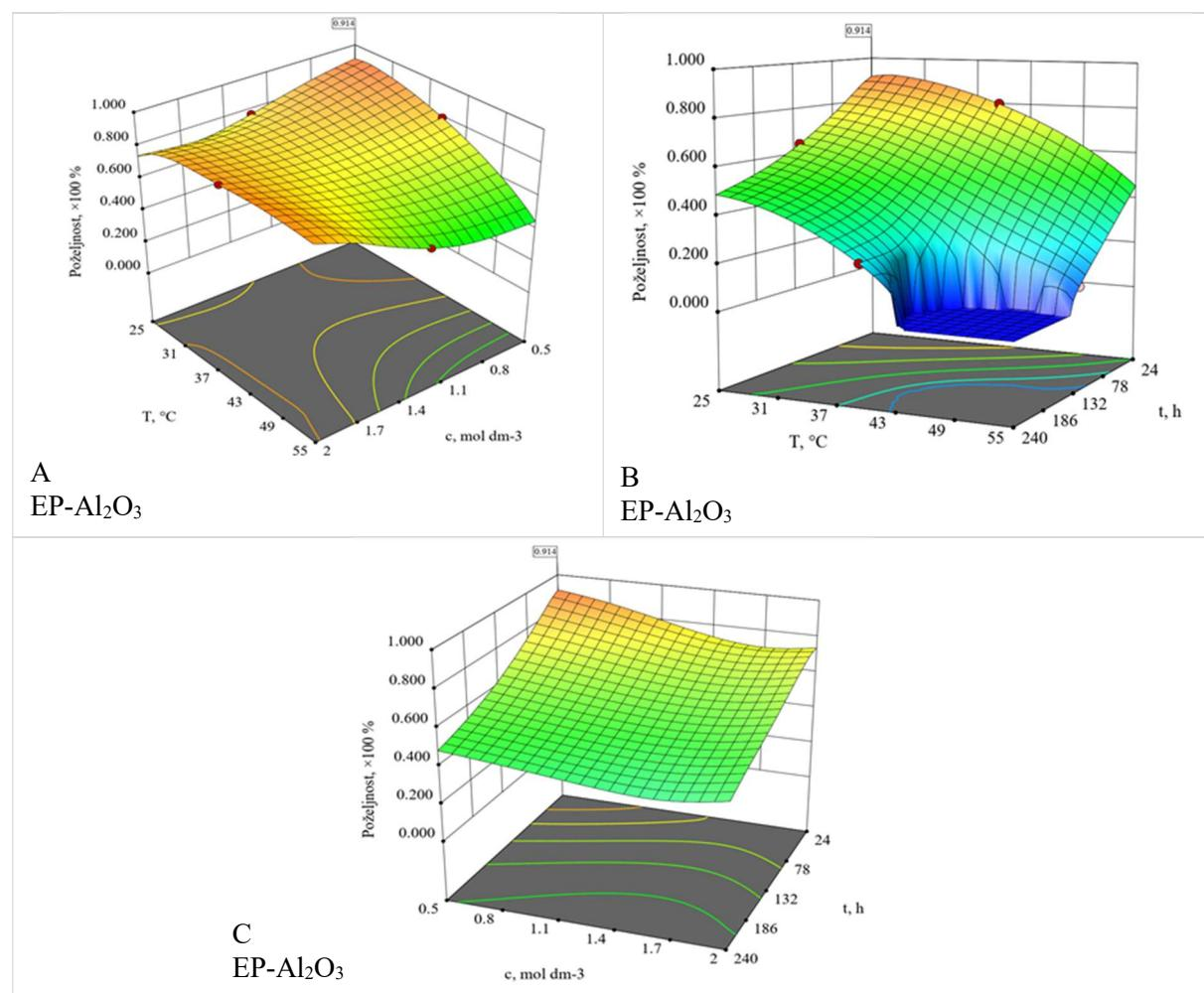
**Slika 7.54** Funkcija poželjnosti količina eluiranih iona i gustoće  $\text{Al}_2\text{O}_3$  keramike sinterirane u električnoj peći (EP- $\text{Al}_2\text{O}_3$ ) u ovisnosti o (A) koncentraciji  $\text{HNO}_3$  i temperaturi pri konstantnom vremenu 24 h, (B) temperaturi i vremenu pri konstantnoj koncentraciji  $\text{HNO}_3$   $0,5 \text{ mol dm}^{-3}$ , (C) koncentraciji  $\text{HNO}_3$  i vremenu pri konstantnoj temperaturi  $25^\circ\text{C}$
