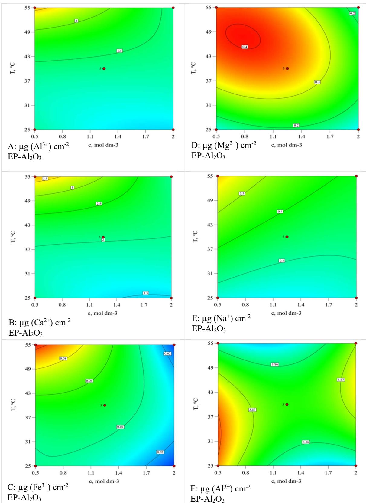
**Slika 7.42** Konturni dijagrami količina eluiranih iona (A)  $\text{Al}^{3+}$ , (B)  $\text{Ca}^{2+}$ , (C)  $\text{Fe}^{3+}$ , (D)  $\text{Mg}^{2+}$  i (E)  $\text{Na}^{+}$  iz  $\text{Al}_2\text{O}_3$  keramike te (F) gustoće  $\text{Al}_2\text{O}_3$  keramike sinterirane u električnoj peći (EP- $\text{Al}_2\text{O}_3$ ) nakon izlaganja u  $\text{HNO}_3$  u ovisnosti o koncentraciji i temperaturi pri konstantnom vremenu 132 h
