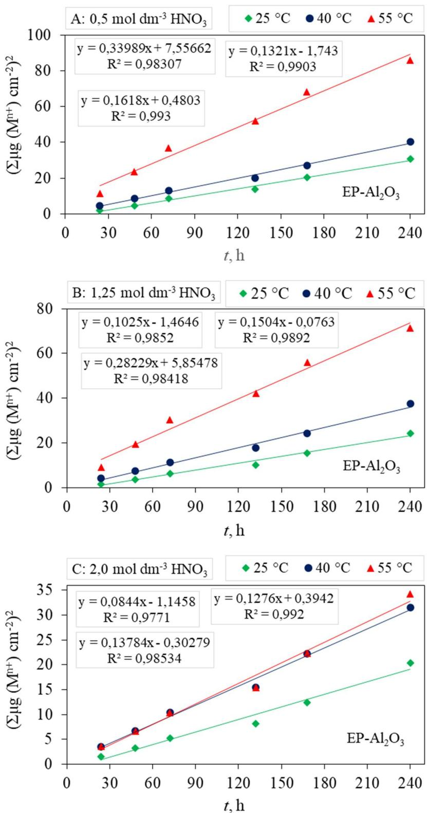
**Slika 7.36** Ovisnost kvadrata ukupne količine eluiranih iona u otopini  $\text{HNO}_3$  o vremenu izloženosti  $\text{Al}_2\text{O}_3$  keramike sinterirane u električnoj peći (EP- $\text{Al}_2\text{O}_3$ ) za koncentracije  $\text{HNO}_3$ : (A)  $0,5 \text{ mol dm}^{-3}$ , (B)  $1,25 \text{ mol dm}^{-3}$  i (C)  $2 \text{ mol dm}^{-3}$  pri temperaturama od  $25^\circ\text{C}$ ,  $40^\circ\text{C}$  i  $55^\circ\text{C}$
