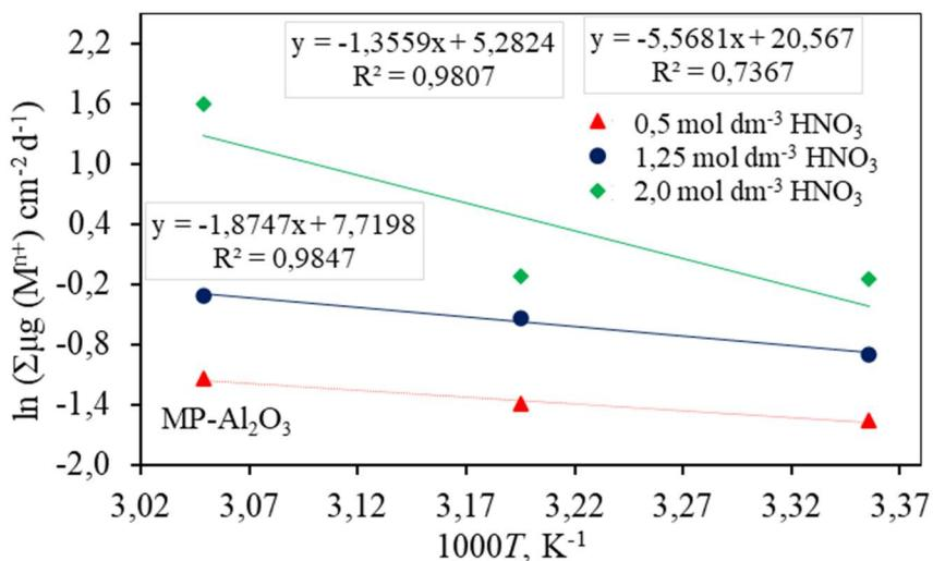
**Slika 7.41** Arrheniusova ovisnost ukupne količine eluiranih iona iz  $\text{Al}_2\text{O}_3$  keramike sinterirane u hibridnoj mikrovalnoj peći (MP- $\text{Al}_2\text{O}_3$ ) o recipročnoj vrijednosti temperature u K za tri koncentracije nitratne kiseline ( $\text{HNO}_3$ )
