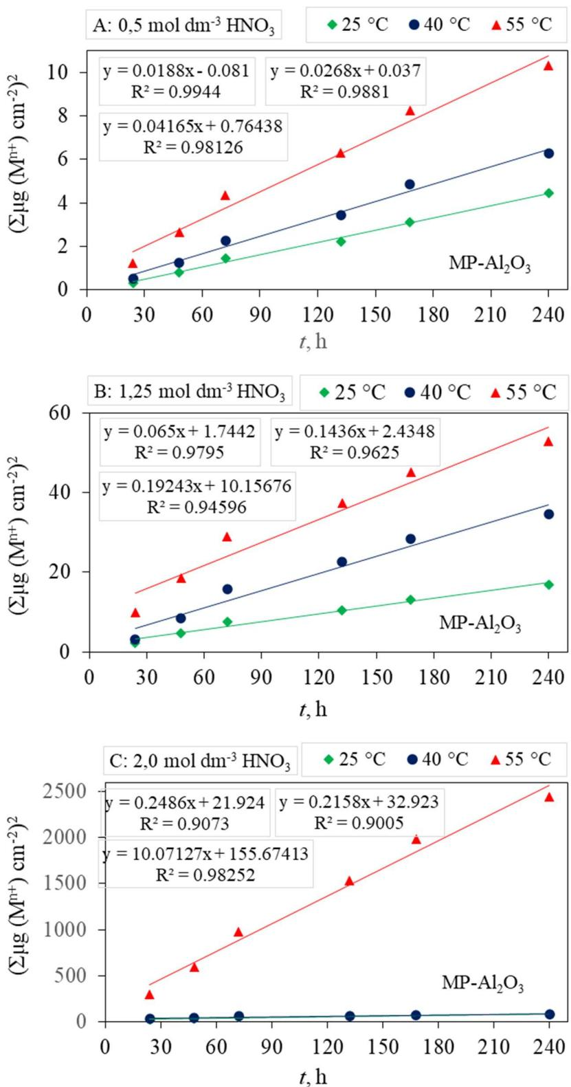
**Slika 7.37** Ovisnost kvadrata ukupne količine eluiranih iona po jedinici površine u HNO<sub>3</sub> o vremenu izloženosti Al<sub>2</sub>O<sub>3</sub> keramike sinterirane u hibridnoj mikrovalnoj peći (MP-Al<sub>2</sub>O<sub>3</sub>) za koncentracije HNO<sub>3</sub>: (A) 0,5 mol dm<sup>-3</sup>, (B) 1,25 mol dm<sup>-3</sup> i (C) 2 mol dm<sup>-3</sup> pri tri temperaturama od 25 °C, 40 °C i 55 °C
