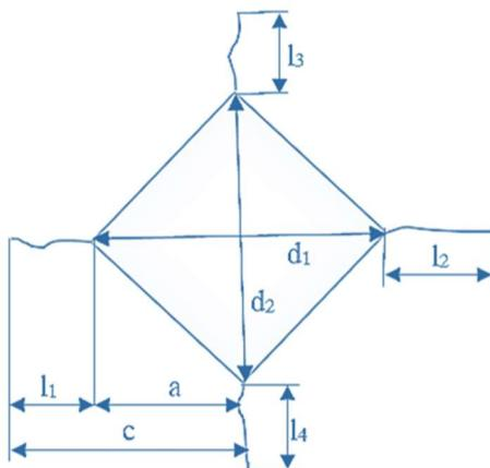
**Slika 7.14** Karakteristične veličine na otisku nakon mjerjenja tvrdoće prema metodi Vickers kod krhkih materijala [155]
