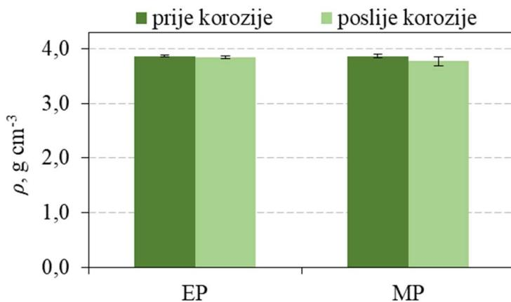
**Slika 7.58** Usporedba vrijednosti gustoće  $\text{Al}_2\text{O}_3$  keramike sinterirane u električnoj (EP) i hibridnoj mikrovalnoj peći (MP) prije i poslije ispitivanja kemijske postojanosti 10 dana u  $2\text{ mol dm}^{-3}$   $\text{HNO}_3$  pri  $55\text{ }^{\circ}\text{C}$  (srednje vrijednosti i standardno odstupanje)
