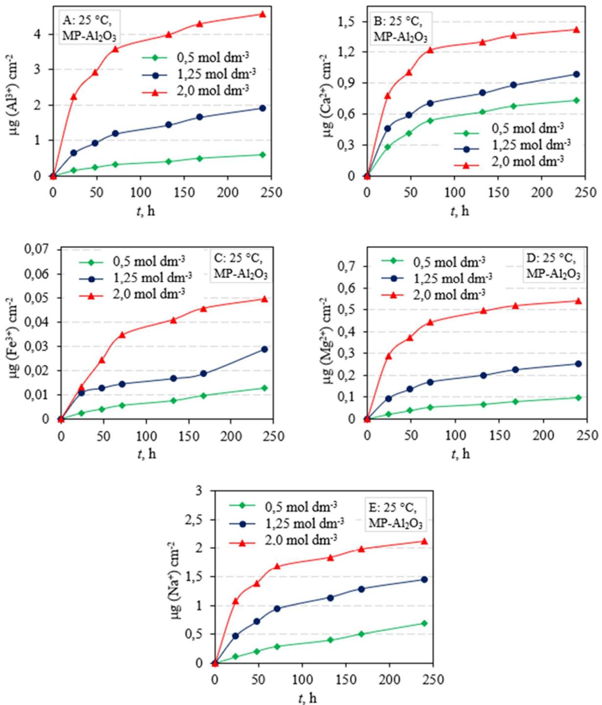
**Slika 7.18** Ovisnost količine (A)  $\text{Al}^{3+}$ , (B)  $\text{Ca}^{2+}$ , (C)  $\text{Fe}^{3+}$ , (D)  $\text{Mg}^{2+}$  i (E)  $\text{Na}^{+}$  eluiranih iona u  $\text{HNO}_3$  o vremenu izloženosti  $\text{Al}_2\text{O}_3$  keramike sinterirane u hibridnoj mikrovalnoj peći ( $\text{MP-Al}_2\text{O}_3$ ) za koncentracije  $\text{HNO}_3$   $0,5 \text{ mol dm}^{-3}$ ,  $1,25 \text{ mol dm}^{-3}$ ,  $2 \text{ mol dm}^{-3}$  pri  $25\text{ }^{\circ}\text{C}$
