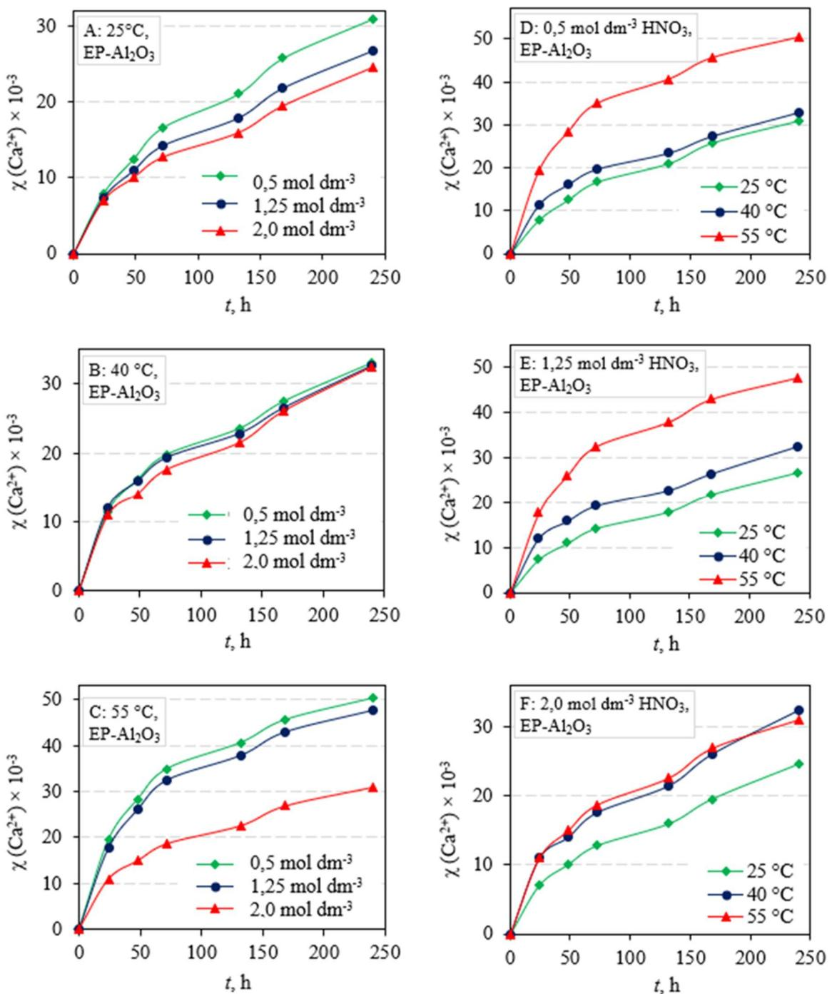
**Slika 7.26** Stupanj otapanja ( $\chi$ )  $\text{Ca}^{2+}$  iz  $\text{Al}_2\text{O}_3$  keramike sinterirane u električnoj peći (EP- $\text{Al}_2\text{O}_3$ ) ovisno o vremenu izloženosti, pri različitim temperaturama: (A) 25 °C, (B) 40 °C, (C) 55 °C i koncentracijama  $\text{HNO}_3$ : (D) 0,5 mol dm<sup>-3</sup>, (E) 1,25 mol dm<sup>-3</sup>, (F) 2 mol dm<sup>-3</sup>
