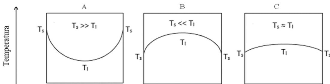
**Slika 3.13** Raspodjela temperature u keramičkom materijalu sinteriranom (A) konvencionalnom, (B) mikrovalnom i (C) hibridnom mikrovalnom metodom ( $T_s$  – temperatura površine;  $T_l$  – unutarnja temperatura) [65]
