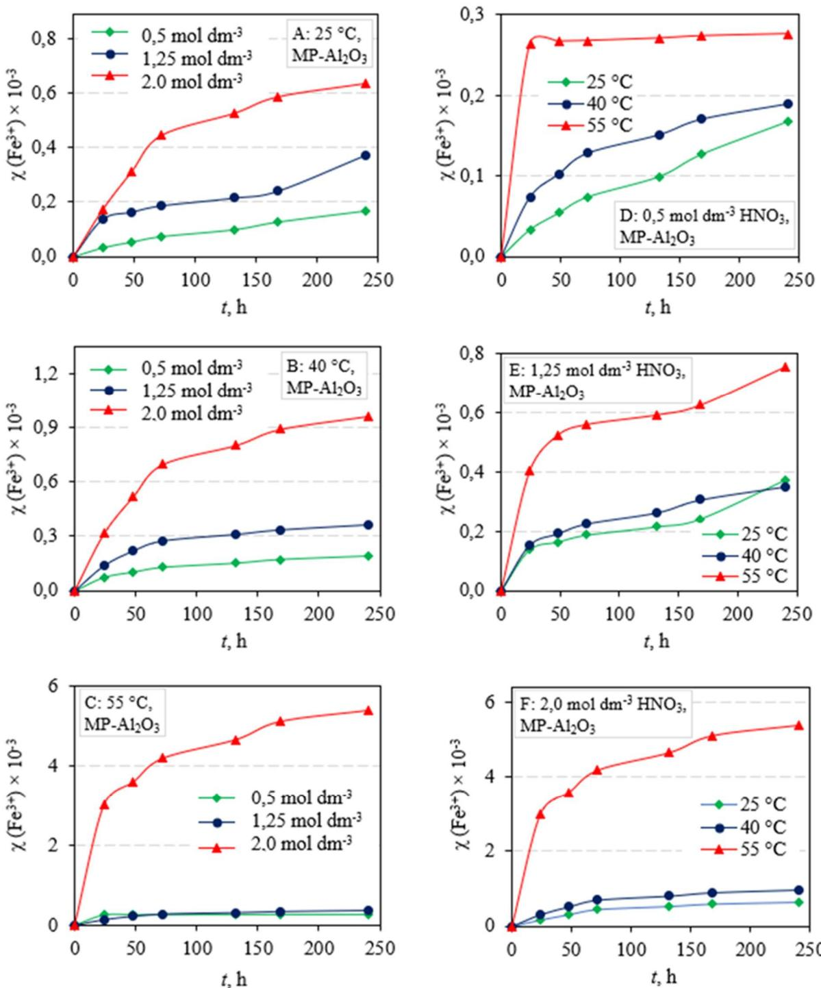
**Slika 7.29** Stupanj otapanja ( $\chi$ )  $\text{Fe}^{3+}$  iz  $\text{Al}_2\text{O}_3$  keramike sinterirane u hibridnoj mikrovalnoj peći ( $\text{MP-Al}_2\text{O}_3$ ) ovisno o vremenu izloženosti, pri različitim temperaturama: (A)  $25^\circ\text{C}$ , (B)  $40^\circ\text{C}$ , (C)  $55^\circ\text{C}$  i koncentracijama  $\text{HNO}_3$ : (D)  $0,5 \text{ mol dm}^{-3}$ , (E)  $1,25 \text{ mol dm}^{-3}$ , (F)  $2 \text{ mol dm}^{-3}$
