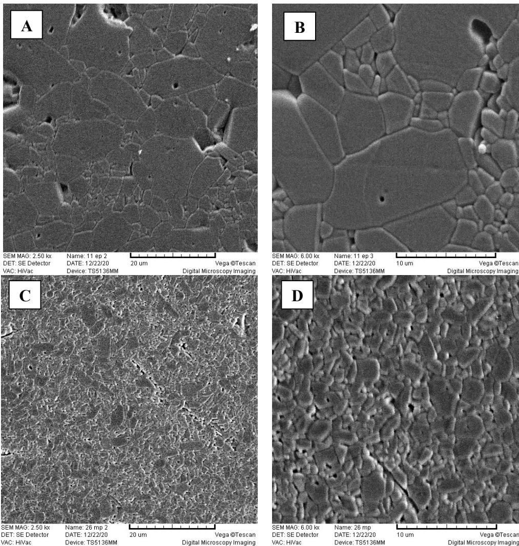
**Slika 7.8** SEM snimke mikrostrukture uzoraka  $\text{Al}_2\text{O}_3$  keramike sinterirane u električnoj peći s povećanjem (A)  $2500 \times$  i (B)  $6000 \times$  te u hibridnoj mikrovalnoj peći s povećanjem (A)  $2500 \times$  i (B)  $6000 \times$  nakon toplinskog nagrizanja
