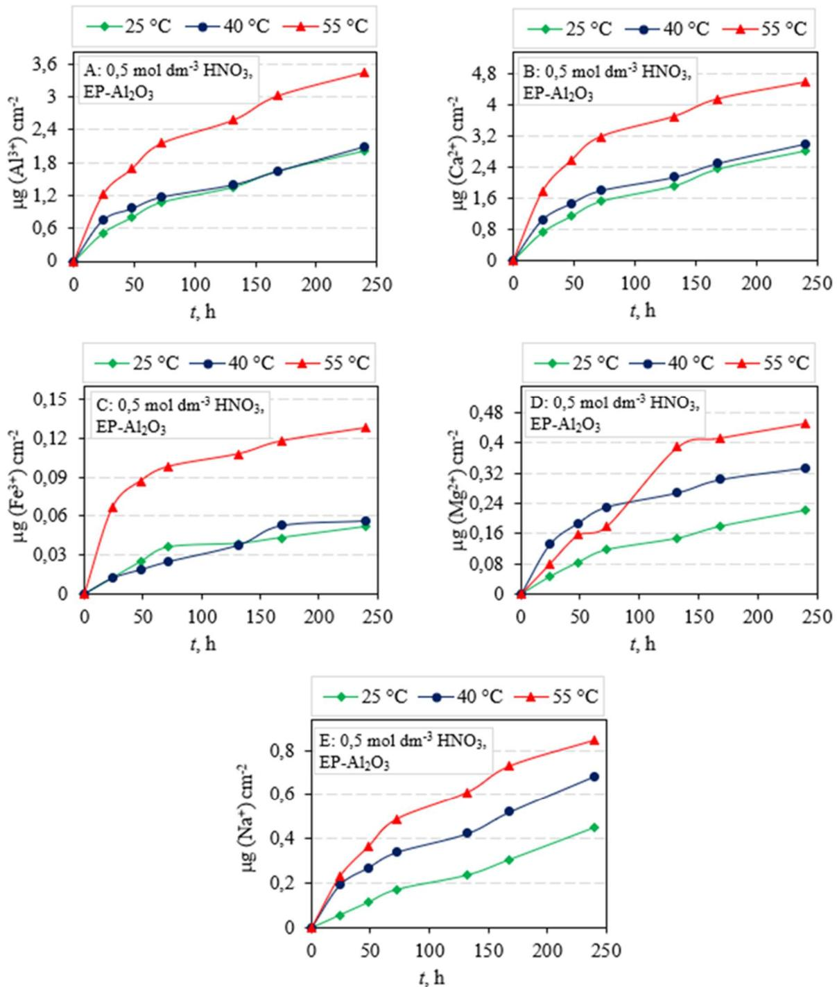
**Slika 7.19** Ovisnost količine (A)  $\text{Al}^{3+}$ , (B)  $\text{Ca}^{2+}$ , (C)  $\text{Fe}^{3+}$ , (D)  $\text{Mg}^{2+}$  i (E)  $\text{Na}^{+}$  eluiranih iona iz  $\text{Al}_2\text{O}_3$  keramike sinterirane u električnoj peći (EP- $\text{Al}_2\text{O}_3$ ) o vremenu izloženosti u  $0,5 \text{ mol dm}^{-3}$   $\text{HNO}_3$  pri temperaturama 25 °C, 40 °C, 55 °C
