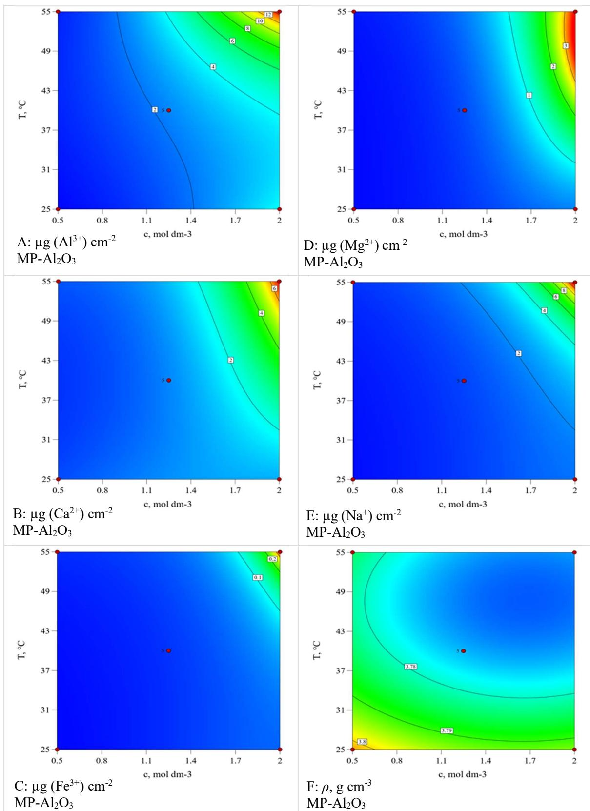
**Slika 7.45** Konturni dijagrami količina eluiranih iona (A)  $\text{Al}^{3+}$ , (B)  $\text{Ca}^{2+}$ , (C)  $\text{Fe}^{3+}$ , (D)  $\text{Mg}^{2+}$  i (E)  $\text{Na}^{+}$  iz  $\text{Al}_2\text{O}_3$  keramike te (F) gustoće  $\text{Al}_2\text{O}_3$  keramike sinterirane u hibridnoj mikrovalnoj peći (MP- $\text{Al}_2\text{O}_3$ ) nakon izlaganja u  $\text{HNO}_3$  u ovisnosti o koncentraciji i temperaturi pri konstantnom vremenu 132 h
