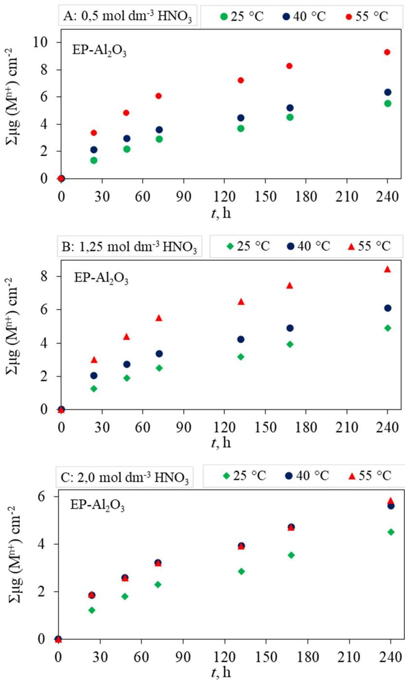
**Slika 7.34** Ovisnost ukupne količine eluiranih iona iz  $\text{Al}_2\text{O}_3$  keramike o vremenu izloženosti pri temperaturama od  $25^\circ\text{C}$ ,  $40^\circ\text{C}$  i  $55^\circ\text{C}$  u otopini  $\text{HNO}_3$  koncentracije (A)  $0,5 \text{ mol dm}^{-3}$ , (B)  $1,25 \text{ mol dm}^{-3}$ , (C)  $2 \text{ mol dm}^{-3}$  za uzorke sinterirane u električnoj peći (EP- $\text{Al}_2\text{O}_3$ )
