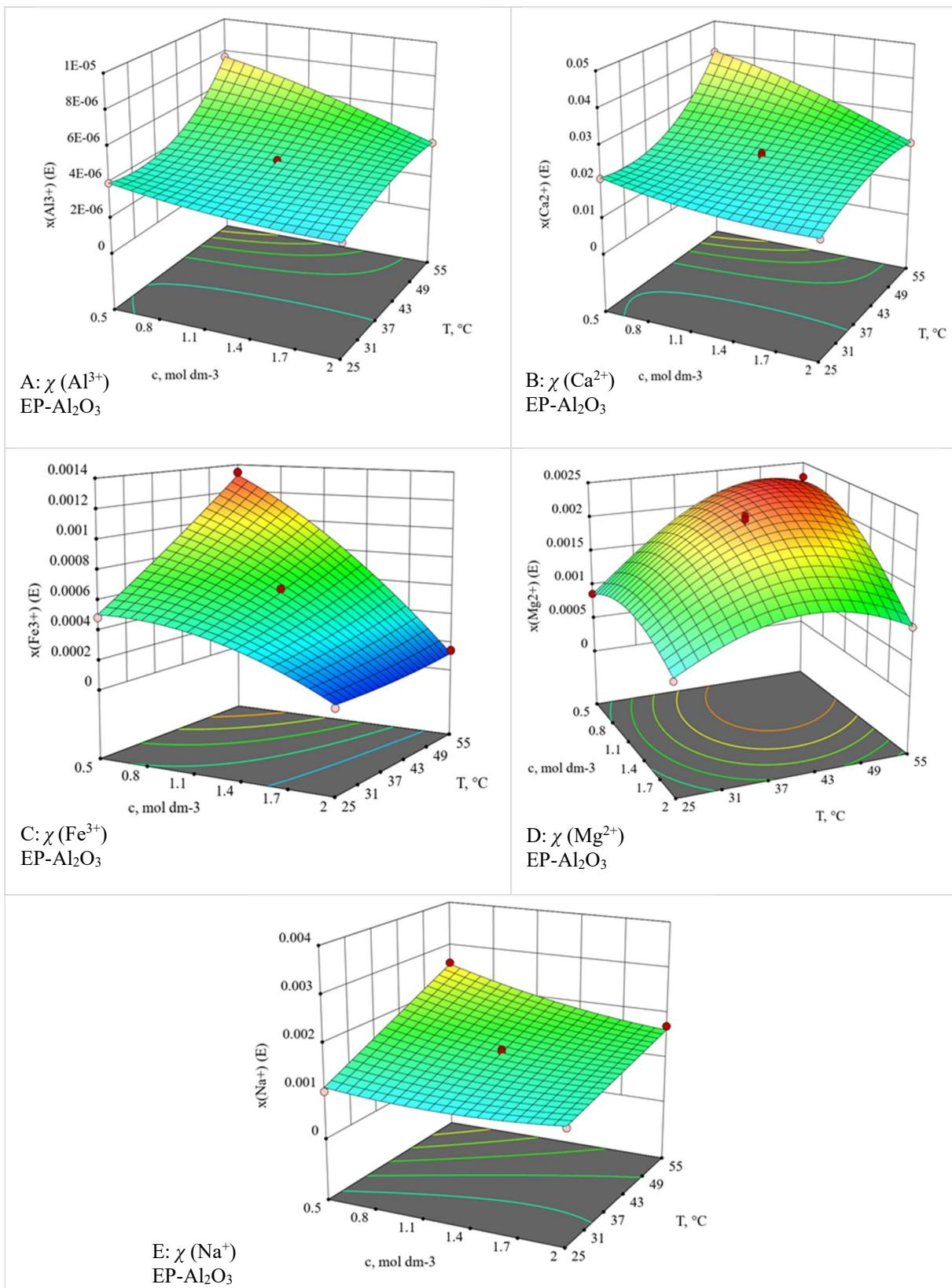
**Slika 7.48** 3D dijagrami stupnjeva otapanja (A) Al<sup>3+</sup>, (B) Ca<sup>2+</sup>, (C) Fe<sup>3+</sup>, (D) Mg<sup>2+</sup> i (E) Na<sup>+</sup> iona iz Al<sub>2</sub>O<sub>3</sub> keramike sinterirane u električnoj peći (EP-Al<sub>2</sub>O<sub>3</sub>) u ovisnosti o koncentraciji HNO<sub>3</sub> i temperaturi pri konstantnom vremenu 132 h
