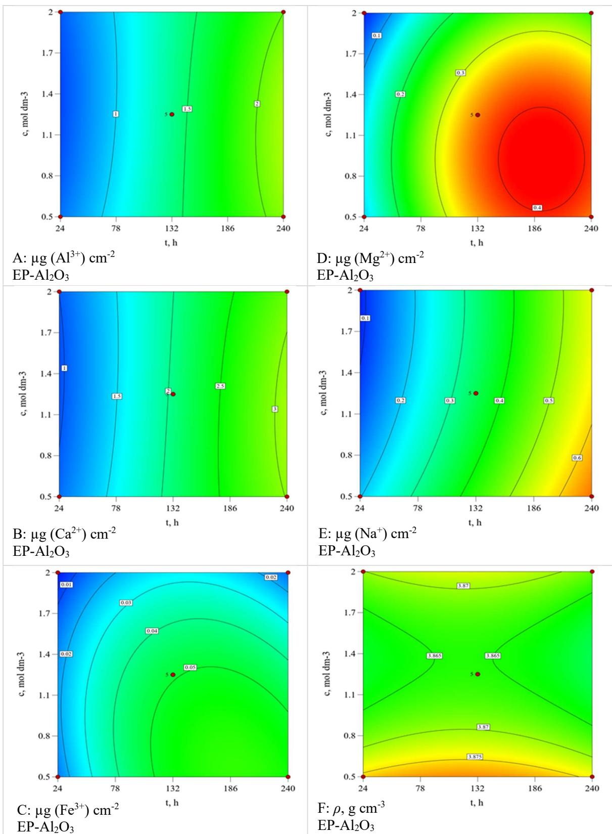
**Slika 7.44** Konturni dijagrami količina eluiranih iona (A) Al<sup>3+</sup>, (B) Ca<sup>2+</sup>, (C) Fe<sup>3+</sup>, (D) Mg<sup>2+</sup> i (E) Na<sup>+</sup> iz Al<sub>2</sub>O<sub>3</sub> keramike te (F) gustoće Al<sub>2</sub>O<sub>3</sub> keramike sinterirane u električnoj peći (EP-Al<sub>2</sub>O<sub>3</sub>) nakon izlaganja u HNO<sub>3</sub> u ovisnosti o vremenu i koncentraciji HNO<sub>3</sub> pri konstantnoj temperaturi 40 °C
