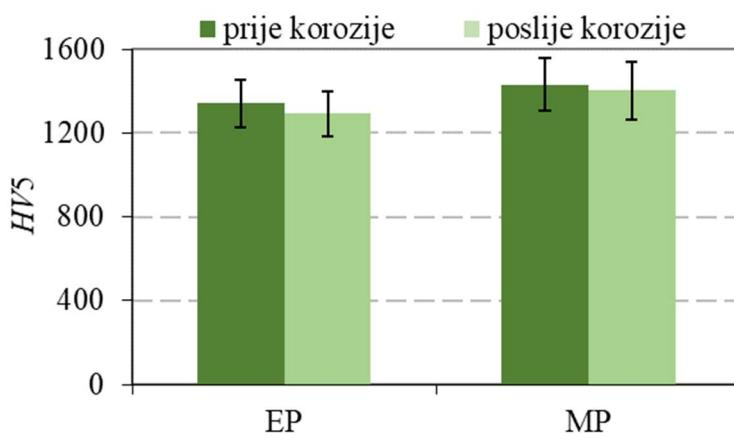
**Slika 7.59** Usporedba vrijednosti tvrdoće ( $HV5$ )  $\text{Al}_2\text{O}_3$  keramike sinterirane u električnoj (EP) i hibridnoj mikrovalnoj peći (MP) prije i poslije ispitivanja korozijske otpornosti u  $2\text{ mol dm}^{-3}$   $\text{HNO}_3$  pri  $55\text{ }^{\circ}\text{C}$  (srednje vrijednosti i standardno odstupanje)
