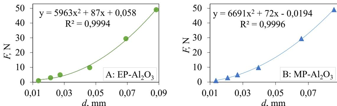
**Slika 7.13** Parametri Vickersove tvrdoće analizirani prema modificiranom modelu otpornosti razmjernom svojstvima uzorka (MPSR) za  $\text{Al}_2\text{O}_3$  keramiku sinteriranu u (A) električnoj (EP- $\text{Al}_2\text{O}_3$ ) i (B) hibridnoj mikrovalnoj peći (MP- $\text{Al}_2\text{O}_3$ )
