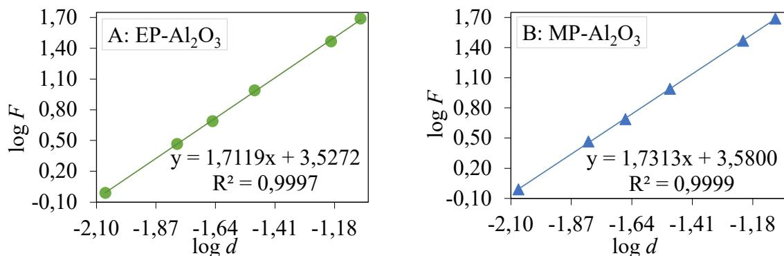
**Slika 7.11** Parametri Vickersove tvrdoće analizirani Meyerovim zakonom za Al<sub>2</sub>O<sub>3</sub> keramiku sinteriranu u (A) električnoj (EP-Al<sub>2</sub>O<sub>3</sub>) i (B) hibridnoj mikrovalnoj peći (MP-Al<sub>2</sub>O<sub>3</sub>)
