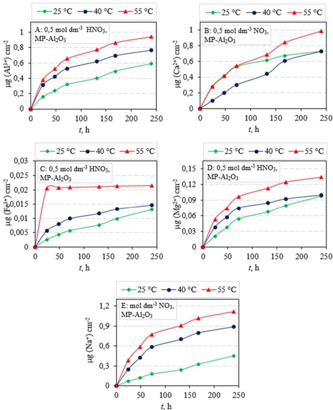
**Slika 7.20** Ovisnost količine (A)  $\text{Al}^{3+}$ , (B)  $\text{Ca}^{2+}$ , (C)  $\text{Fe}^{3+}$ , (D)  $\text{Mg}^{2+}$  i (E)  $\text{Na}^{+}$  eluiranih iona iz  $\text{Al}_2\text{O}_3$  keramike sinterirane u hibridnoj mikrovalnoj peći (MP- $\text{Al}_2\text{O}_3$ ) o vremenu izloženosti u  $0,5 \text{ mol dm}^{-3} \text{ HNO}_3$  pri temperaturama 25 °C, 40 °C, 55 °C
