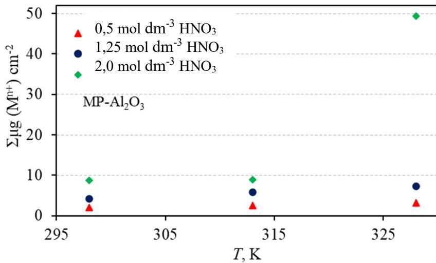
**Slika 7.40** Ukupna količina eluiranih iona ovisno o temperaturi u različitim koncentracijama  $\text{HNO}_3$  iz  $\text{Al}_2\text{O}_3$  keramike sinterirane u hibridnoj mikrovalnoj peći (MP- $\text{Al}_2\text{O}_3$ )
