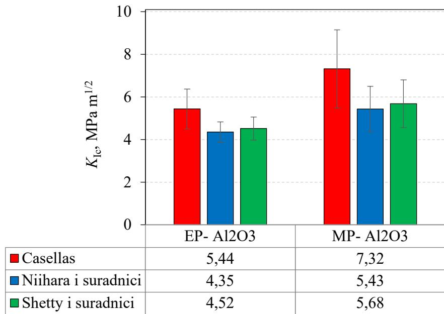
**Slika 7.15.** Usporedba vrijednosti lomne žilavosti ( $K_{Ic}$ , MPa  $m^{1/2}$ ) za Al<sub>2</sub>O<sub>3</sub> keramiku sinteriranu u električnoj peći (EP-Al<sub>2</sub>O<sub>3</sub>) i hibridnoj mikrovalnoj peći (MP-Al<sub>2</sub>O<sub>3</sub>) prema različitim modelima za Palmqvist pukotine
