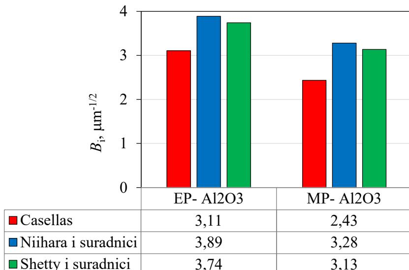
**Slika 7.16** Usporedba vrijednosti indeksa krhkosti ( $B_i$ ,  $\mu\text{m}^{-1/2}$ ) za  $\text{Al}_2\text{O}_3$  keramiku sinteriranu u električnoj peći (EP- $\text{Al}_2\text{O}_3$ ) i hibridnoj mikrovalnoj peći (MP- $\text{Al}_2\text{O}_3$ ) prema različitim modelima za Palmqvist pukotine
