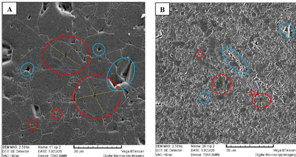
**Slika 7.9** Prikaz nejednolike veličine zrna, pora i granica zrna (A) EP-Al<sub>2</sub>O<sub>3</sub> i (B) MP-Al<sub>2</sub>O<sub>3</sub> keramike (crvenom bojom su označena zrna, a plavom bojom pore)
