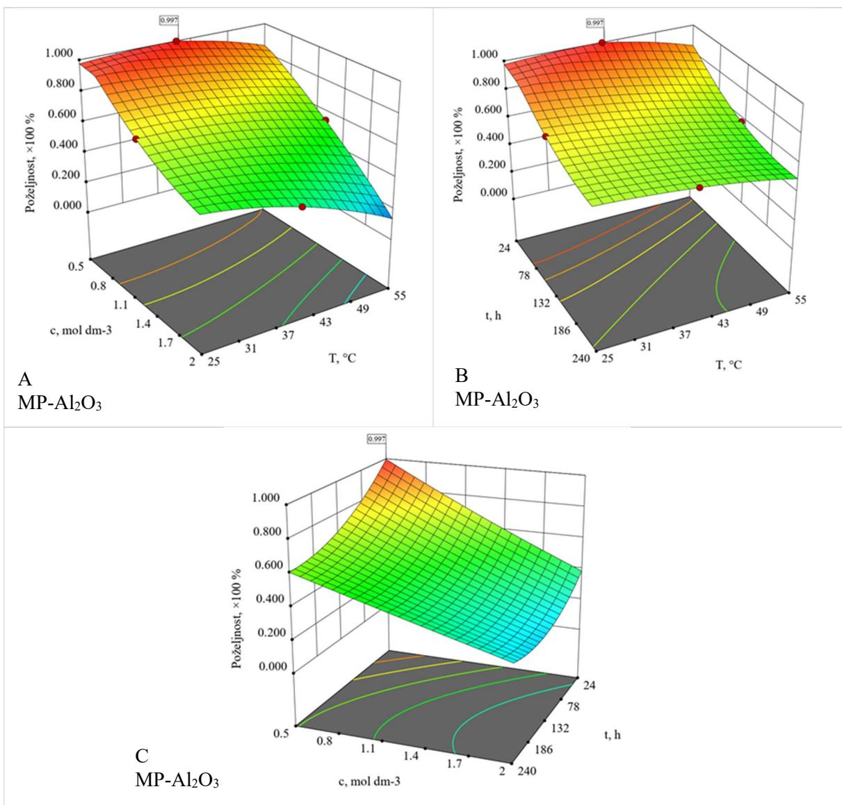
**Slika 7.57** Funkcija poželjnosti stupnjeva otapanja iona Al<sub>2</sub>O<sub>3</sub> keramike sinterirane u hibridnoj mikrovalnoj peći (MP-Al<sub>2</sub>O<sub>3</sub>) u ovisnosti o (A) koncentraciji HNO<sub>3</sub> i temperaturi pri konstantnom vremenu 24 h, (B) temperaturi i vremenu pri konstantnoj koncentraciji HNO<sub>3</sub> 0,5 mol dm<sup>-3</sup>, (C) koncentraciji HNO<sub>3</sub> i vremenu pri konstantnoj temperaturi 40 °C
