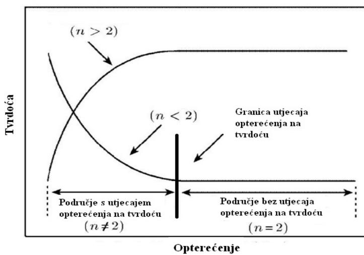
**Slika 6.5** Shematski prikaz utjecaja opterećenja na tvrdoću [123, 140]
