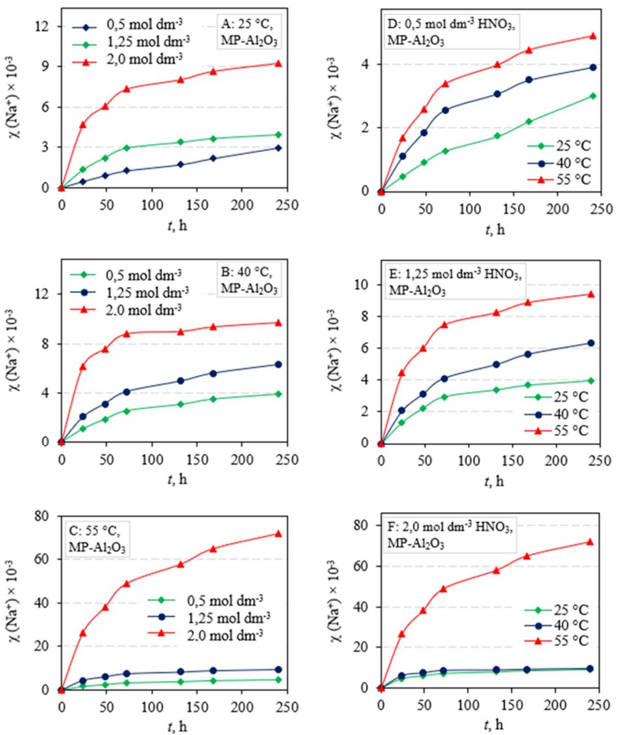
**Slika 7.33** Stupanj otapanja ( $\chi$ )  $\text{Na}^+$  iz  $\text{Al}_2\text{O}_3$  keramike sinterirane u hibridnoj mikrovalnoj peći (MP- $\text{Al}_2\text{O}_3$ ) ovisno o vremenu izloženosti, pri različitim temperaturama: (A)  $25^\circ\text{C}$ , (B)  $40^\circ\text{C}$ , (C)  $55^\circ\text{C}$  i koncentracijama  $\text{HNO}_3$ : (D)  $0.5 \text{ mol dm}^{-3}$ , (E)  $1.25 \text{ mol dm}^{-3}$ , (F)  $2 \text{ mol dm}^{-3}$
