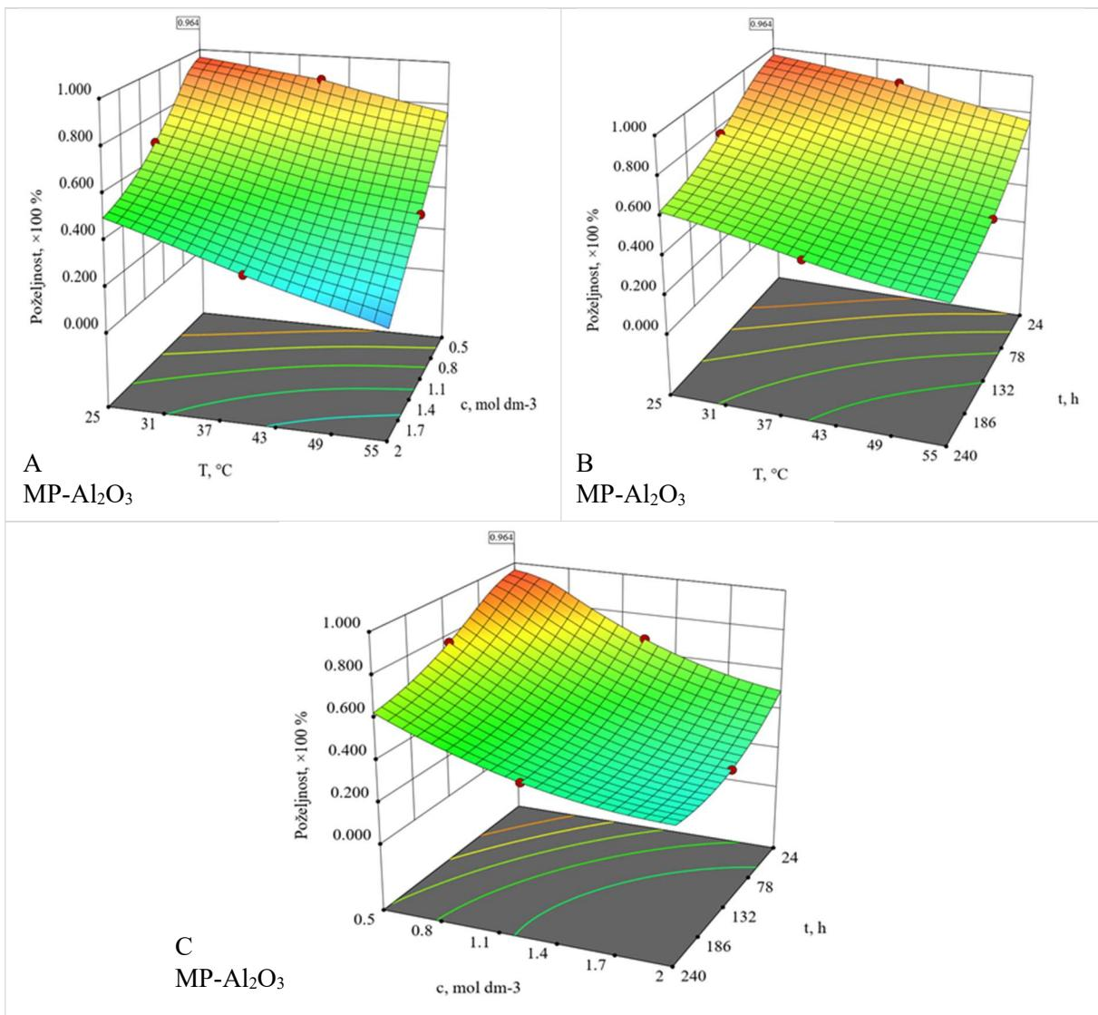
**Slika 7.55** Funkcija poželjnosti količina iona i gustoće Al<sub>2</sub>O<sub>3</sub> keramike sinterirane u hibridnoj mikrovalnoj peći (MP-Al<sub>2</sub>O<sub>3</sub>) u ovisnosti o (A) koncentraciji nitratne kiseline (HNO<sub>3</sub>) i temperaturi pri konstantnom vremenu 24 h, (B) temperaturi i vremenu pri konstantnoj koncentraciji HNO<sub>3</sub> 0,5 mol dm<sup>-3</sup>, (C) koncentraciji HNO<sub>3</sub> i vremenu pri konstantnoj temperaturi 25 °C
