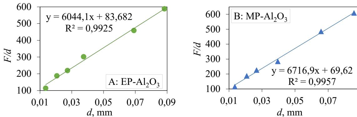
**Slika 7.12** Parametri Vickersove tvrdoće analizirani prema modelu otpornosti razmjernom svojstvima uzorka (PSR) za  $\text{Al}_2\text{O}_3$  keramiku sinteriranu u (A) električnoj (EP- $\text{Al}_2\text{O}_3$ ) i (B) hibridnoj mikrovalnoj peći (MP- $\text{Al}_2\text{O}_3$ )
