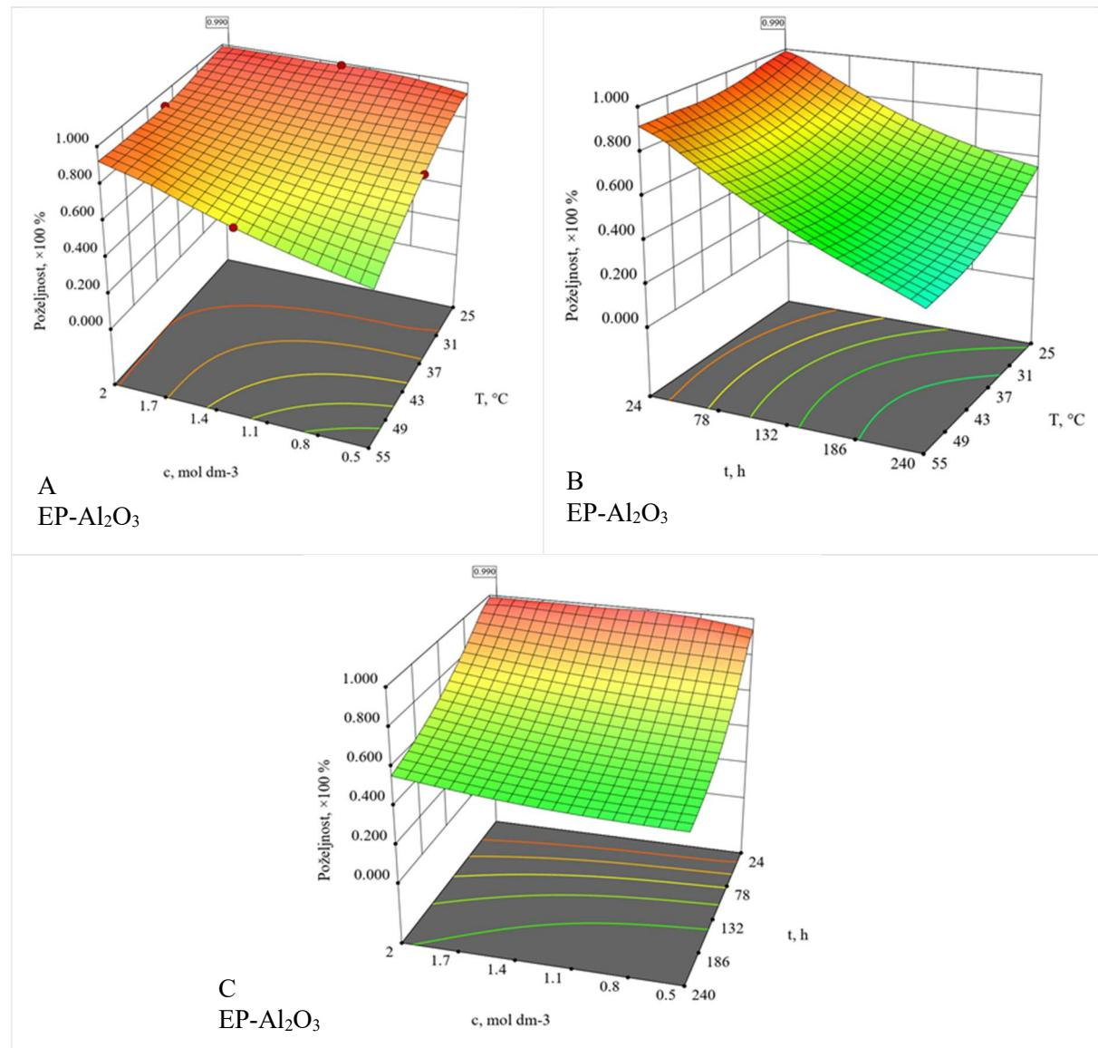
**Slika 7.56** Funkcija poželjnosti stupnjeva otapanja iona  $Al_2O_3$  keramike sinterirane u električnoj peći (EP- $Al_2O_3$ ) u ovisnosti o (A) koncentraciji  $HNO_3$  i temperaturi pri konstantnom vremenu 24 h, (B) temperaturi i vremenu pri konstantnoj koncentraciji  $HNO_3$   $2 \text{ mol dm}^{-3}$ , (C) koncentraciji  $HNO_3$  i vremenu pri konstantnoj temperaturi  $25^\circ C$
