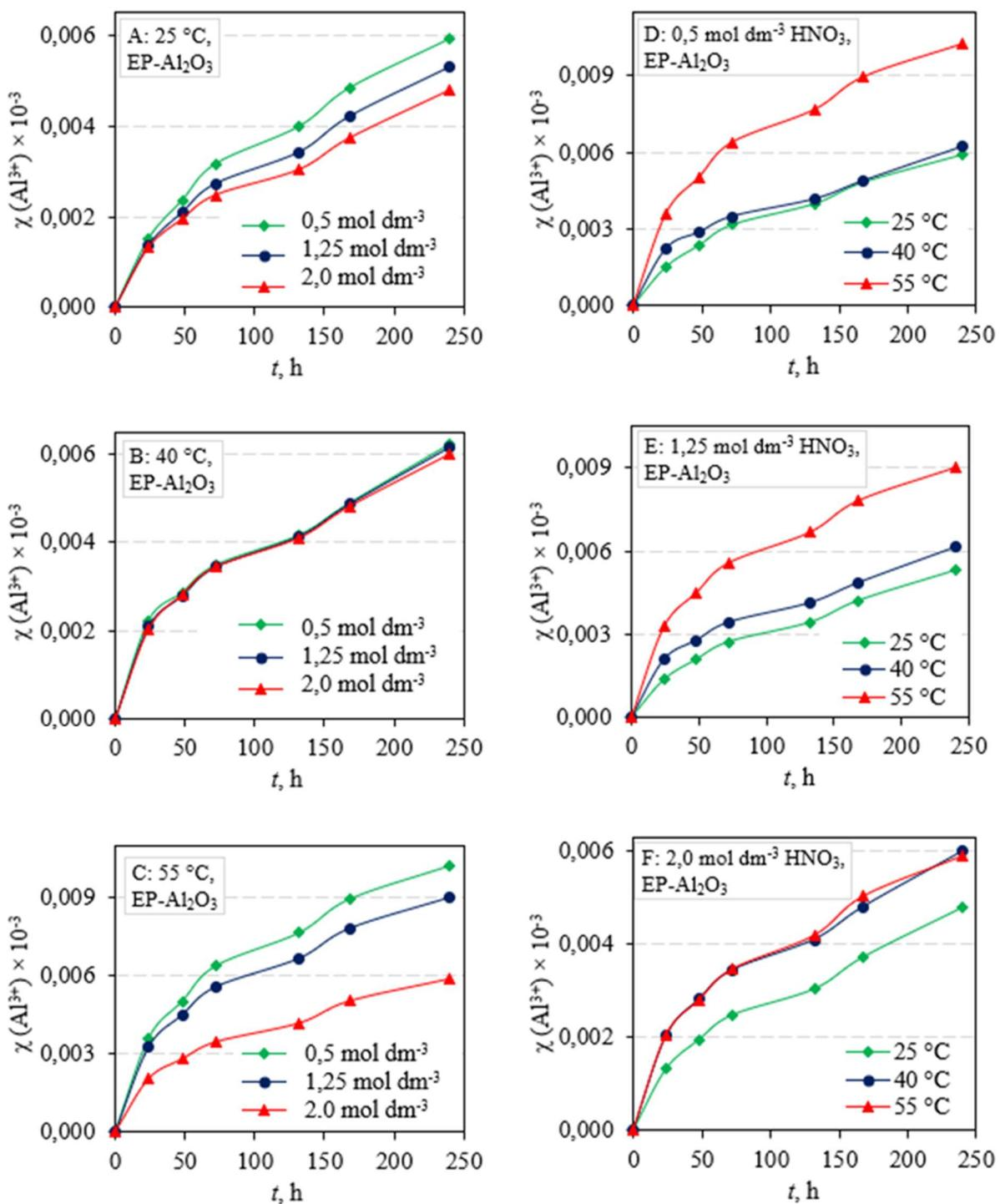
**Slika 7.24** Stupanj otapanja ( $\chi$ )  $\text{Al}^{3+}$  iz  $\text{Al}_2\text{O}_3$  keramike sinterirane u električnoj peći (EP- $\text{Al}_2\text{O}_3$ ) ovisno o vremenu izloženosti, pri različitim temperaturama: (A)  $25^\circ\text{C}$ , (B)  $40^\circ\text{C}$ , (C)  $55^\circ\text{C}$  i koncentracijama  $\text{HNO}_3$ : (D)  $0,5 \text{ mol dm}^{-3}$ , (E)  $1,25 \text{ mol dm}^{-3}$ , (F)  $2 \text{ mol dm}^{-3}$
