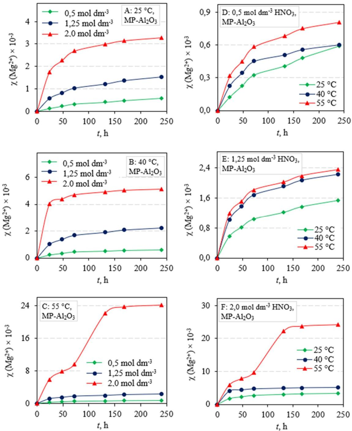
**Slika 7.31** Stupanj otapanja ( $\chi$ )  $\text{Mg}^{2+}$  iz  $\text{Al}_2\text{O}_3$  keramike sinterirane u hibridnoj mikrovalnoj peći (MP- $\text{Al}_2\text{O}_3$ ) ovisno o vremenu izloženosti, pri različitim temperaturama: (A)  $25^\circ\text{C}$ , (B)  $40^\circ\text{C}$ , (C)  $55^\circ\text{C}$  i koncentracijama  $\text{HNO}_3$ : (D)  $0,5 \text{ mol dm}^{-3}$ , (E)  $1,25 \text{ mol dm}^{-3}$ , (F)  $2 \text{ mol dm}^{-3}$
