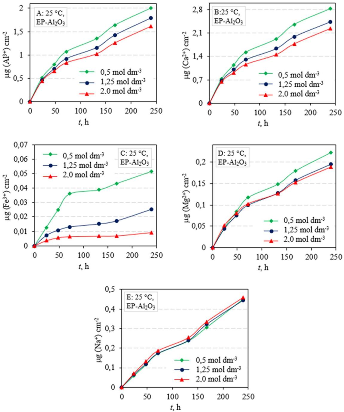
**Slika 7.17** Ovisnost količine (A) Al<sup>3+</sup>, (B) Ca<sup>2+</sup>, (C) Fe<sup>3+</sup>, (D) Mg<sup>2+</sup> i (E) Na<sup>+</sup> eluiranih iona u HNO<sub>3</sub> o vremenu izloženosti Al<sub>2</sub>O<sub>3</sub> keramike sinterirane u električnoj peći (EP-Al<sub>2</sub>O<sub>3</sub>) za koncentracije HNO<sub>3</sub> 0,5 mol dm<sup>-3</sup>, 1,25 mol dm<sup>-3</sup>, 2 mol dm<sup>-3</sup> pri 25 °C
