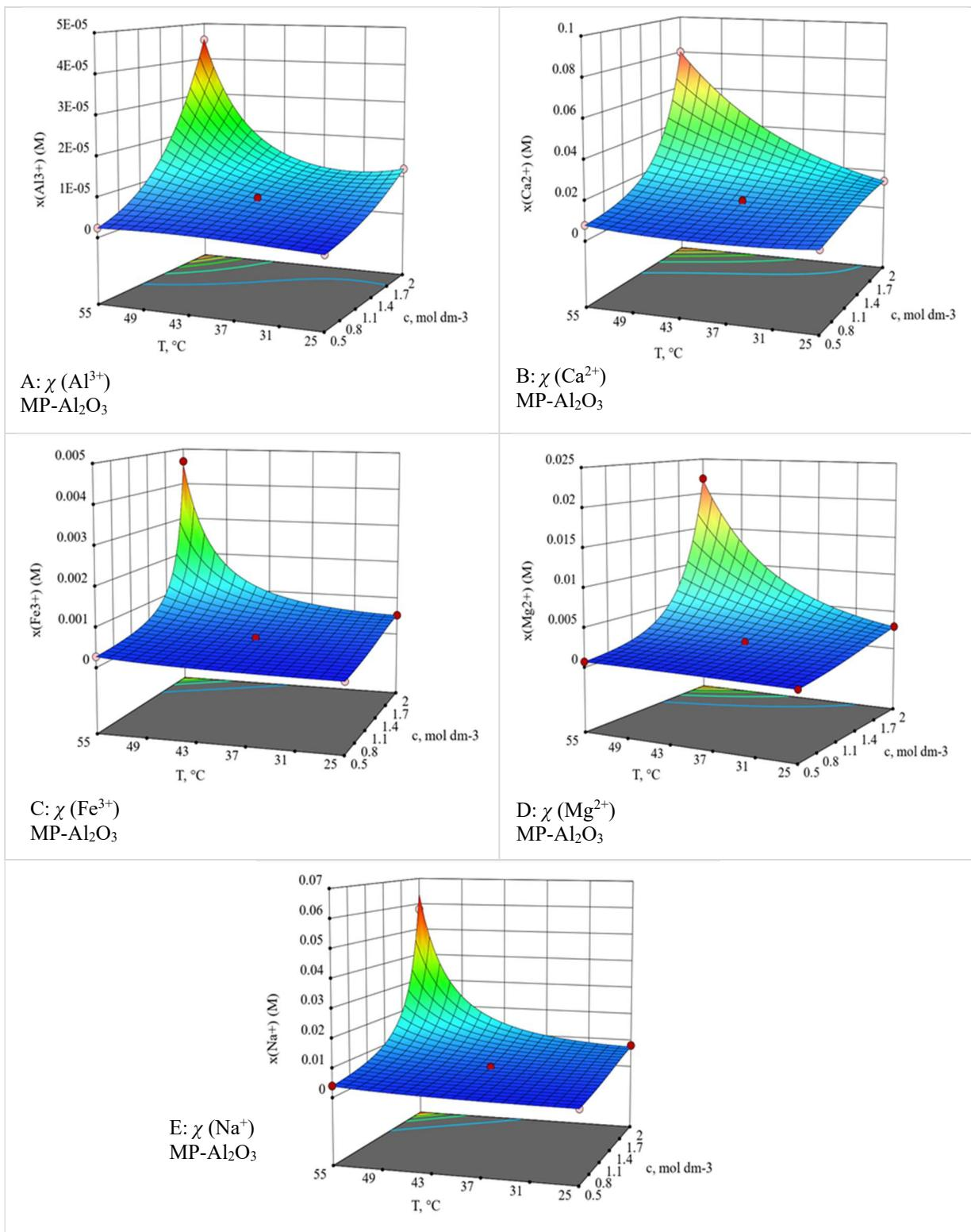
**Slika 7.51** 3D dijagrami stupnjeva otapanja (A) Al<sup>3+</sup>, (B) Ca<sup>2+</sup>, (C) Fe<sup>3+</sup>, (D) Mg<sup>2+</sup> i (E) Na<sup>+</sup> iona iz Al<sub>2</sub>O<sub>3</sub> keramike sinterirane u hibridnoj mikrovalnoj peći (MP-Al<sub>2</sub>O<sub>3</sub>) u ovisnosti o koncentraciji HNO<sub>3</sub> i temperaturi pri konstantnom vremenu 132 h
