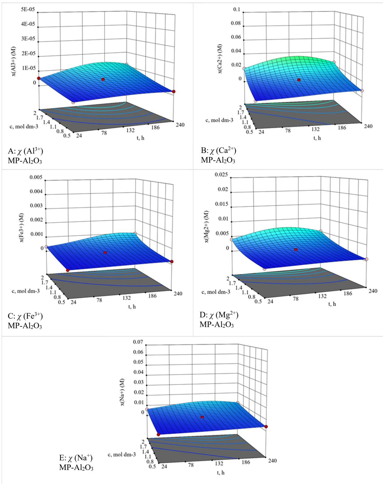
**Slika 7.53** 3D dijagrami stupnjeva otapanja (A) Al<sup>3+</sup>, (B) Ca<sup>2+</sup>, (C) Fe<sup>3+</sup>, (D) Mg<sup>2+</sup> i (E) Na<sup>+</sup> iona iz Al<sub>2</sub>O<sub>3</sub> keramike sinterirane u hibridnoj mikrovalnoj peći (MP-Al<sub>2</sub>O<sub>3</sub>) u ovisnosti o vremenu i koncentraciji HNO<sub>3</sub> pri konstantnoj temperaturi 40 °C
