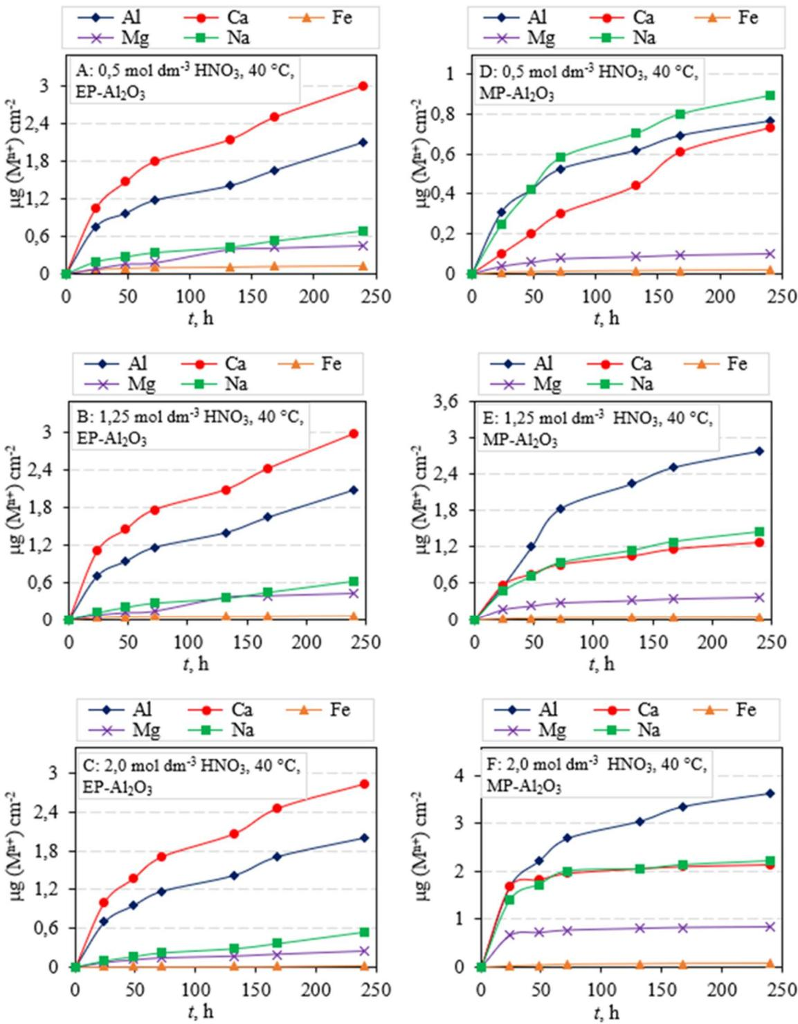
**Slika 7.22** Usporedba količina eluiranih iona iz  $\text{Al}_2\text{O}_3$  keramike pri temperaturi od 40 °C u otopini  $\text{HNO}_3$  koncentracije (A) 0,5 mol  $\text{dm}^{-3}$ , (B) 1,25 mol  $\text{dm}^{-3}$  i (C) 2 mol  $\text{dm}^{-3}$  za uzorke sinterirane u električnoj peći (EP- $\text{Al}_2\text{O}_3$ ) te (D) 0,5 mol  $\text{dm}^{-3}$ , (E) 1,25 mol  $\text{dm}^{-3}$  i (F) 2 mol  $\text{dm}^{-3}$  za uzorke sinterirane u hibridnoj mikrovalnoj peći (MP- $\text{Al}_2\text{O}_3$ )
