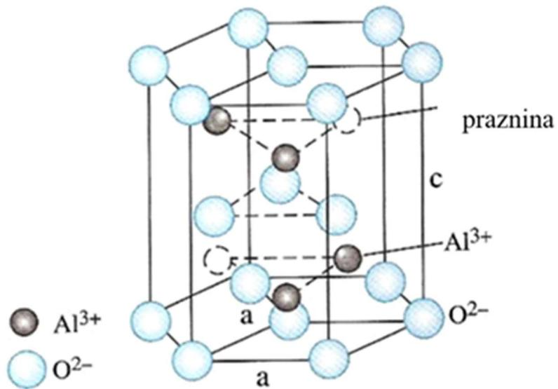
Slika 2.1 Struktura  $\alpha\text{-Al}_2\text{O}_3$  [30]
