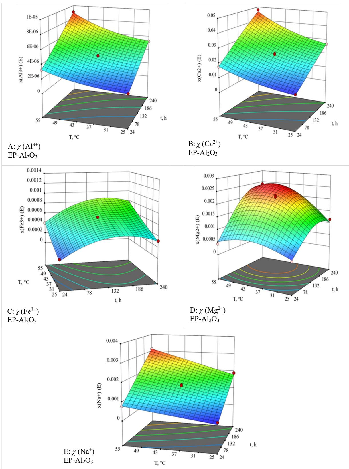
**Slika 7.49** 3D dijagrami stupnjeva otapanja (A) Al<sup>3+</sup>, (B) Ca<sup>2+</sup>, (C) Fe<sup>3+</sup>, (D) Mg<sup>2+</sup> i (E) Na<sup>+</sup> iona iz Al<sub>2</sub>O<sub>3</sub> keramike sinterirane u električnoj peći (EP-Al<sub>2</sub>O<sub>3</sub>) u ovisnosti o vremenu i temperaturi pri konstantnoj koncentraciji HNO<sub>3</sub> 1,25 mol dm<sup>-3</sup>
