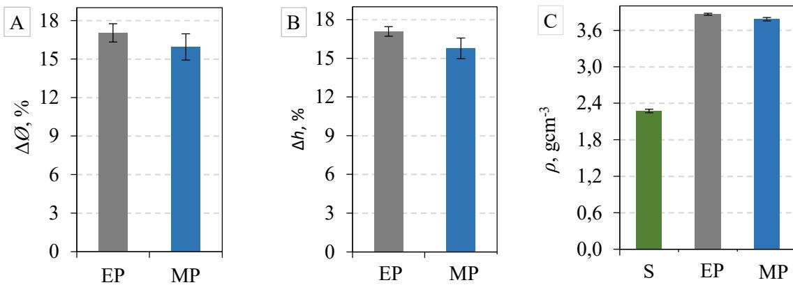
**Slika 7.6** Uzorci aluminijeva oksida sinterirani konvencionalnom (električna peć, EP) i nekonvencionalnom (hibridna mikrovalna peć, MP) metodom: (A) radijalno skupljanje, (B) aksijalno skupljanje, (C) gustoća sirovaca i sinteriranih uzoraka (srednja vrijednost i eksperimentalno standardno odstupanje)
