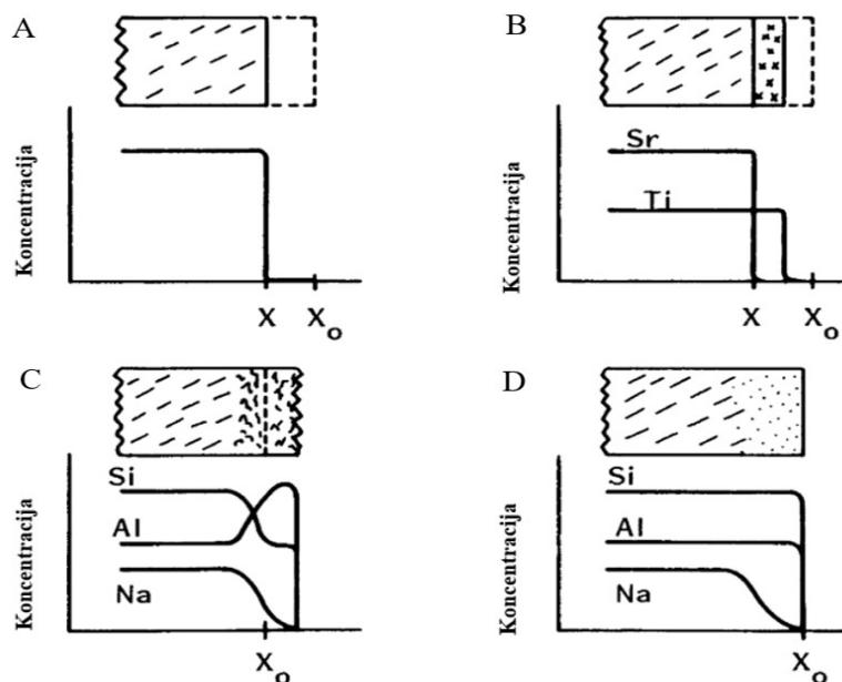
**Slika 4.1** Shematski prikaz mehanizama otapanja keramike: (A) kongruentno otapanje (jednoliko povlačenje površine koja se otapa), (B) inkongruentno otapanje (nastajanje produkata kemijske reakcije na površini materijala), (C) inkongruentno otapanje površine materijala uz kemijsku reakciju između otapala i površine materijala, (D) otapanje natrija iz aluminosilikata reakcijama u kojima dolazi do izmjene iona [94]
