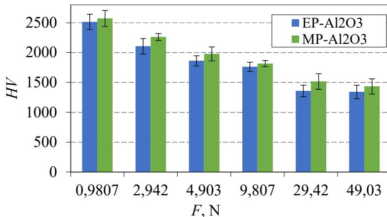
**Slika 7.10** Usporedba vrijednosti Vickersove tvrdoće ( $HV$ ) ovisno o primjenjenom opterećenju ( $F$ , N) za Al<sub>2</sub>O<sub>3</sub> keramiku sinteriranu u električnoj (EP-Al<sub>2</sub>O<sub>3</sub>) i hibridnoj mikrovalnoj peći (MP-Al<sub>2</sub>O<sub>3</sub>) (srednja vrijednost i eksperimentalno standardno odstupanje)
