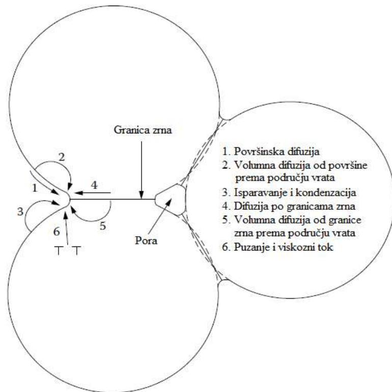
**Slika 3.2** Atomski mehanizmi prijenosa mase u procesu sinteriranja [45]
