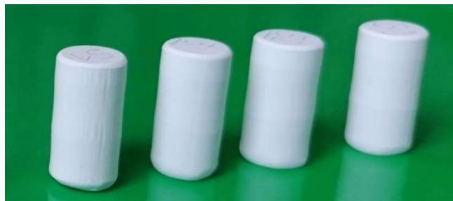
**Slika 6.2** Sirovci  $\text{Al}_2\text{O}_3$  nakon hladnog izostatičkog prešanja
