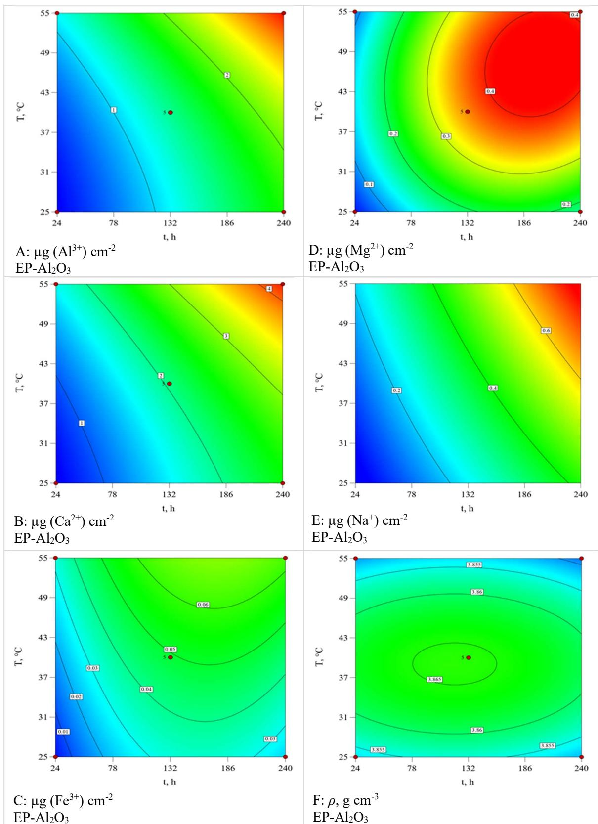
**Slika 7.43** Konturni dijagrami količina eluiranih iona (A)  $\text{Al}^{3+}$ , (B)  $\text{Ca}^{2+}$ , (C)  $\text{Fe}^{3+}$ , (D)  $\text{Mg}^{2+}$  i (E)  $\text{Na}^{+}$  iz  $\text{Al}_2\text{O}_3$  keramike te (F) gustoće  $\text{Al}_2\text{O}_3$  keramike sinterirane u električnoj peći (EP-Al<sub>2</sub>O<sub>3</sub>) nakon izlaganja u  $\text{HNO}_3$  u ovisnosti o vremenu i temperaturi pri konstantnoj koncentraciji  $\text{HNO}_3$  1,25 mol  $\text{dm}^{-3}$
