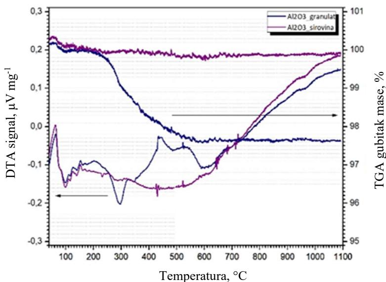
Slika 7.3 DTA/TGA termogram sirovine i granulata aluminijeva oksida
