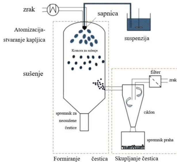
**Slika 2.2** Shematski prikaz dobivanja granulata sušenjem raspršivanjem [43]
