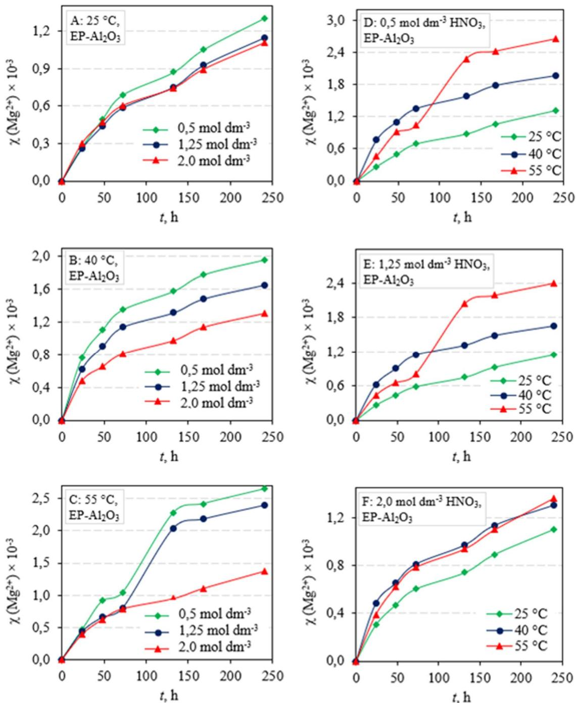
**Slika 7.30** Stupanj otapanja ( $\chi$ )  $\text{Mg}^{2+}$  iz  $\text{Al}_2\text{O}_3$  keramike sinterirane u električnoj peći ( $\text{EP-Al}_2\text{O}_3$ ) ovisno o vremenu izloženosti, pri različitim temperaturama: (A)  $25^\circ\text{C}$ , (B)  $40^\circ\text{C}$ , (C)  $55^\circ\text{C}$  i koncentracijama nitratne kiseline: (D)  $0,5 \text{ mol dm}^{-3}$ , (E)  $1,25 \text{ mol dm}^{-3}$ , (F)  $2 \text{ mol dm}^{-3}$
