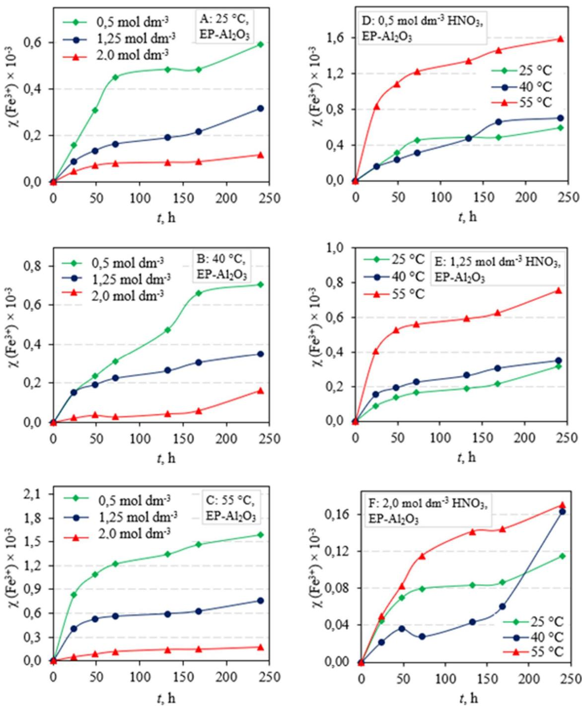
**Slika 7.28** Stupanj otapanja ( $\gamma$ )  $\text{Fe}^{3+}$  iz  $\text{Al}_2\text{O}_3$  keramike sinterirane u električnoj peći ( $\text{EP-Al}_2\text{O}_3$ ) ovisno o vremenu izloženosti, pri različitim temperaturama: (A)  $25^\circ\text{C}$ , (B)  $40^\circ\text{C}$ , (C)  $55^\circ\text{C}$  i koncentracijama  $\text{HNO}_3$ : (D)  $0.5 \text{ mol dm}^{-3}$ , (E)  $1.25 \text{ mol dm}^{-3}$ , (F)  $2 \text{ mol dm}^{-3}$
