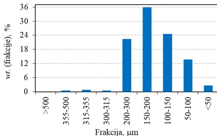
**Slika 7.1** Raspodjela veličine čestica granulata Al<sub>2</sub>O<sub>3</sub> dobivenih sušenjem raspršivanjem
