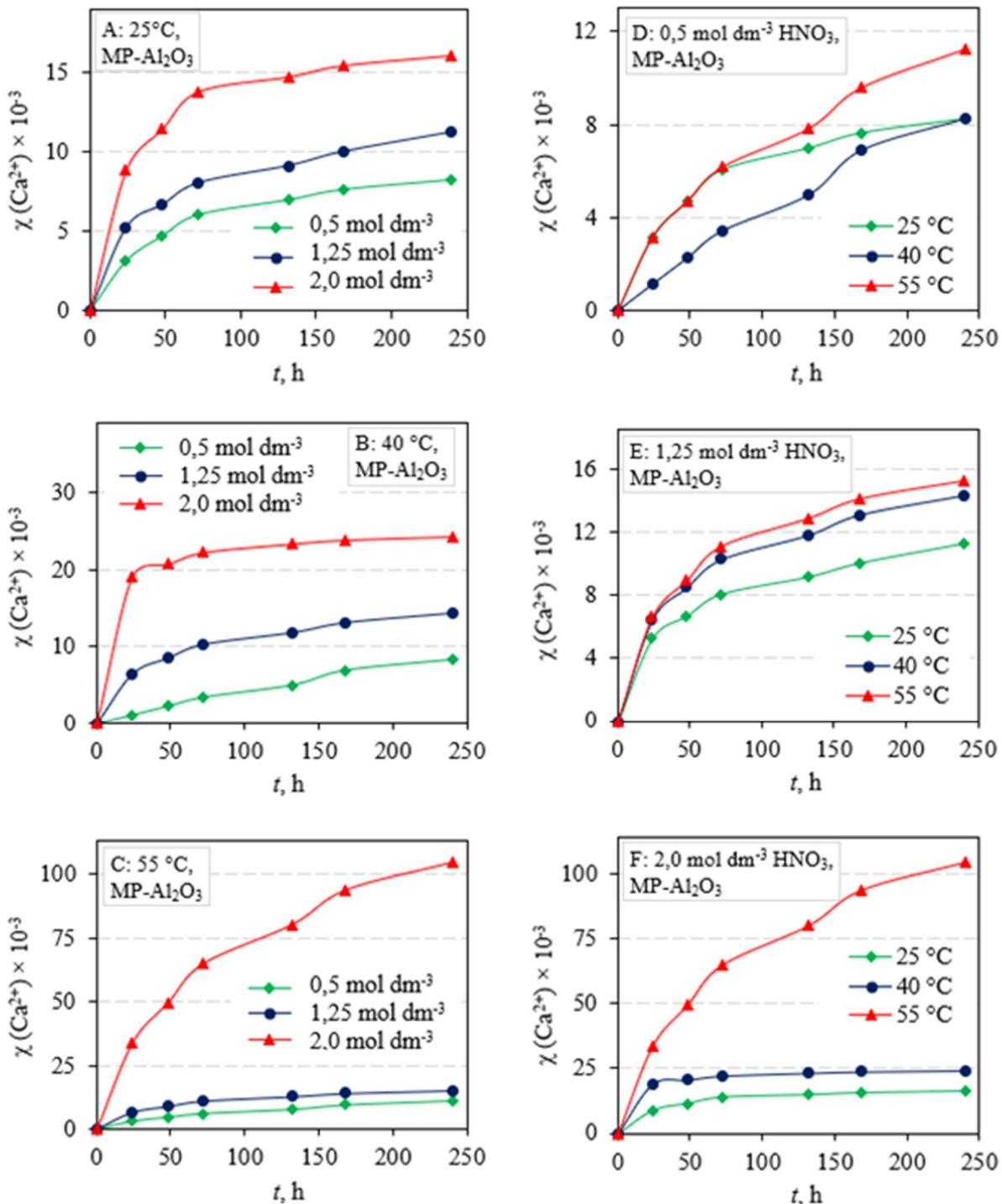
**Slika 7.27** Stupanj otapanja ( $\chi$ )  $\text{Ca}^{2+}$  iz  $\text{Al}_2\text{O}_3$  keramike sinterirane u hibridnoj mikrovalnoj peći (MP-Al<sub>2</sub>O<sub>3</sub>) ovisno o vremenu izloženosti, pri različitim temperaturama: (A) 25 °C, (B) 40 °C, (C) 55 °C i koncentracijama HNO<sub>3</sub>: (D) 0,5 mol dm<sup>-3</sup>, (E) 1,25 mol dm<sup>-3</sup>, (F) 2 mol dm<sup>-3</sup>
