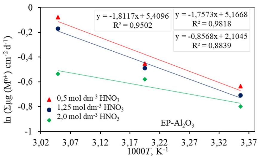
**Slika 7.39** Arrheniusova ovisnost ukupne količine eluiranih iona iz  $\text{Al}_2\text{O}_3$  keramike sinterirane u električnoj peći (EP- $\text{Al}_2\text{O}_3$ ) o recipročnoj vrijednosti temperature u K za tri koncentracije  $\text{HNO}_3$
