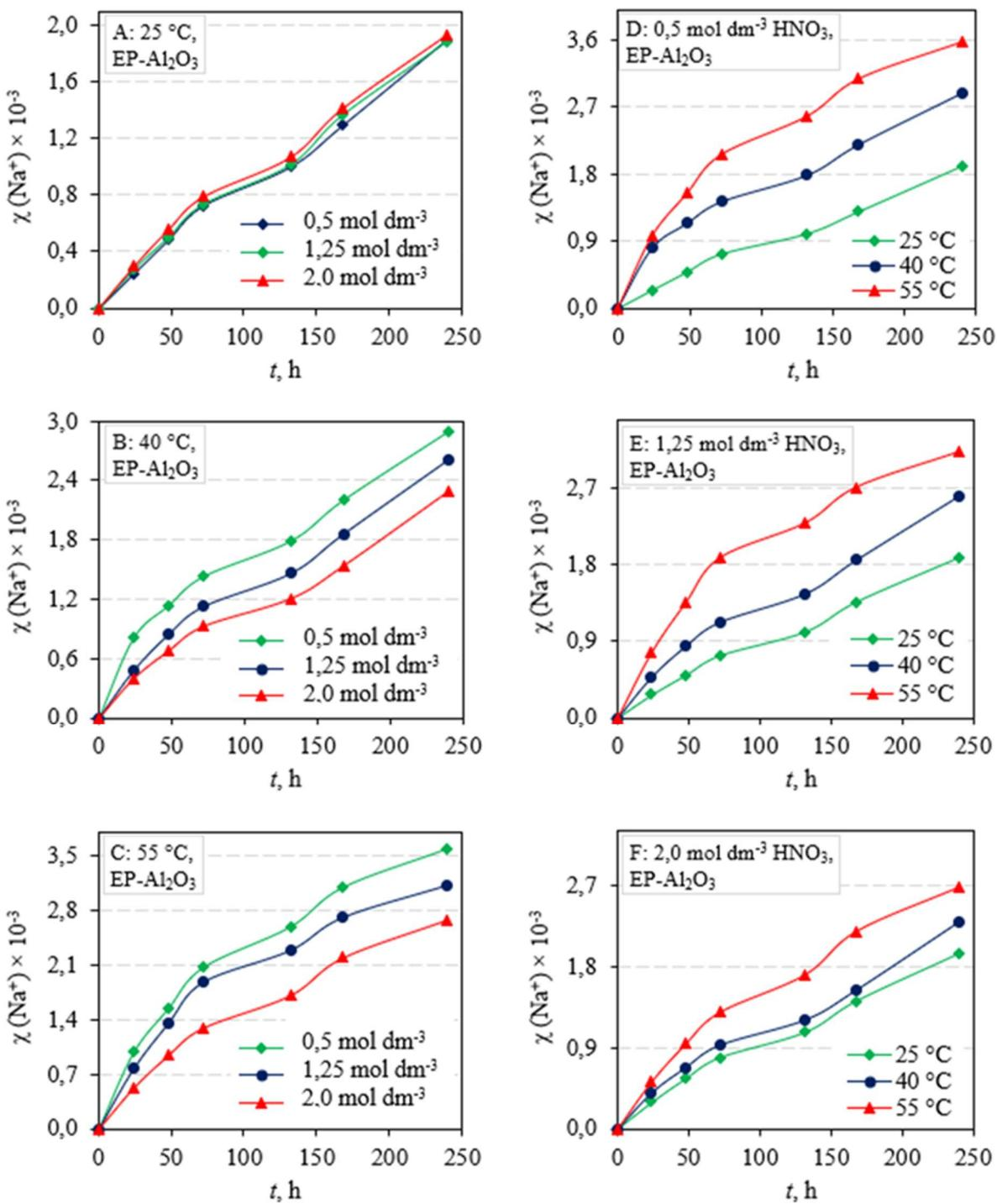
**Slika 7.32** Stupanj otapanja ( $\chi$ )  $\text{Na}^+$  iz  $\text{Al}_2\text{O}_3$  keramike sinterirane u električnoj peći (EP- $\text{Al}_2\text{O}_3$ ) ovisno o vremenu izloženosti, pri različitim temperaturama: (A)  $25^\circ\text{C}$ , (B)  $40^\circ\text{C}$ , (C)  $55^\circ\text{C}$  i koncentracijama  $\text{HNO}_3$ : (D)  $0,5 \text{ mol dm}^{-3}$ , (E)  $1,25 \text{ mol dm}^{-3}$ , (F)  $2 \text{ mol dm}^{-3}$
