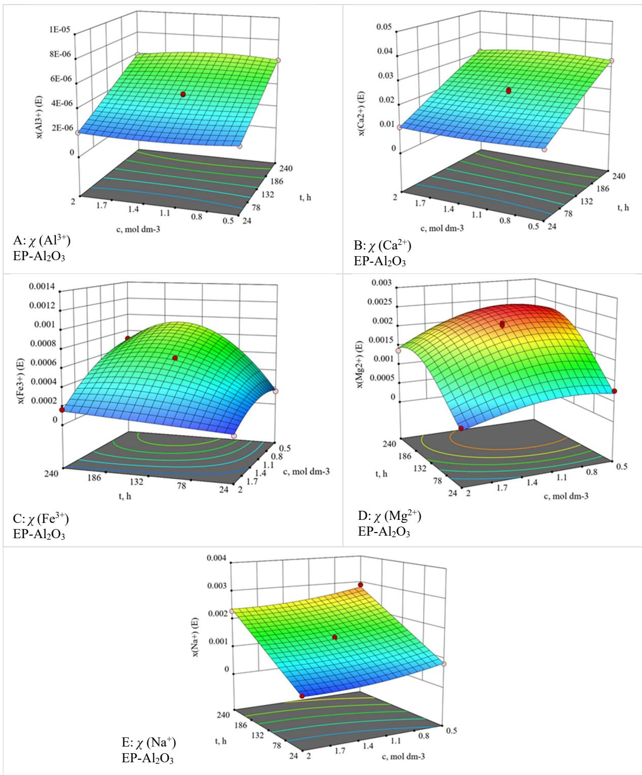
**Slika 7.50** 3D dijagrami stupnjeva otapanja (A) Al<sup>3+</sup>, (B) Ca<sup>2+</sup>, (C) Fe<sup>3+</sup>, (D) Mg<sup>2+</sup> i (E) Na<sup>+</sup> iona iz Al<sub>2</sub>O<sub>3</sub> keramike sinterirane u električnoj peći (EP-Al<sub>2</sub>O<sub>3</sub>) u ovisnosti o vremenu i koncentraciji HNO<sub>3</sub> pri konstantnoj temperaturi 40 °C
