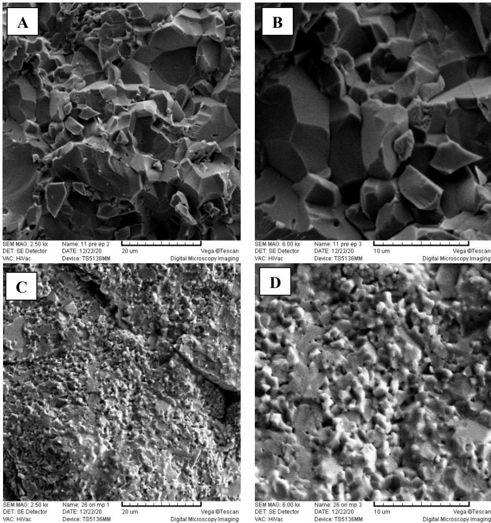
**Slika 7.7** SEM snimke prijelomne površine uzorka  $\text{Al}_2\text{O}_3$  keramike sinteriranih konvencionalnim postupkom u električnoj peći s povećanjem (A)  $2500 \times$  i (B)  $6000 \times$  te nekonvencionalnim postupkom u hibridnoj mikrovalnoj peći s povećanjem (C)  $2500 \times$  i (D)  $6000 \times$
