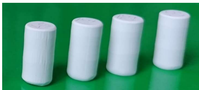
Slika 6.2 Sirovci \text{Al}_2\text{O}_3 nakon hladnog izostatičkog prešanja
