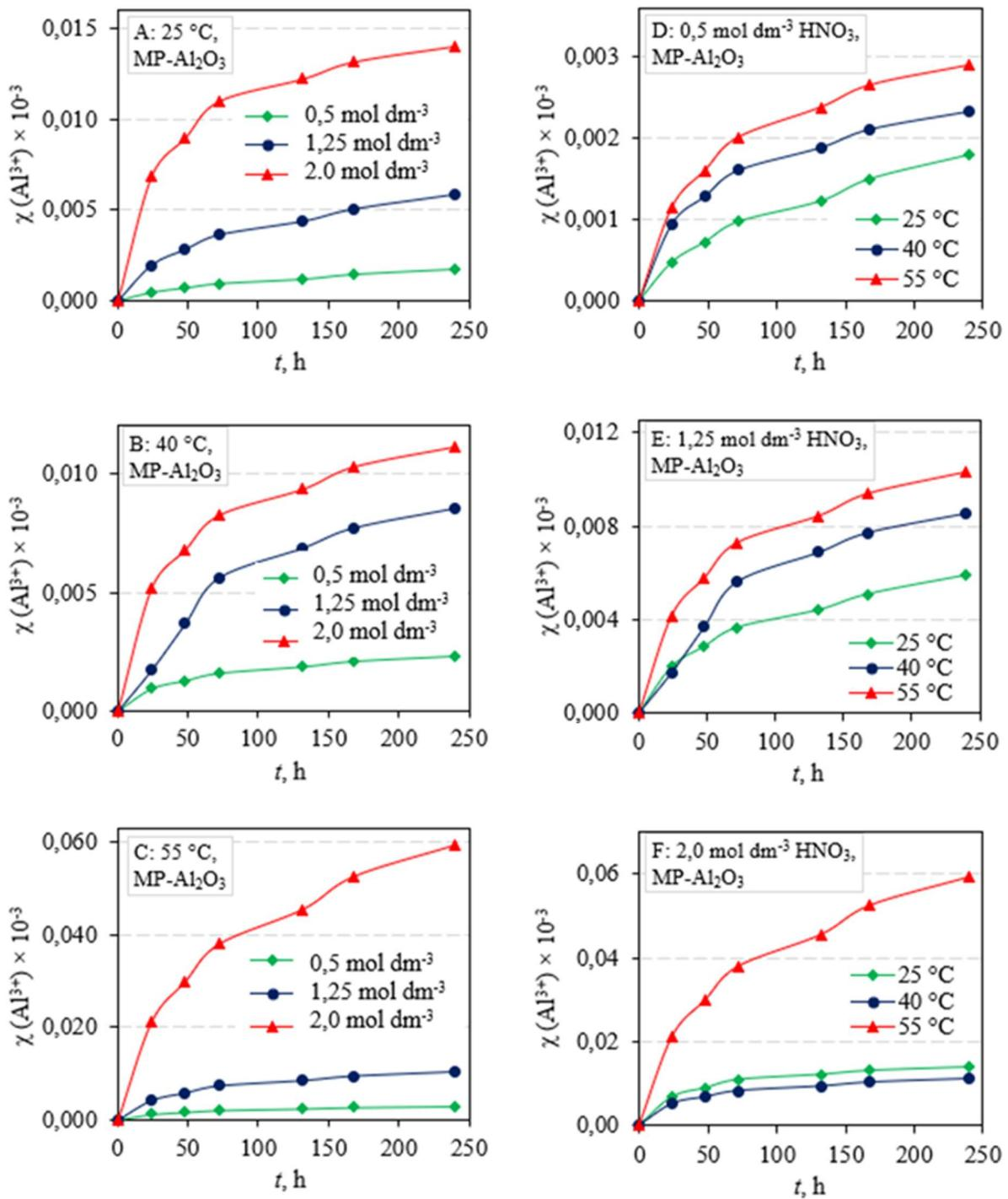
**Slika 7.25** Stupanj otapanja ( $\chi$ ) Al<sup>3+</sup> iz Al<sub>2</sub>O<sub>3</sub> keramike sinterirane u hibridnoj mikrovalnoj peći (MP-Al<sub>2</sub>O<sub>3</sub>) ovisno o vremenu izloženosti, pri različitim temperaturama: (A) 25 °C, (B) 40 °C, (C) 55 °C i koncentracijama HNO<sub>3</sub>: (D) 0,5 mol dm<sup>-3</sup>, (E) 1,25 mol dm<sup>-3</sup>, (F) 2 mol dm<sup>-3</sup>
