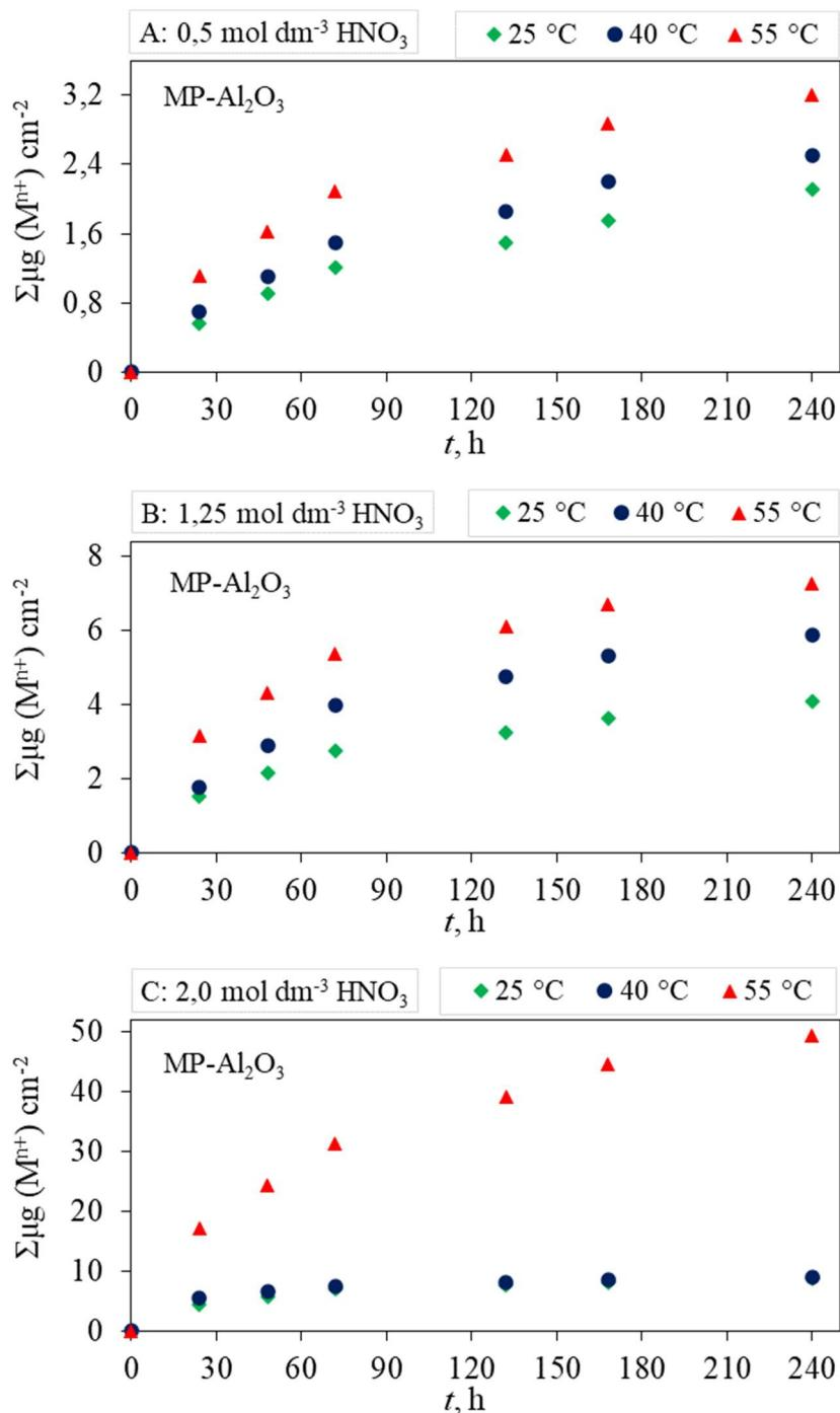
**Slika 7.35** Ovisnost ukupne količine eluiranih iona iz Al<sub>2</sub>O<sub>3</sub> keramike o vremenu izloženosti pri temperaturama od 25 °C, 40 °C i 55 °C u otopini HNO<sub>3</sub> koncentracije (A) 0,5 mol dm<sup>-3</sup>, (B) 1,25 mol dm<sup>-3</sup>, (C) 2 mol dm<sup>-3</sup> za uzorke sinterirane u hibridnoj mikrovalnoj peći (MP-Al<sub>2</sub>O<sub>3</sub>)
