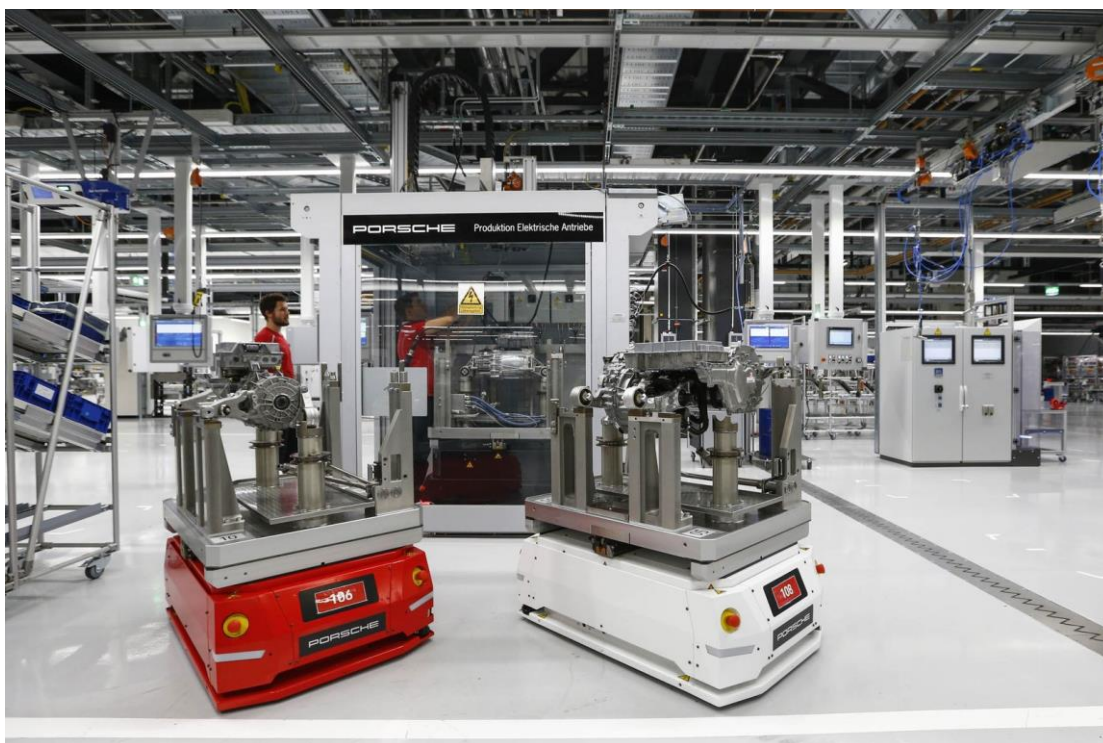
Slika 1 – Proizvodna linija za proizvodnju elektromotora za Porsche Taycan S [1]
