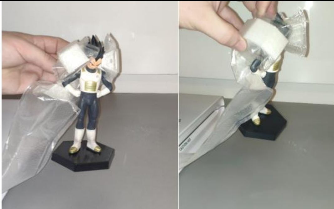
Slika 57 – Hvatanje veće figurice origami prihvatnicom
