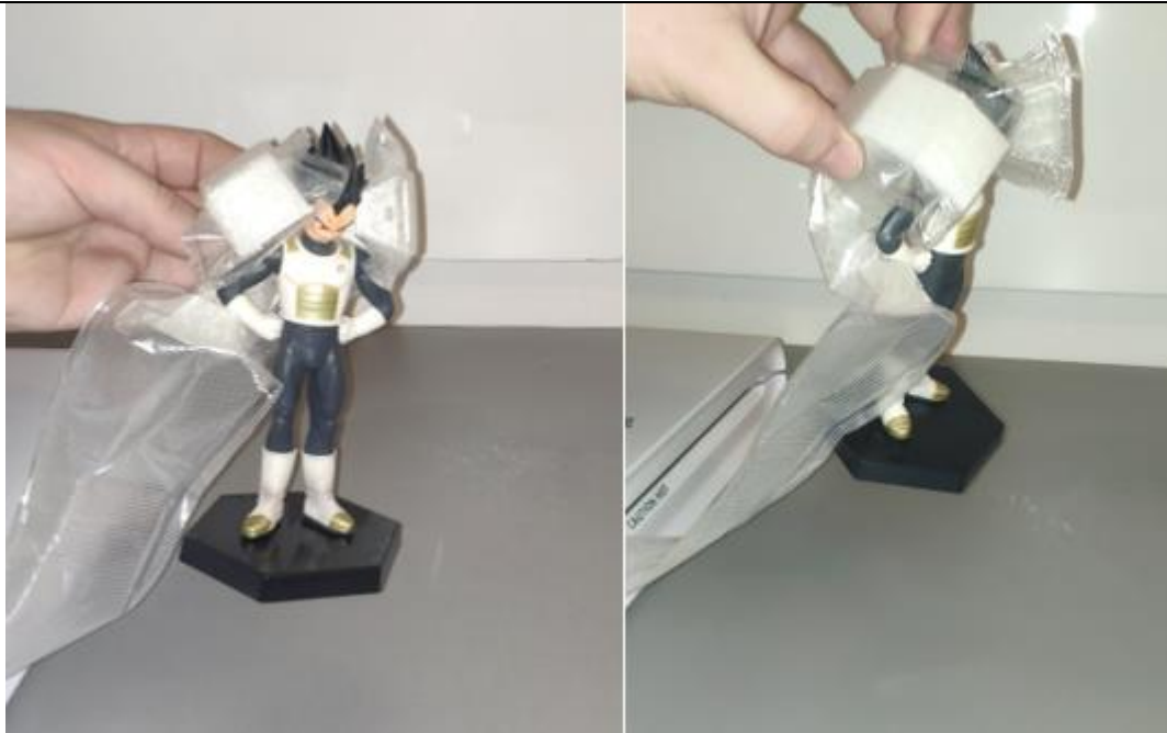
Slika 57 – Hvatanje veće figurice origami prihvatnicom
