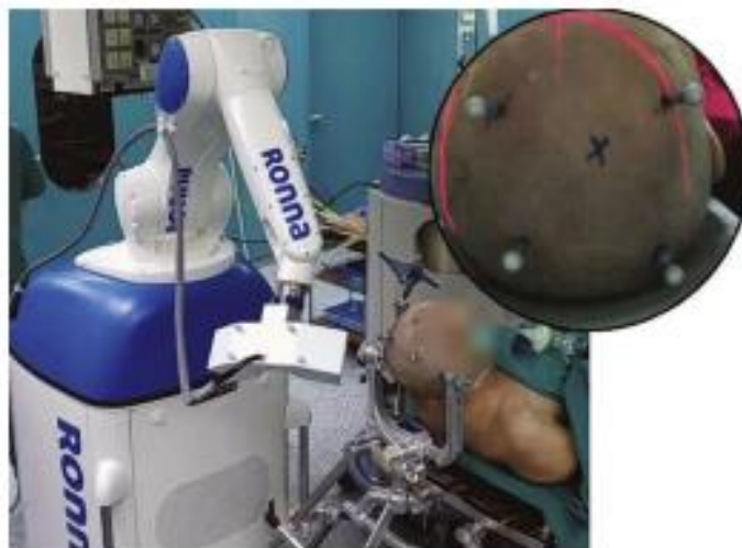
Slika 4. Automatska lokalizacija pacijenta stereovizijskim sustavom RONNAstereo [4]
