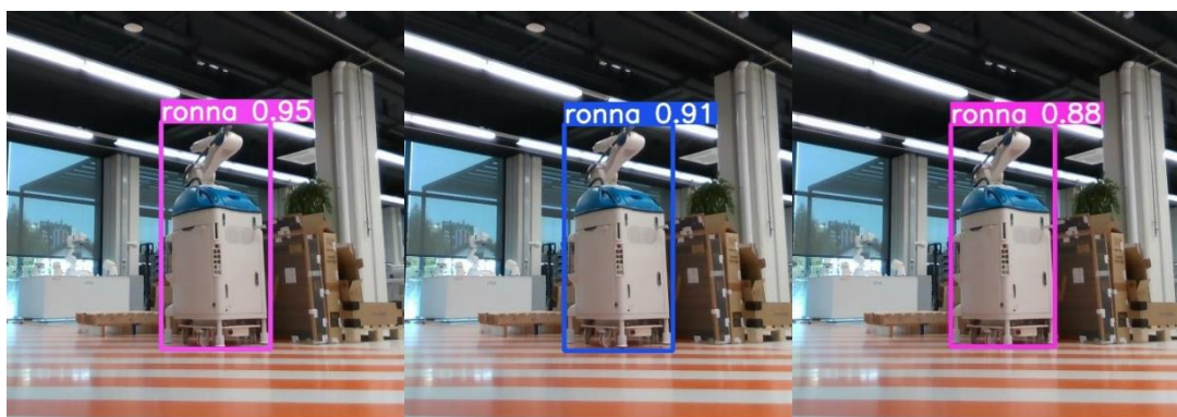
Slika 27. Usporedni prikaz rezultata detekcije s mrežama istreniranim sa 600 epoha (lijevo), 1500 epoha (sredina) i 2000 epoha (desno)
