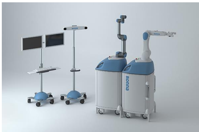
Slika 3. Robotski neuronavigacijski sustav RONNA G4 [5]
