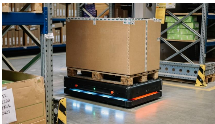
Slika 2. Potpuno autonomni mobilni robot tvrtke Gideon Brothers [3]
