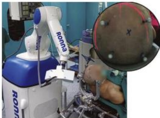
Slika 4. Automatska lokalizacija pacijenta stereovizijskim sustavom RONNAstereo [4]
