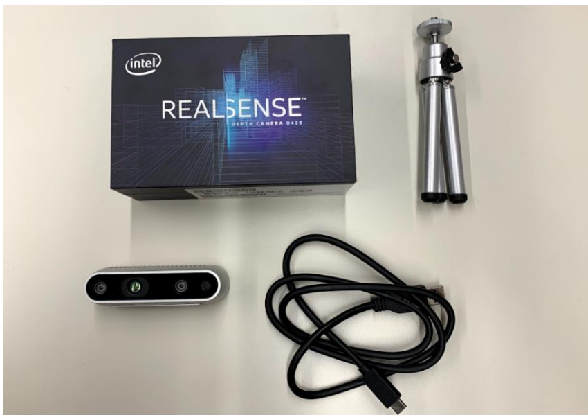
Slika 7. Sadržaj pakiranja Intel RealSense D435 kamere
