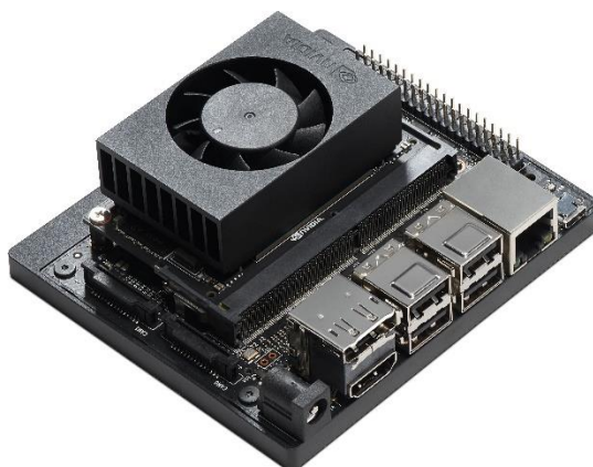
Slika 28. Računalo Nvidia Jetson Xavier NX [18]
