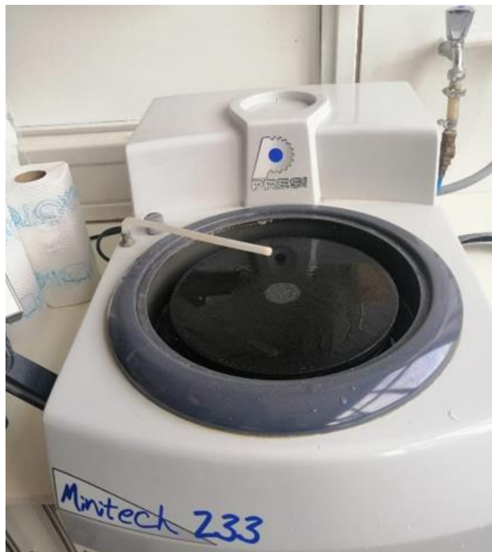
Slika 20. Uređaj za poliranje uzoraka
