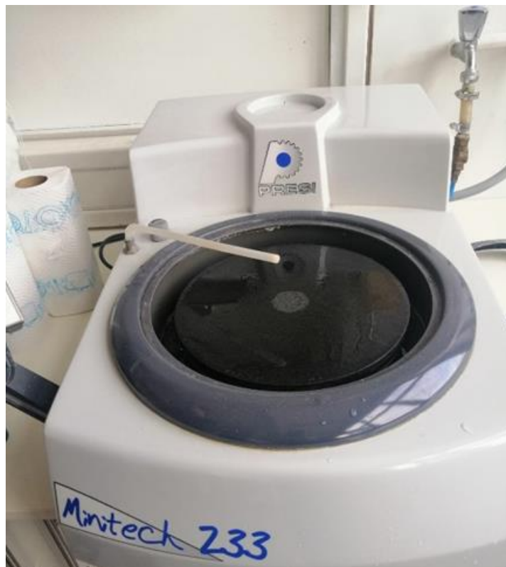
Slika 20. Uređaj za poliranje uzoraka
