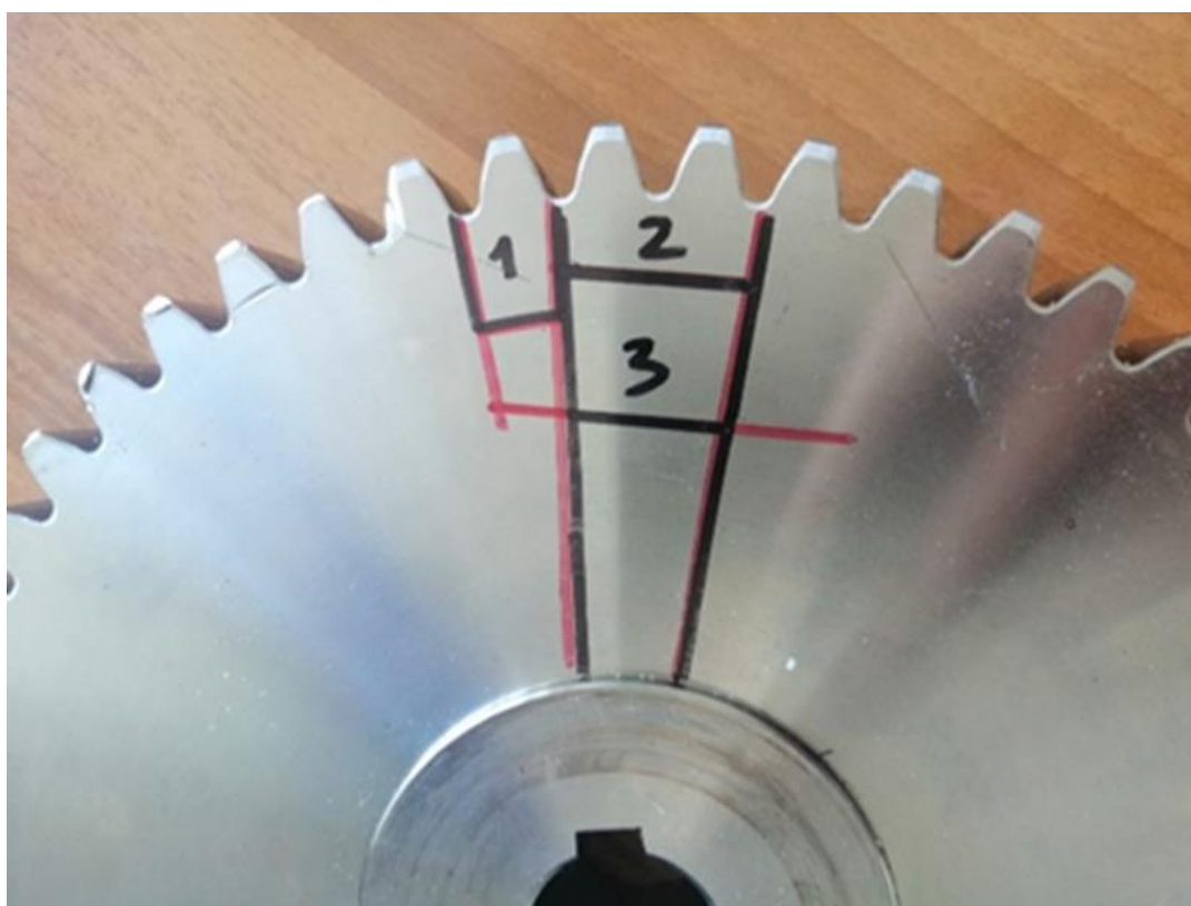
Slika 13. Odabir mjesta za izrezivanje uzoraka
