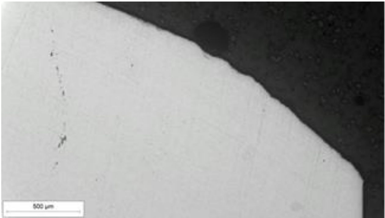
Slika 23. Tribološka oštećenja na površini boka zuba s gornje strane
