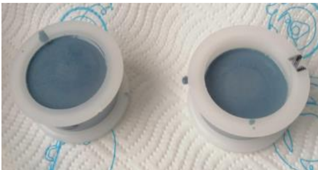
Slika 18. Uzorci nakon zalijevanja polimernom masom
