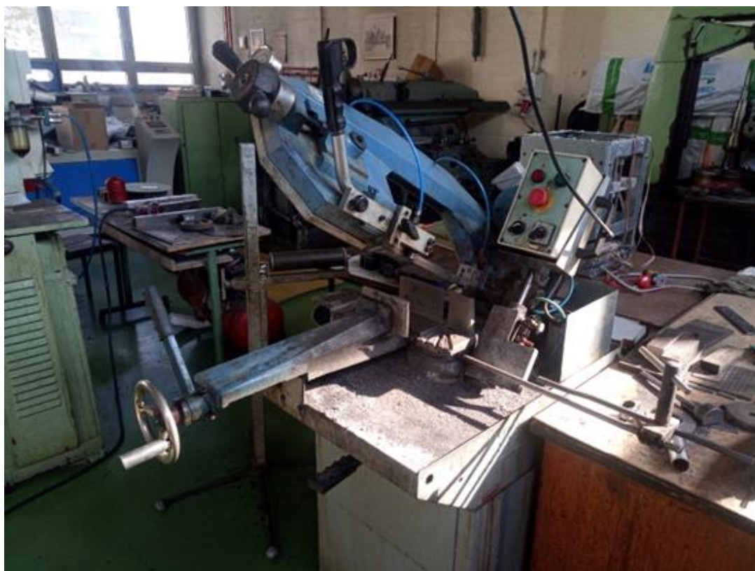
Slika 14. Strojna pila na kojoj su izrezani uzorci
