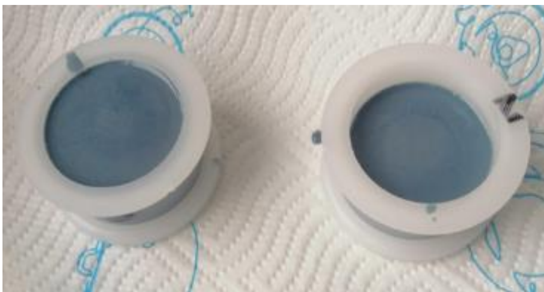
Slika 18. Uzorci nakon zalijevanja polimernom masom
