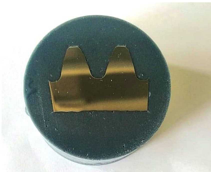
Slika 43. Uzorak 1 nakon poliranja
