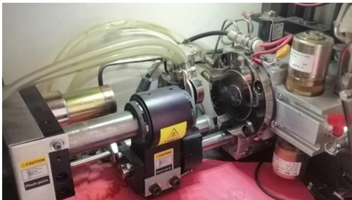
Slika 40. Ispitna komora uređaja GDS 850 A, LECO
