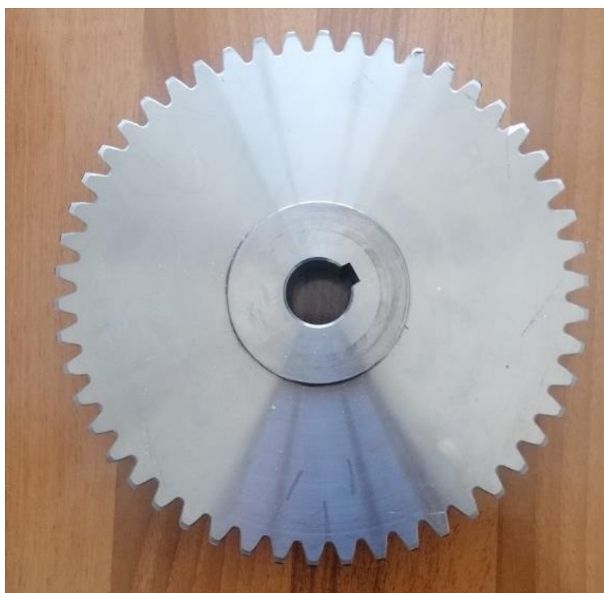
Slika 11. Analizirani zupčanik izuzet iz botomera
