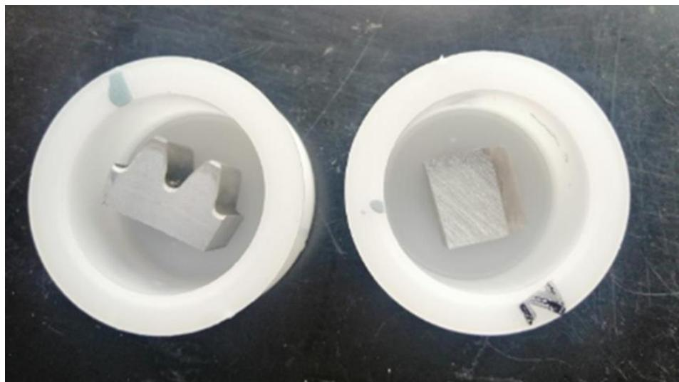
Slika 17. Uzorci u kalupima prije ulijevanja polimerne mase
