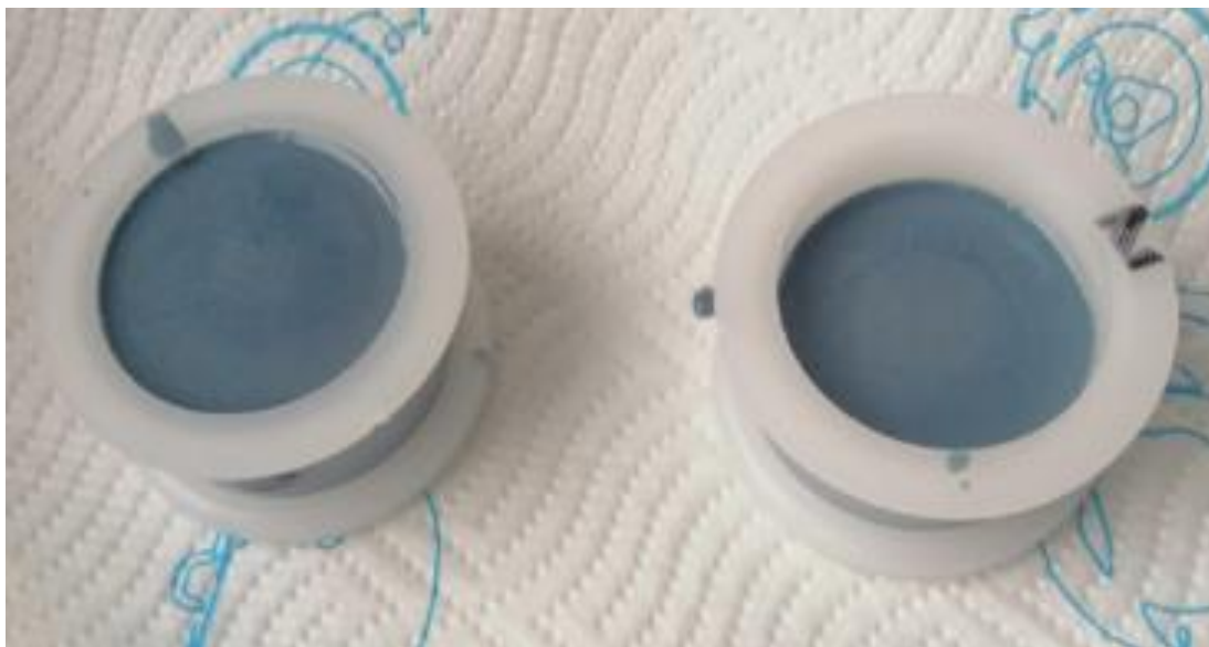
Slika 18. Uzorci nakon zalijevanja polimernom masom
