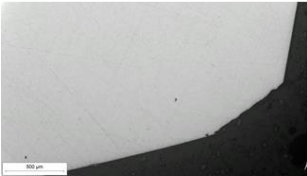
Slika 25. Tribološka oštećenja na površini boka zuba s donje strane
