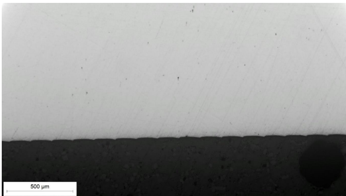
Slika 31. Polirana površina uzorka 2 u rubnom sloju
