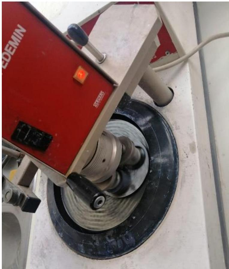
Slika 19. Brušenje uzorka na automatskom uređaju za brušenje
