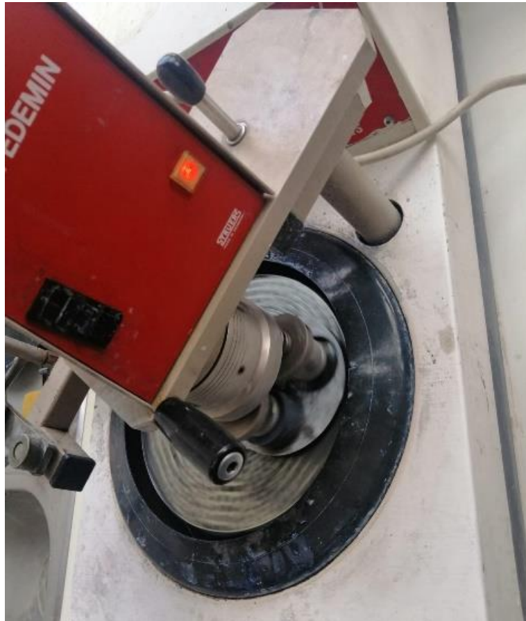
Slika 19. Brušenje uzoraka na automatskom uređaju za brušenje
