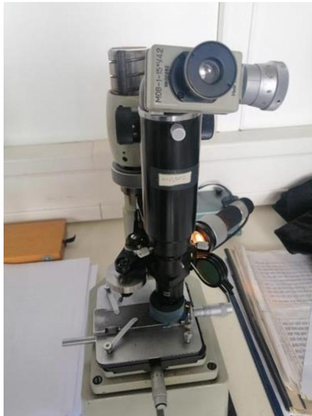
Slika 42. Mikrotvrdomjer PMT-3
