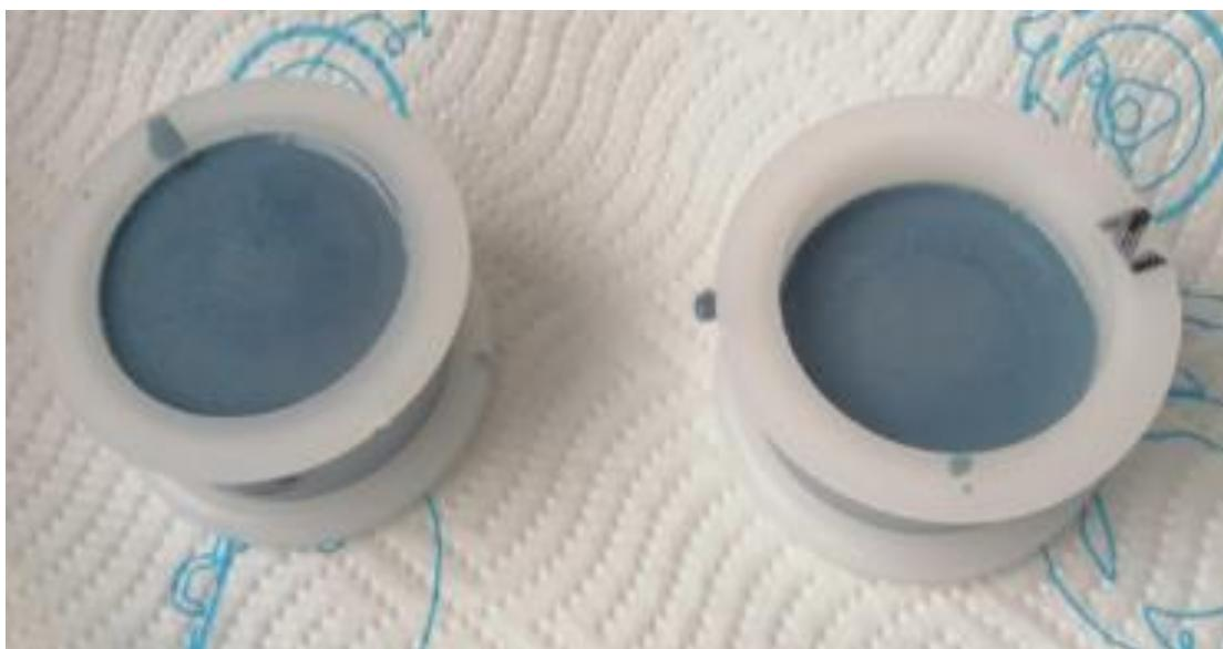
Slika 18. Uzorci nakon zalijevanja polimernom masom
