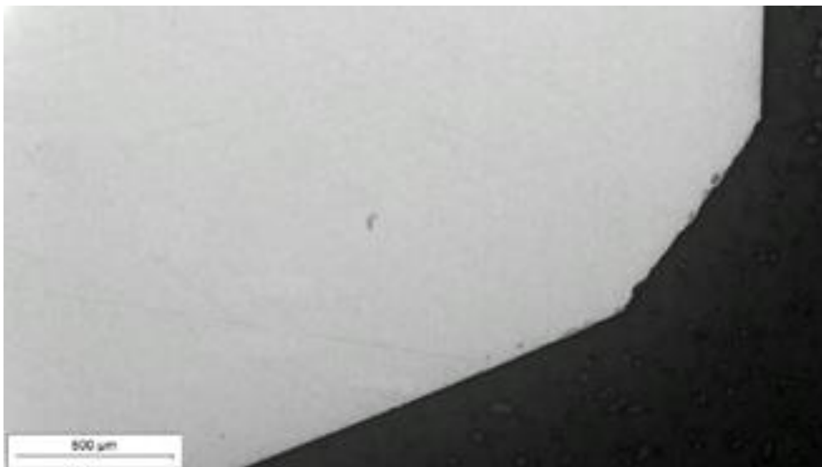
Slika 29. Tribološka oštećenja na površini boka drugog zuba s donje strane
