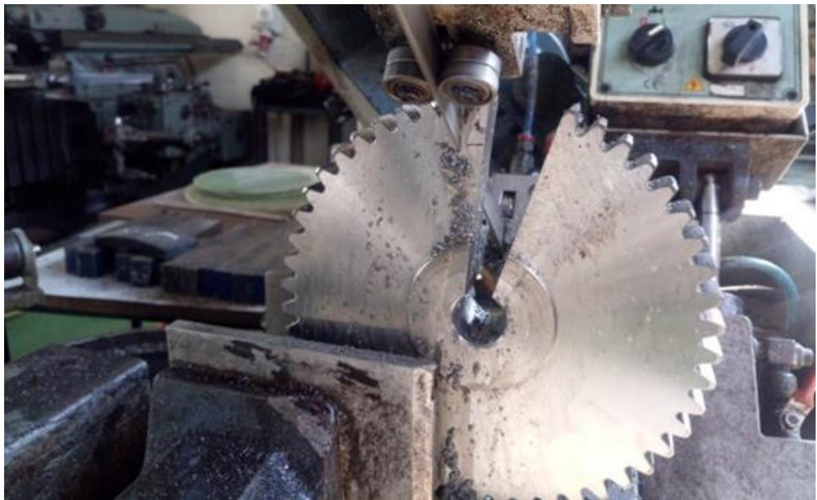
Slika 15. Izrezivanje uzorka iz zupčanika
