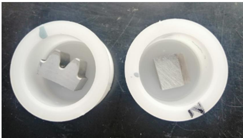
Slika 17. Uzorci u kalupima prije ulijevanja polimerne mase
