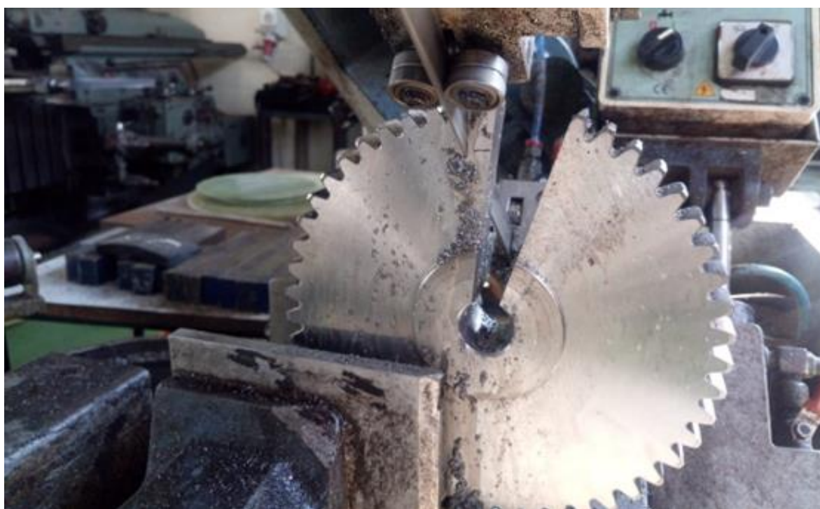
Slika 15. Izrezivanje uzoraka iz zupčanika
