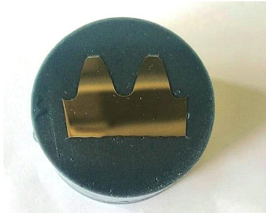
Slika 43. Uzorak 1 nakon poliranja
