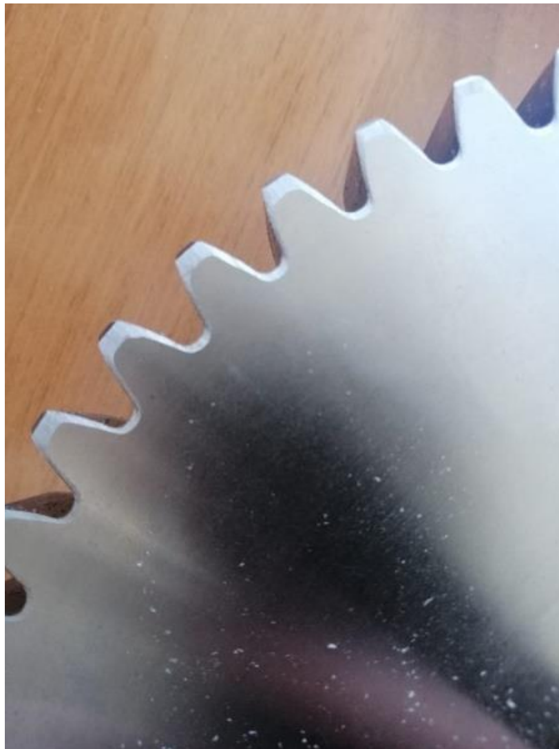
Slika 12. Tribološki oštećeni zubi analiziranog zupčanika
