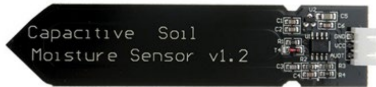
Slika 27. SEN0193 kapacitivni senzor
