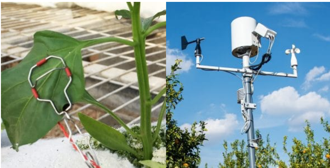
Slika 14. Senzor temperature lista (lijevo) i meteorološka stanica (desno) [15]
