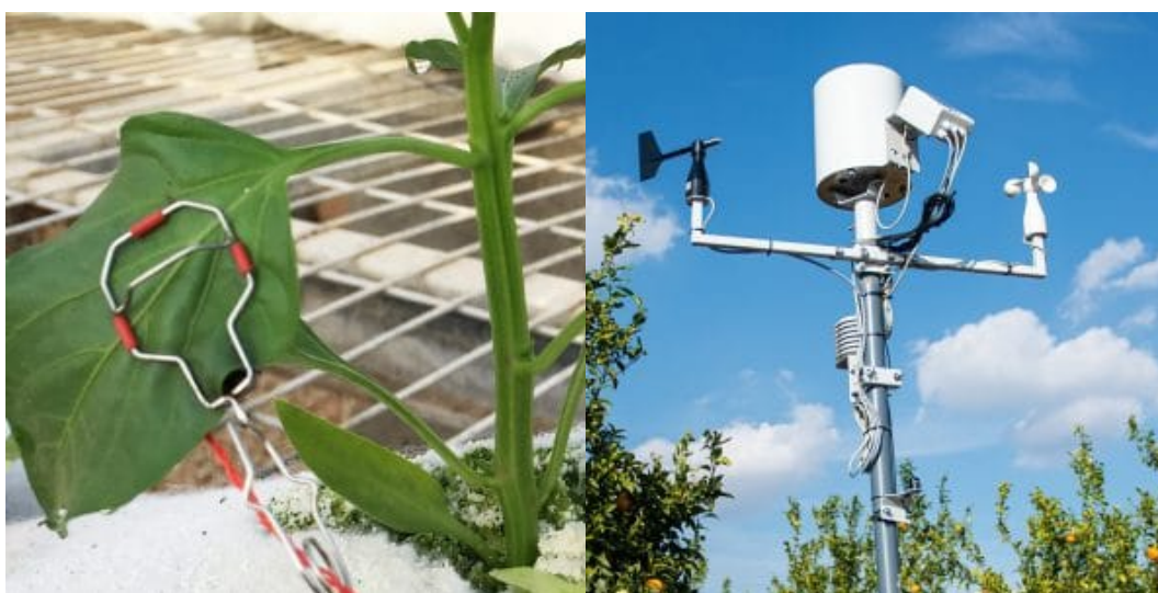
Slika 14. Senzor temperature lista (lijevo) i meteorološka stanica (desno) [15]
