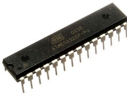
Slika 22. Atmel ATmega328 mikrokontroler [18]
