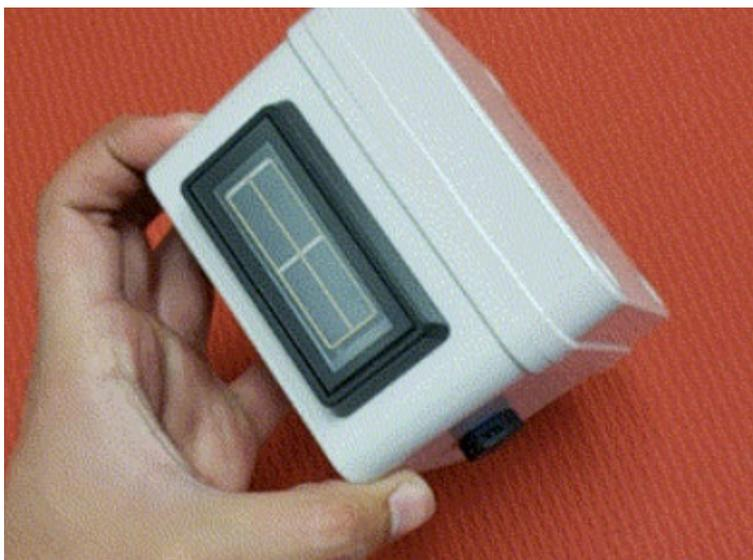
Slika 10. WaterBit Carbon™ - modularna jedinica za prikupljanje podataka [13]
