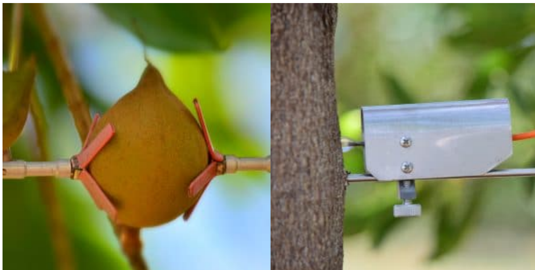
Slika 13. Senzor promjene promjera ploda (lijevo) i dendrometar (desno) [15]
