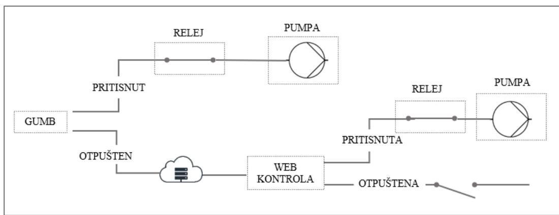
Slika 43. Shema ručne kontrole pumpe za navodnjavanje
