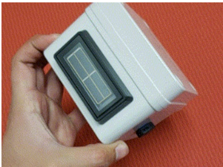
Slika 10. WaterBit Carbon™ - modularna jedinica za prikupljanje podataka [13]
