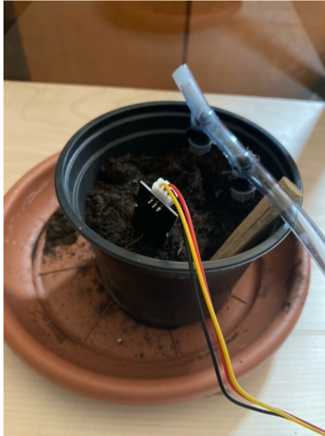
Slika 65. Teglica sa senzorom i prskalicama
