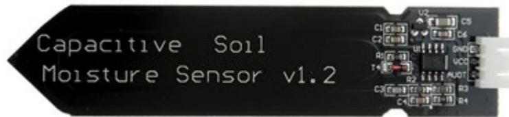
Slika 27. SEN0193 kapacitivni senzor
