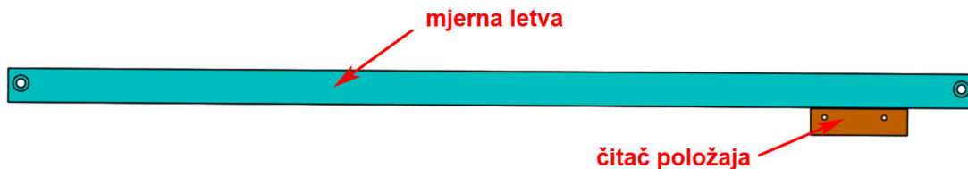
Slika 48: Model mjerne letve s čitačem položaja
