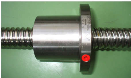
Slika 29: Fotografija i model matice KNV-a
