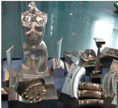
Slika 5: Primjeri oblika dobivenih glodanjem [1]
