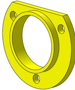
**Slika 42: Pločica za osiguranje vanjskog prstena ležaja**
