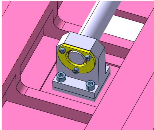
**Slika 46: Kućište ležaja montirano na sklop Y osi**
