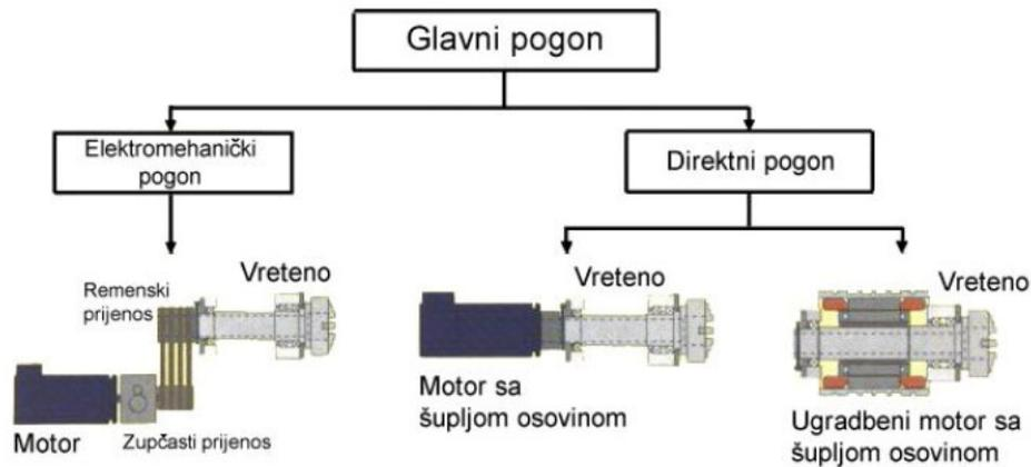
**Slika 9: Izvedbe glavnog pogona alatnih strojeva [2]**
