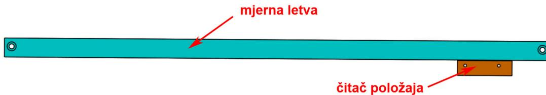
Slika 48: Model mjerne letve s čitačem položaja
