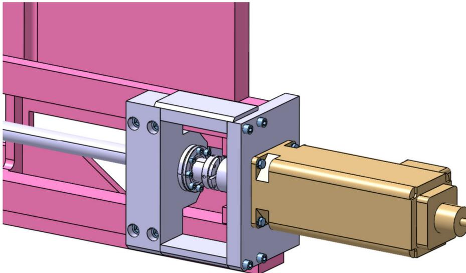
Slika 23: Sklop nosača motora pričvršćen na sklop Y
