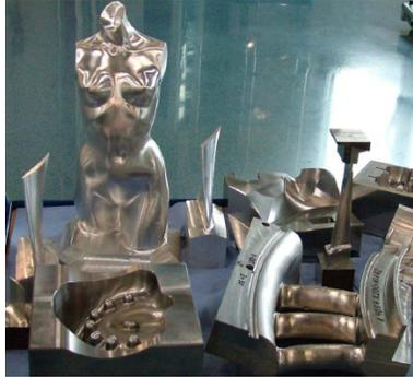
Slika 5: Primjeri oblika dobivenih glodanjem [1]
