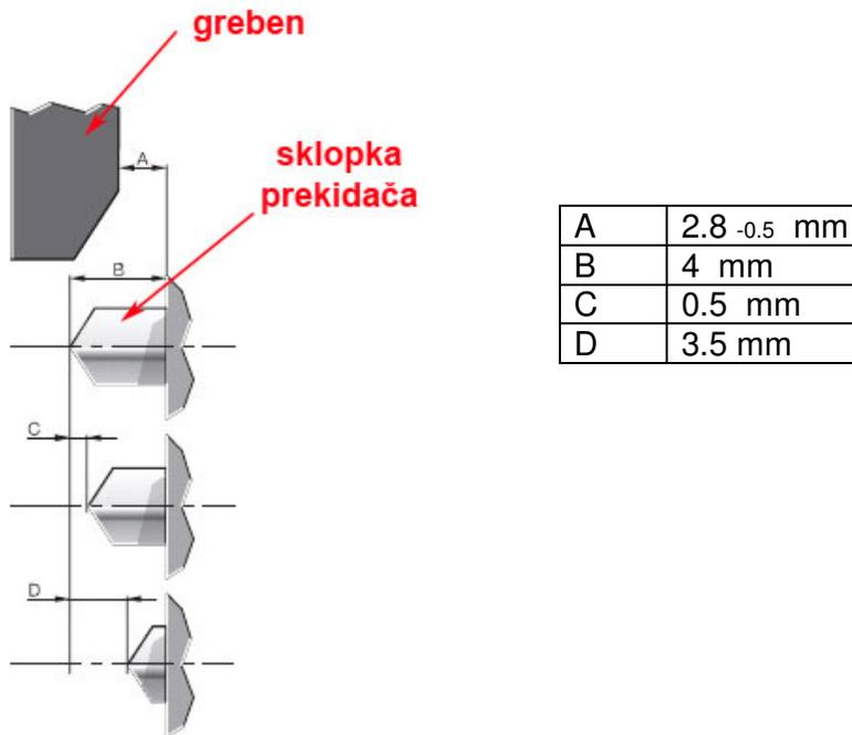
Slika 55: Način montaže prekidača i grebena prekidača[5]
