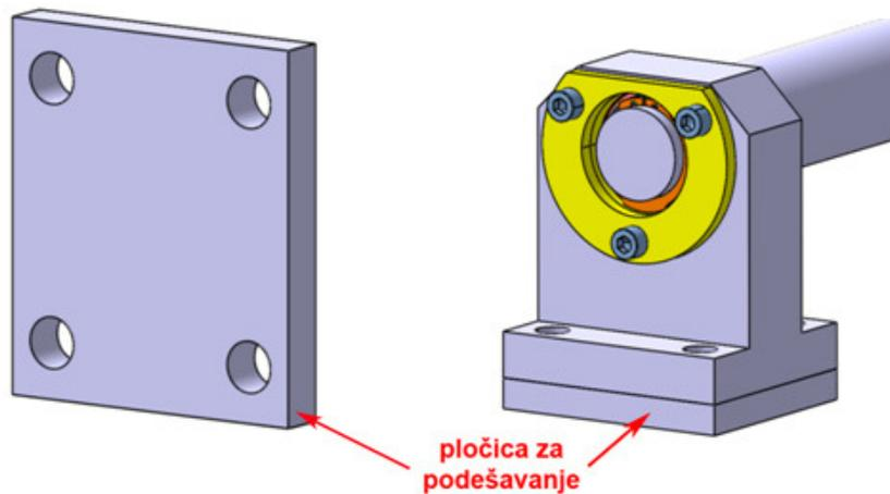
**Slika 43: Podložna pločica za podešavanje visine kućišta protuležaja**
