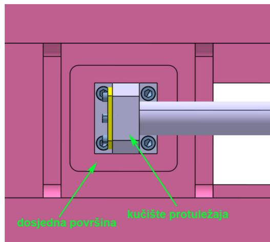
Slika 45: Kućište ležaja montirano na sklop Y osi
