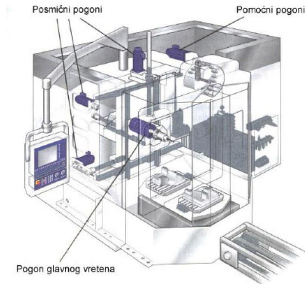
Slika 8: Prikaz podjele pogona na obradnom centru [2]
