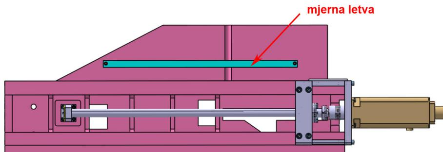
Slika 49: Pozicija mjerne letve na sklopu Y osi
