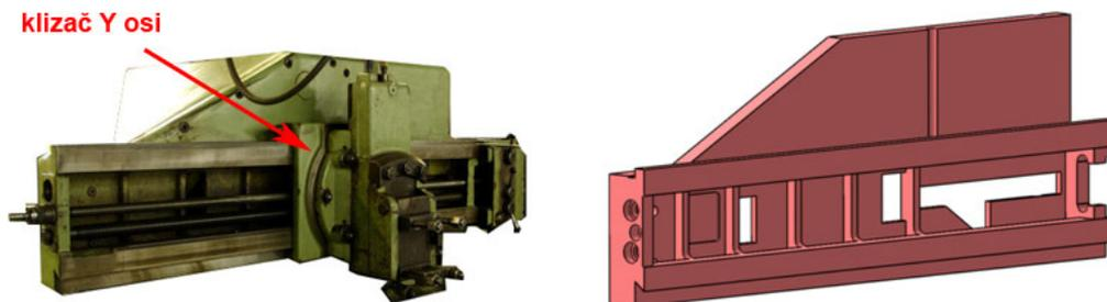
Slika 15: Fotografija i model sklopa Y osi
