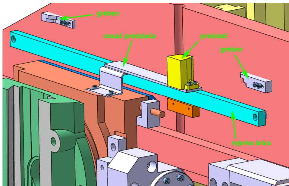
Slika 62: Nosač prekidača montiran na klizač Y osi
