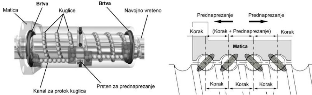
**Slika 13: Konstrukcija kugličnog navojnog vretena i sustav prednaprezanja [2]**
