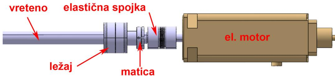
Slika 18: Spoj motora i vretena pomoću elastične spojke
