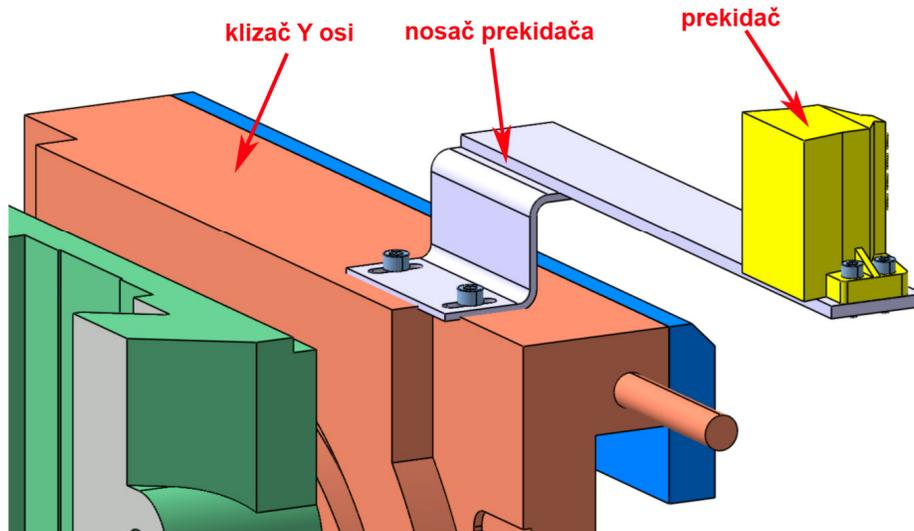
Slika 61: Nosač prekidača montiran na klizač Y osi
