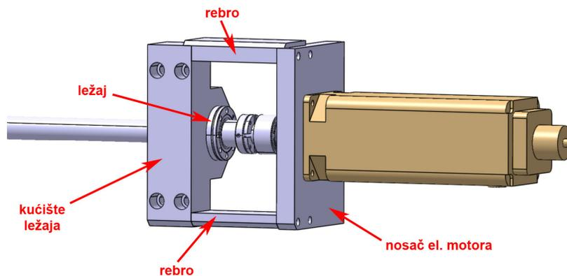
Slika 19: Nosač motora
