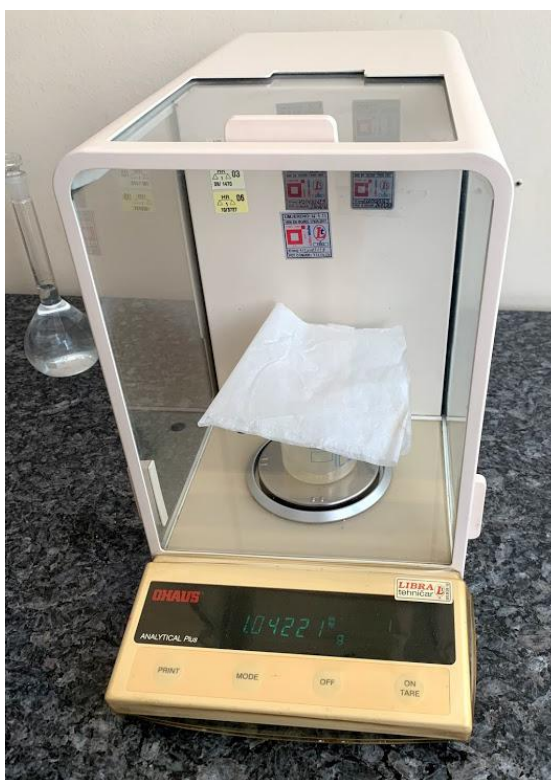
Slika 12. Mjerenje mase polietilenske podloge na analitičkoj vagi
