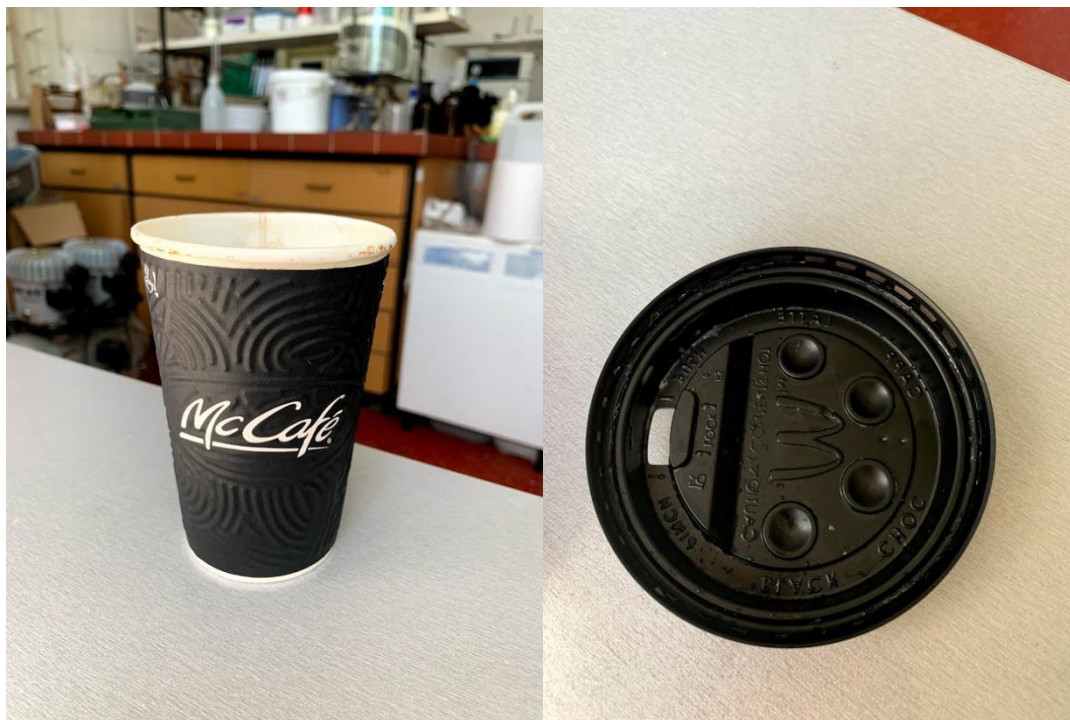
Slika 11. (a) Papirnatu šalicu s polietilenskom podlogom; (b) polimerni poklopac papirnatu šalice
