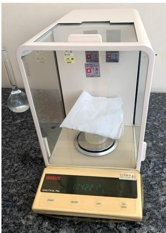
Slika 12. Mjerenje mase polietilenske podloge na analitičkoj vagi
