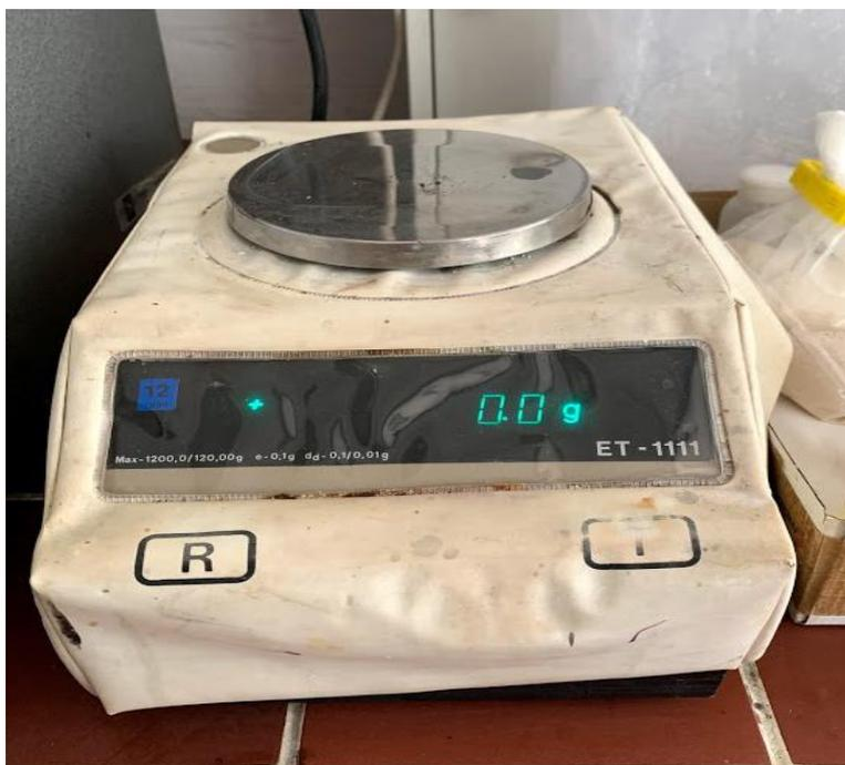
Slika 10. Vaga za mjerenje mase proizvoda
