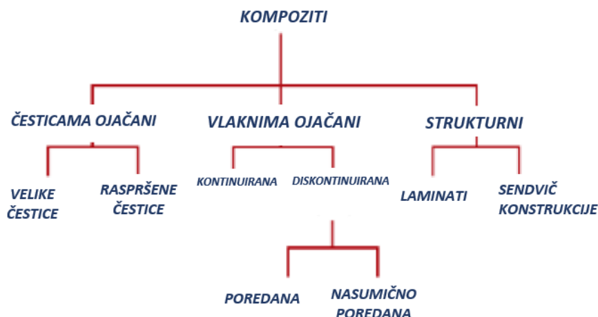
Slika 4. Prikaz podjele kompozita prema utjecaju ojačala [6]
