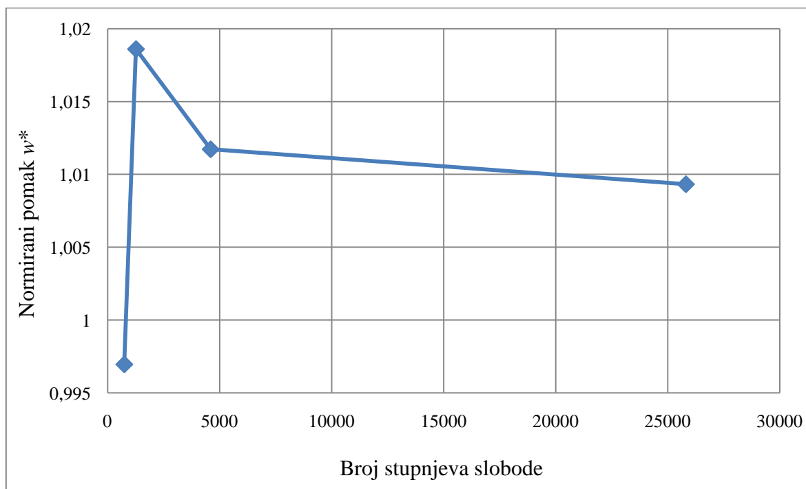
Slika 3.24. Konvergencija normiranog pomaka w^* sa C3D10M konačnim elementima
