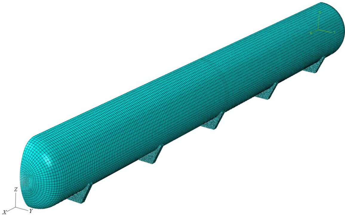
Slika 6.43. Mreža konačnih elemenata na cijelome modelu
