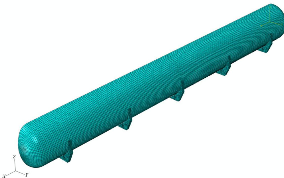
Slika 6.65. Mreža konačnih elemenata na cijelome modelu
