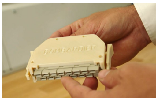
Slika 20. 3D ispis konektora [41]
