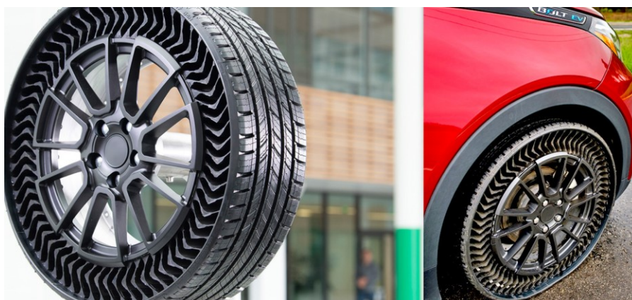
Slika 24. Prototip gume Uptis [48]
