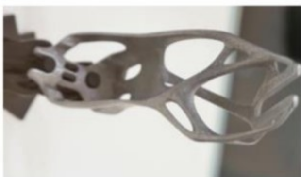
Slika 22. Aditivno proizveden nosač krova na modelu i8 [45] i kočiona čeljust na modelu M850i [46]
