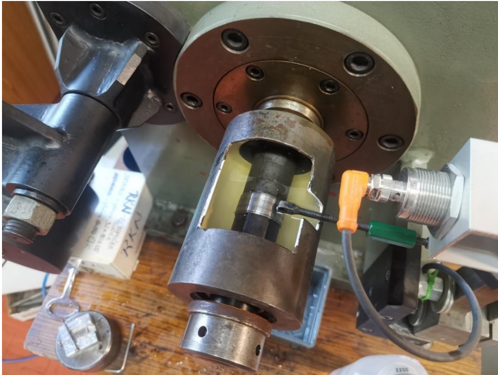
Slika 25. Postavljanje dodatka za ispitivanje u vlažnom stanju
