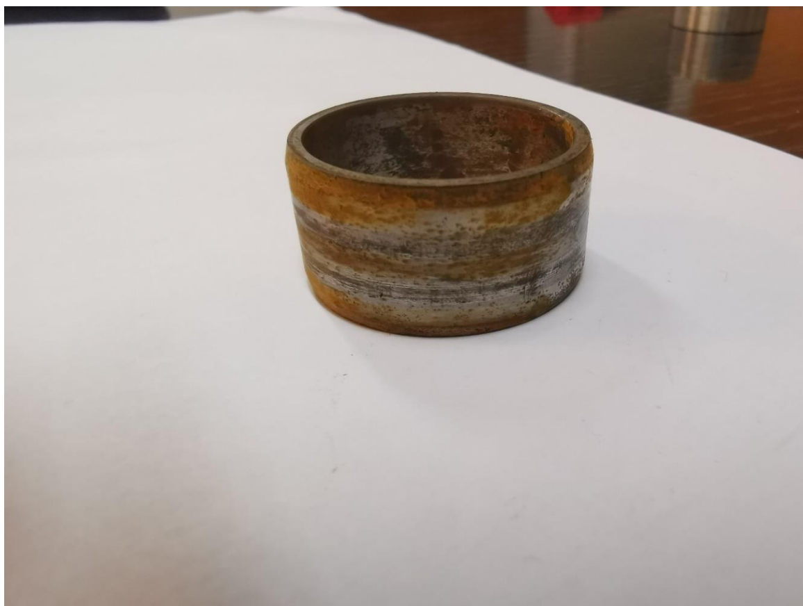
Slika 27. Prsten nakon ispitivanja u vlažnom stanju
