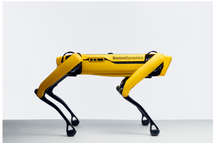
Slika 1.2: Spot, četveronožni komercijalni robot tvrtke Boston Dynamics [4]
