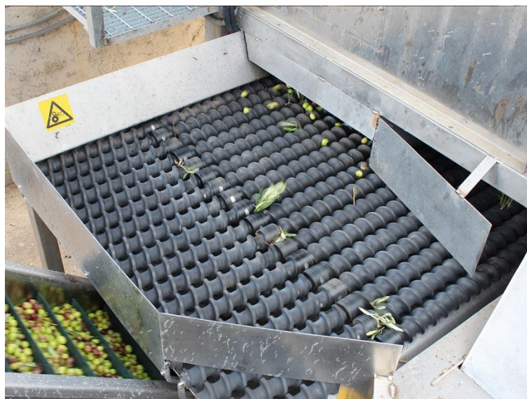
Slika 2.6. Navojne šipke za odstranjivanje većeg lišća kod uređaja Clemente Tornado 1 [14]
