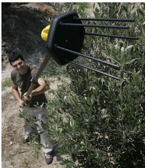
Slika 1.6. Uređaj za branje maslina [11]
