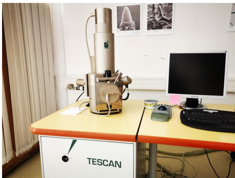
Slika 25 Skenirajući elektronski mikroskop TESCAN VEGA 5136 MM
