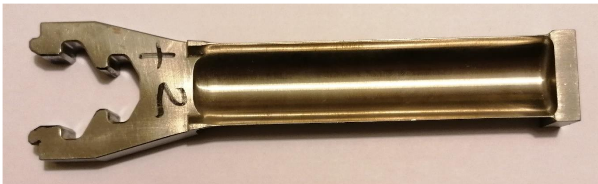
Slika 18 Lopatica rotora parne turbine prije rezanja - 2
