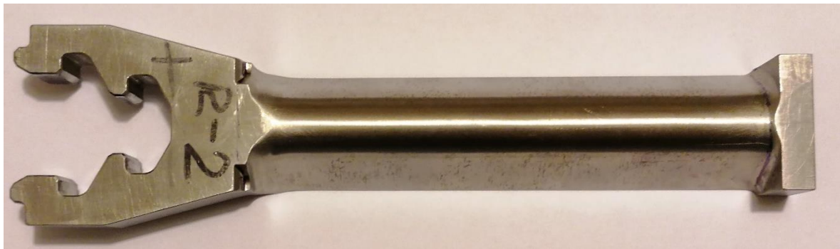
Slika 17 Lopatica rotora parne turbine prije rezanja - 1
