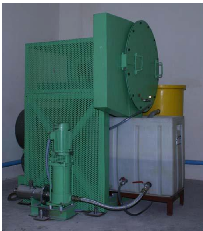
Slika 10 Uređaj za ispitivanje otpornosti materijala na eroziju kapljevnom [12]
