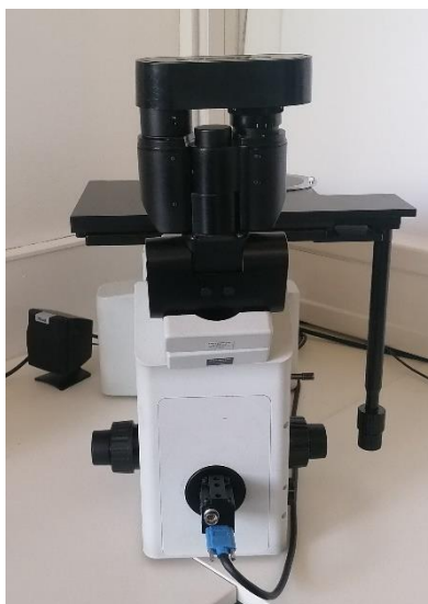
Slika 23 Svjetlosni mikroskop Olympus GX51
