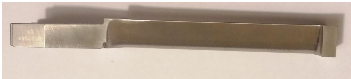
Slika 19 Lopatica rotora parne turbine prije rezanja - 3
