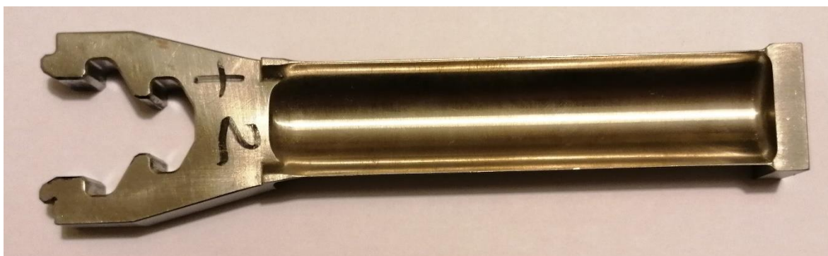
Slika 18 Lopatica rotora parne turbine prije rezanja - 2
