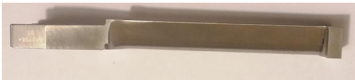
Slika 19 Lopatica rotora parne turbine prije rezanja - 3
