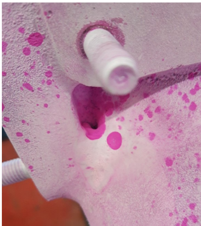
Slika 19. Nestaljen materijal na prijelazu stijenci
