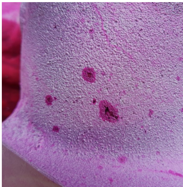
Slika 20. Pore na vanjskoj stijenci
