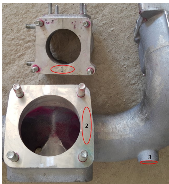
Slika 41. Područja mjerenja tvrdoće
