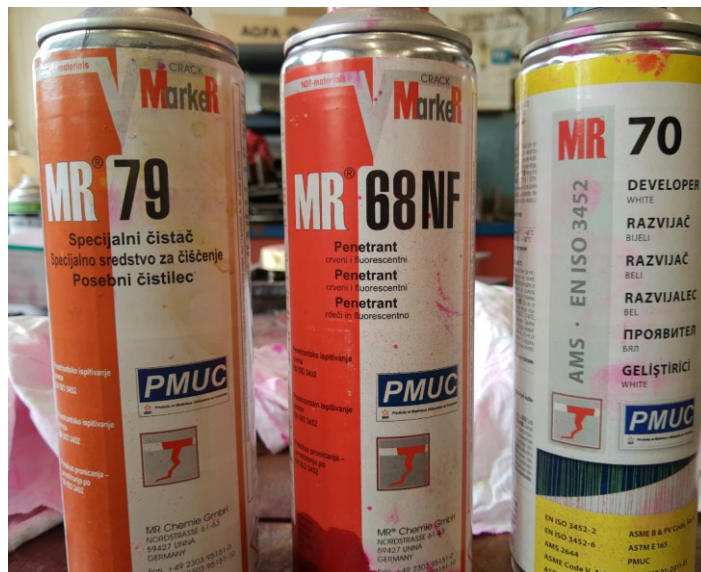
Slika 16. Oprema korištenja pri ispitivanju penetrantom
