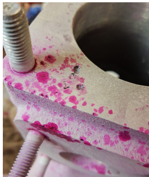
Slika 21. Pore na obrađenom dijelu
