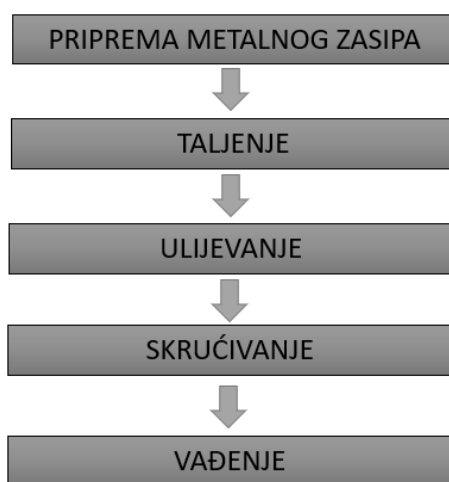
Slika 8. Koraci u postupku lijevanja metala [9]
