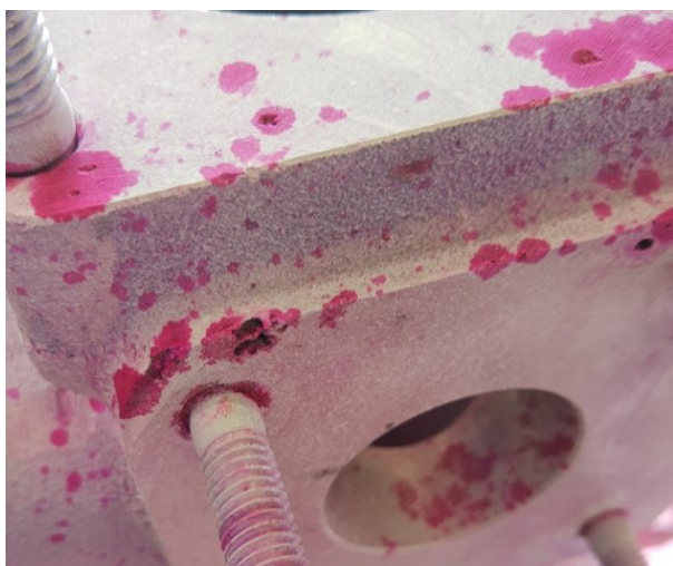
Slika 17. Pore na površini odljevka
