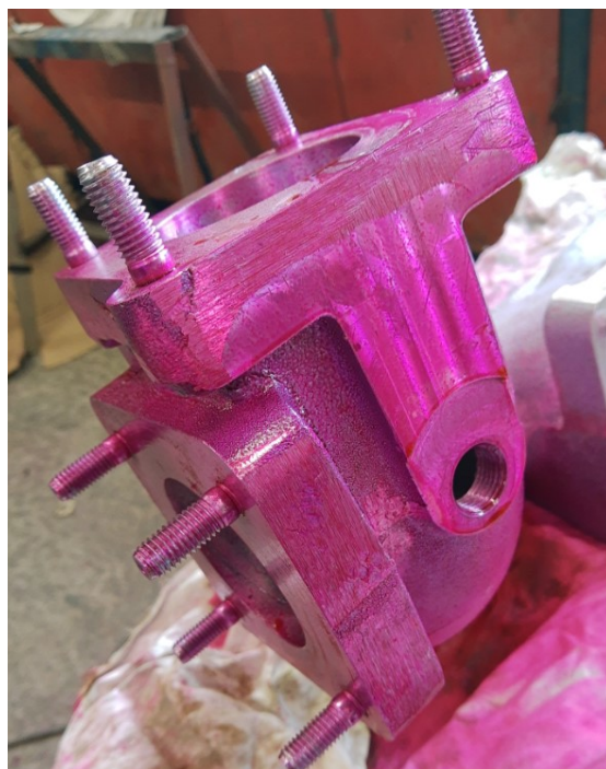
Slika 15. Segment odljevka sa nanesenim penetrantom
