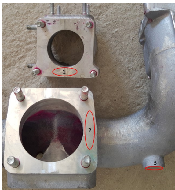
Slika 41. Područja mjerenja tvrdoće
