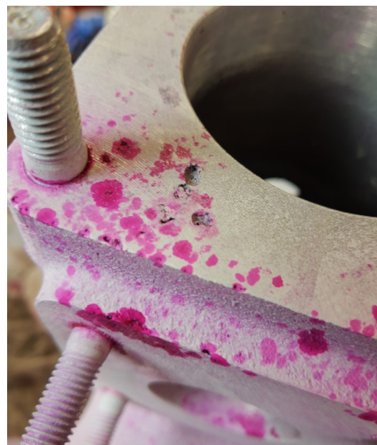
Slika 21. Pore na obrađenom dijelu
