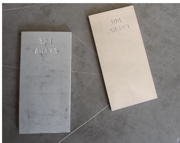
Slika 35. Testne pločice legura bliskog kemijskog sastava
