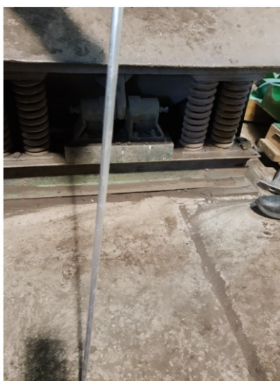
Slika 42. Štap AlTi5B1 korišten za rafiniranje
