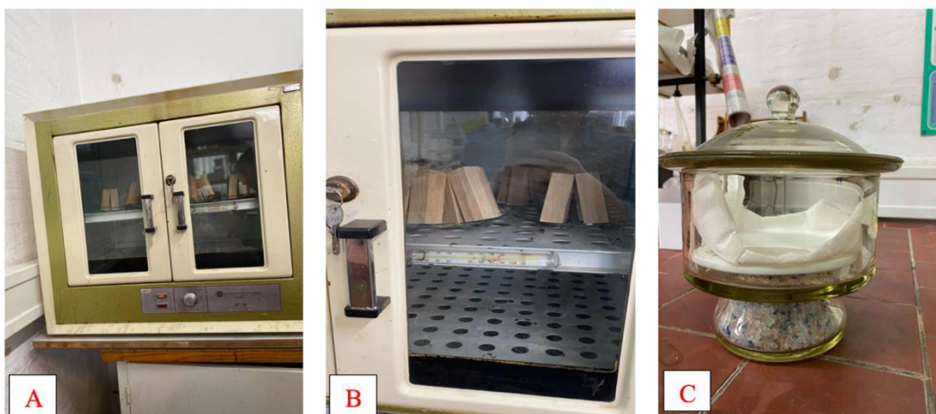
Slika 29. Sušionik u kojem je provedeno sušenje uzoraka izvana (A) i iznutra (B); eksikator (C)
