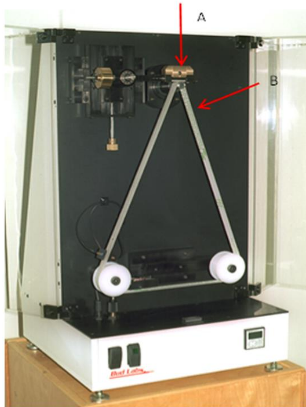
Slika 19. Uređaj za ispitivanje abrazijskog trošenja ASTM G174 metodom: ispitni uzorak (A) i pokretna abrazivna traka (B) [19]
