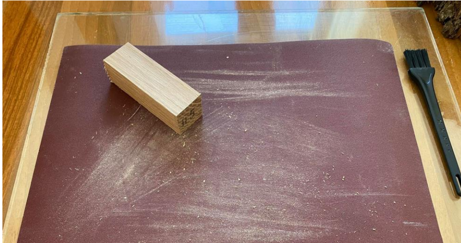
Slika 26. Brušenje i četkanje uzoraka prije vaganja
