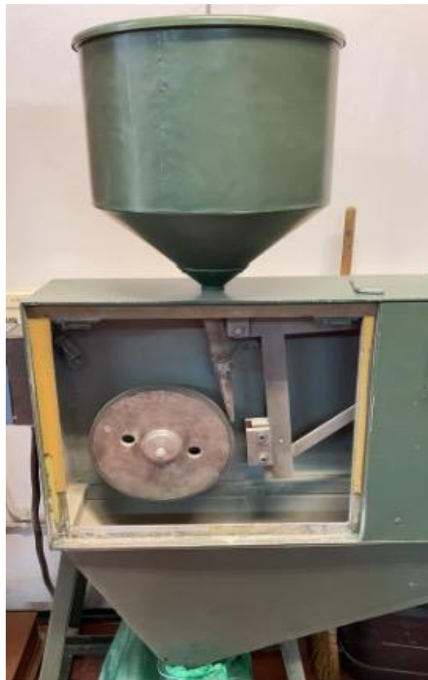
Slika 30. Uređaj za ispitivanje abrazijskog trošenja
