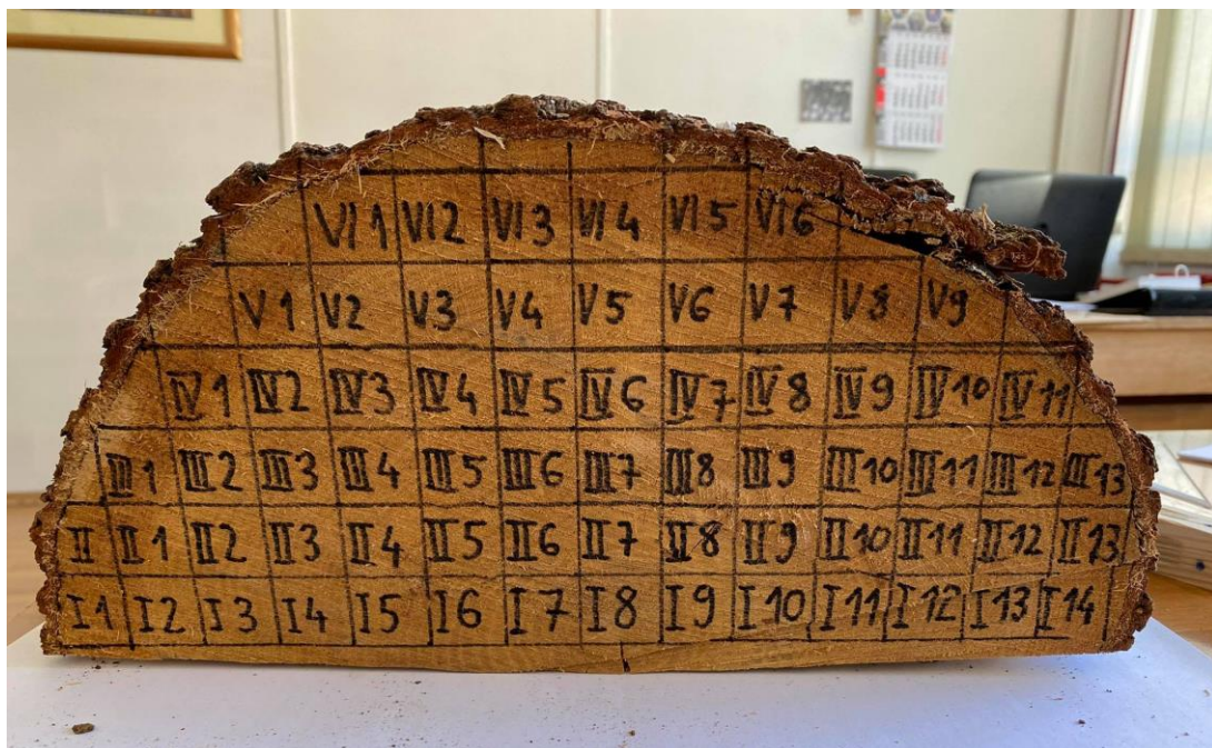
Slika 23. Raspored uzoraka na poprečnom presjeku
