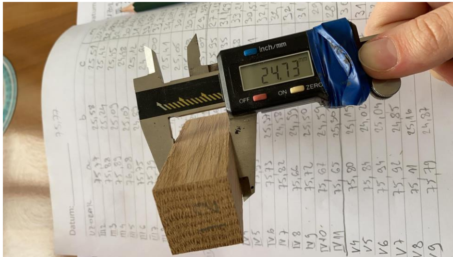
Slika 28. Mjerenje dimenzija uzoraka
