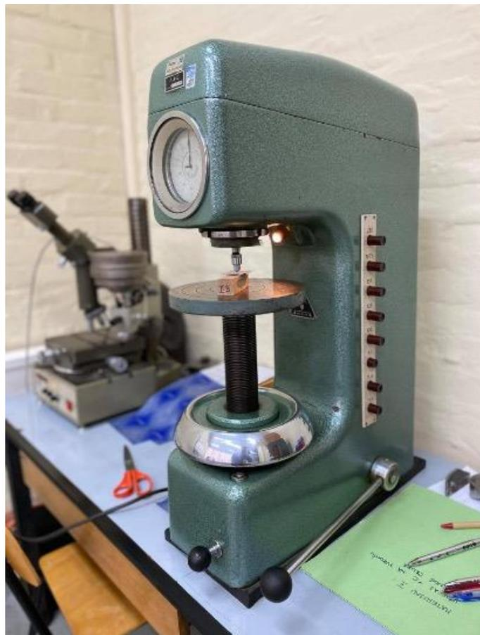
Slika 33. Uređaj za ispitivanje tvrdoće Brinellovom metodom
