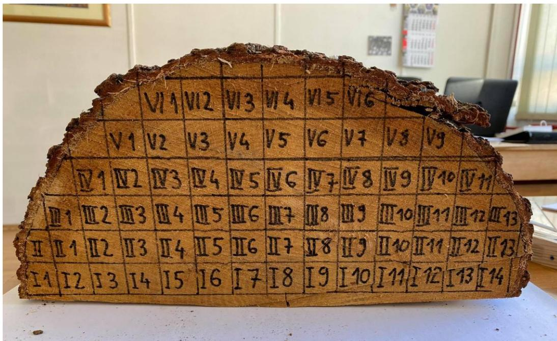
**Slika 23. Raspored uzoraka na poprečnom presjeku**
