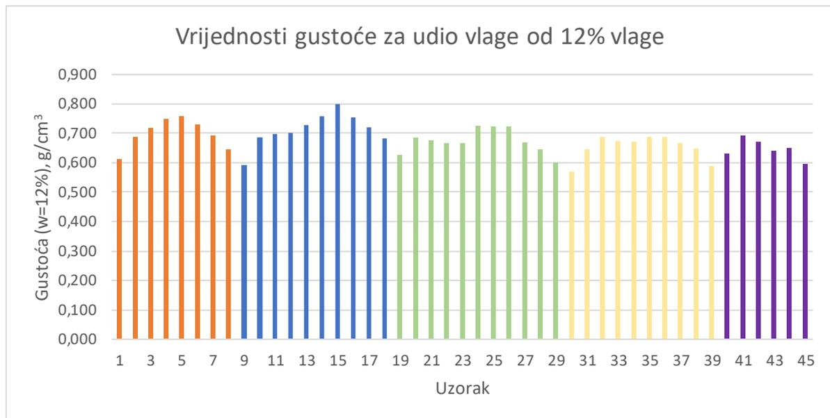
**Slika 37. Vrijednosti gustoće uzoraka za udio vlage od 12%**
