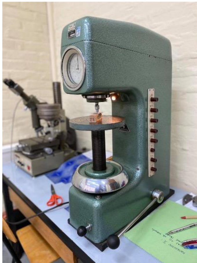
Slika 33. Uređaj za ispitivanje tvrdoće Brinellovom metodom
