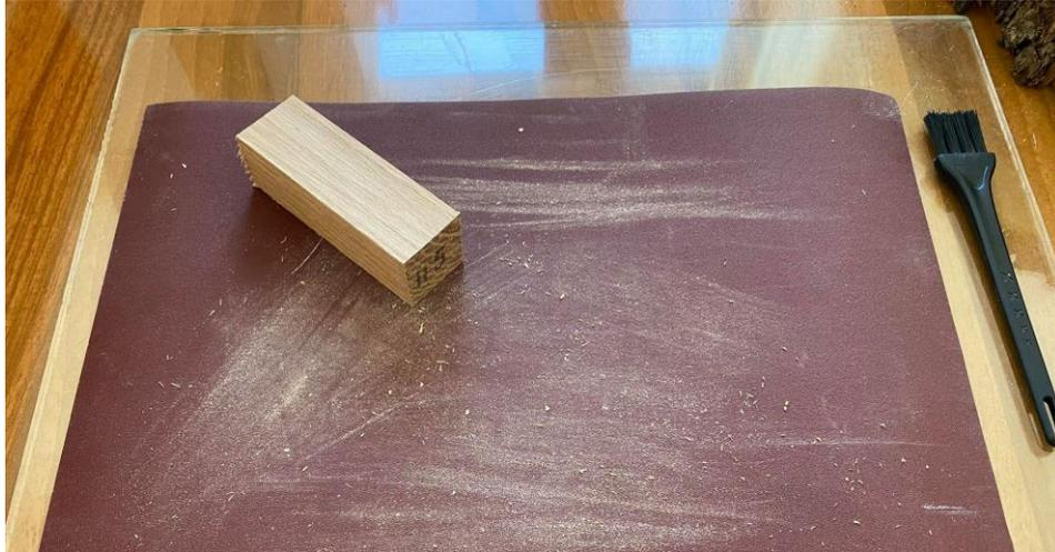
**Slika 26. Brušenje i četkanje uzoraka prije vaganja**
