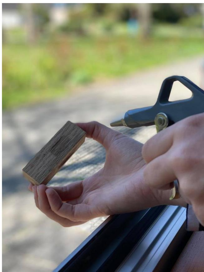
**Slika 32. Čišćenje uzorka pneumatskim kompresorom**
