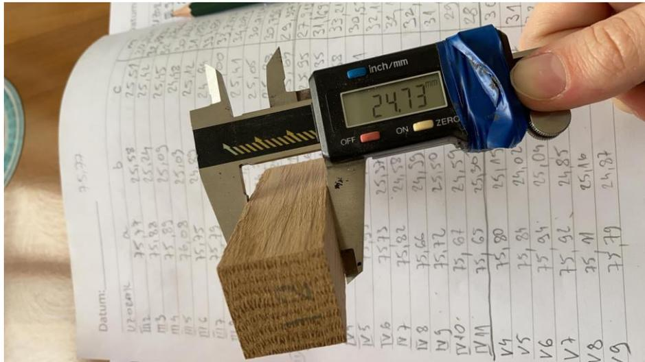
Slika 28. Mjerenje dimenzija uzoraka
