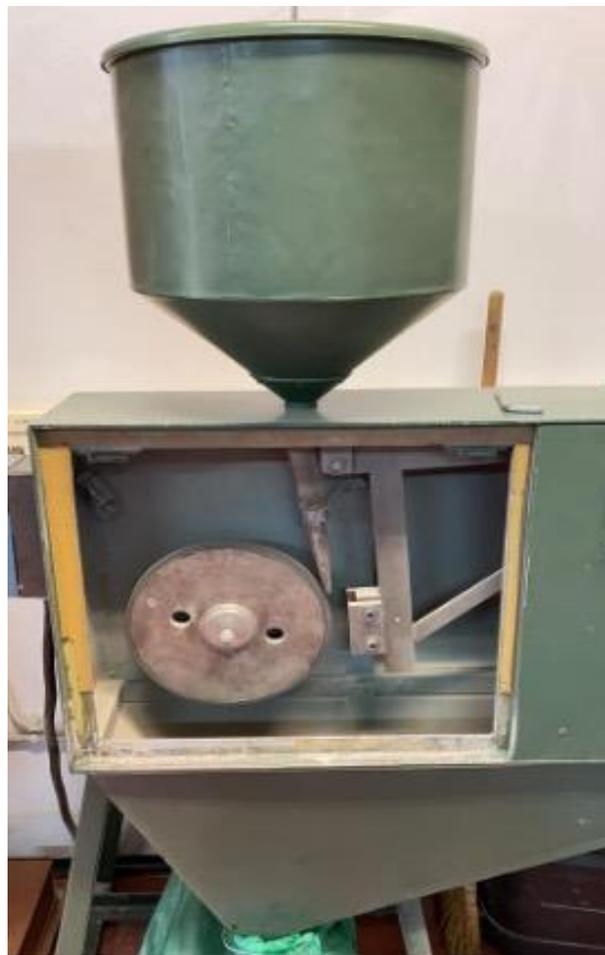
Slika 30. Uređaj za ispitivanje abrazijskog trošenja
