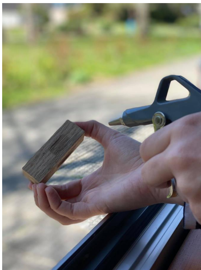
Slika 32. Čišćenje uzorka pneumatskim kompresorom
