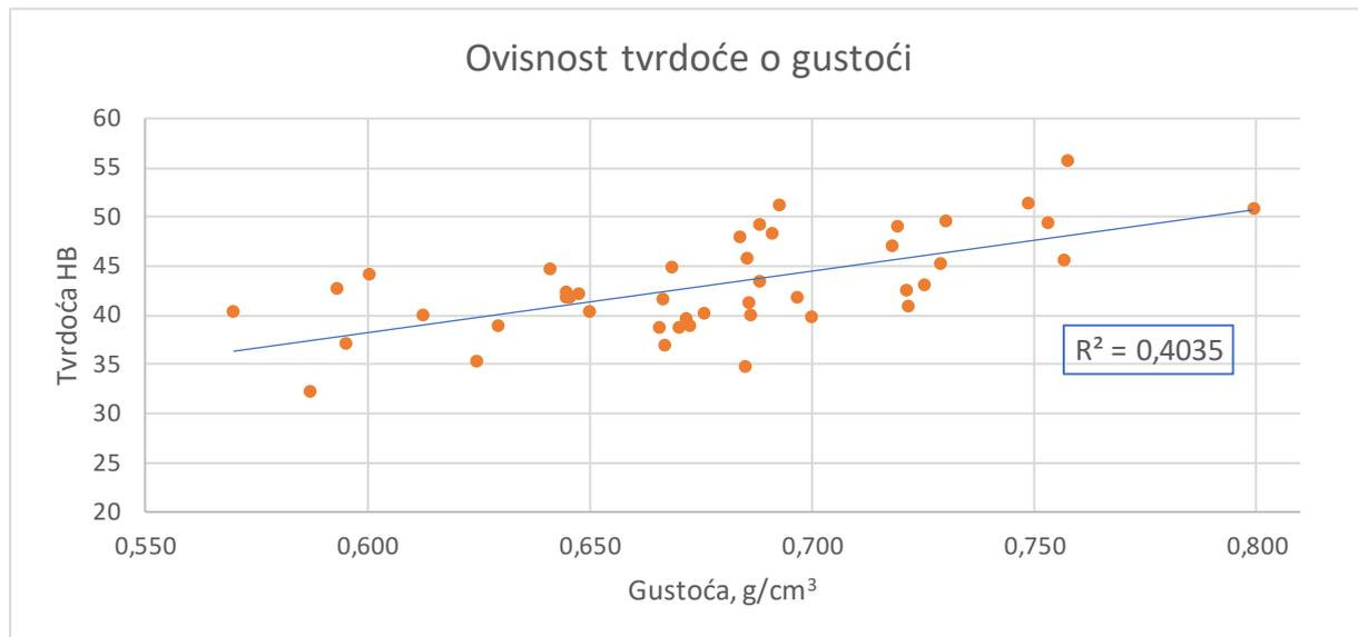
**Slika 44. Ovisnost tvrdoće pojedinih uzoraka o gustoći ( $w=12\%$ )**
