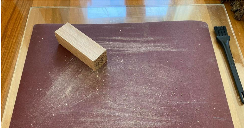
Slika 26. Brušenje i četkanje uzoraka prije vaganja
