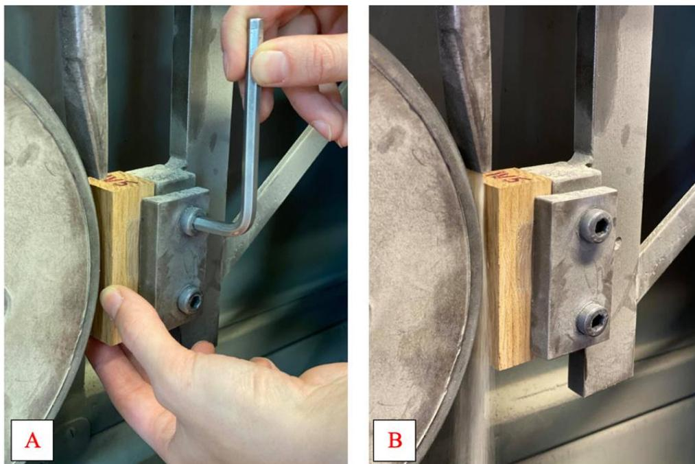
**Slika 31. Pričvrščivanje uzorka (A) i njegovo trošenje (B)**
