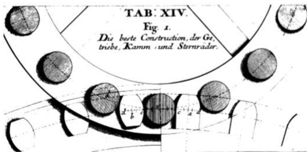
Slika 4 – Zahvat dvaju primitivnih zupčanika, Leonhard C. Sturm [3]
