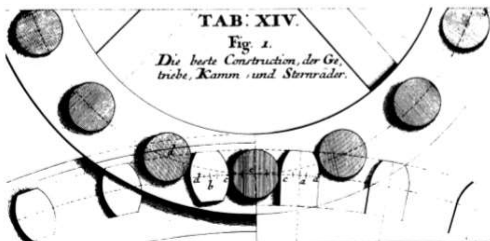
Slika 4 – Zahvat dvaju primitivnih zupčanika, Leonhard C. Sturm [3]
