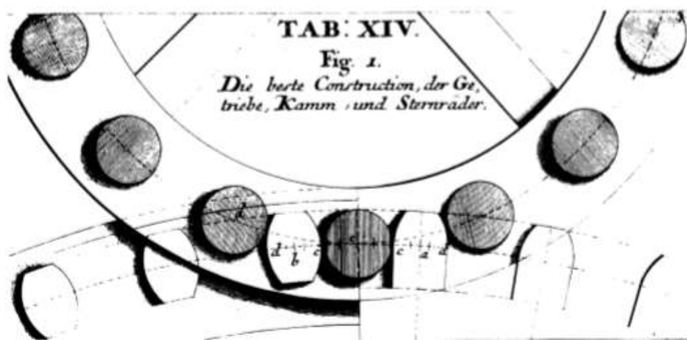
Slika 4 – Zahvat dvaju primitivnih zupčanika, Leonhard C. Sturm [3]
