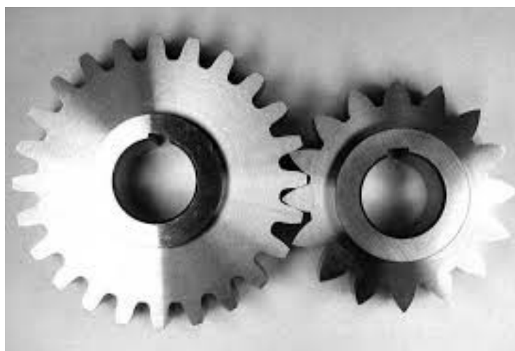
Slika 6 – FZG standardni ispitni zupčanički par Tip A [25]
