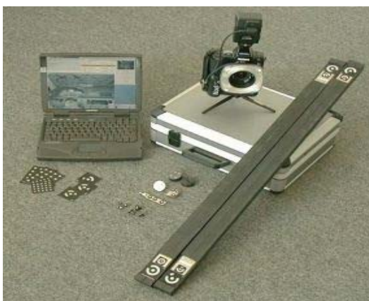
Slika 7.6. Fotogrametrijski sustav TRITOP firme GOM mbH.
