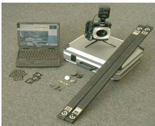
Slika 7.6. Fotografometrijski sustav TRITOP firme GOM mbH.
