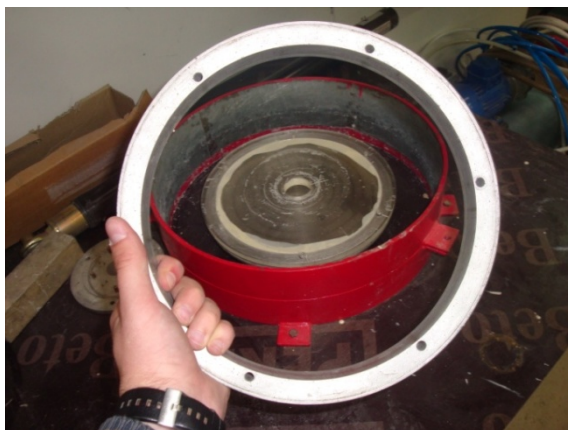
Slika 8.6. Prikaz O – prstena kod uređaja za centrifugalno lijevanje
