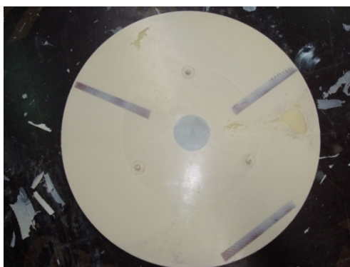
Slika 8.13. Prikaz upotrebe odstoynika pri izradi sendvič ploče
