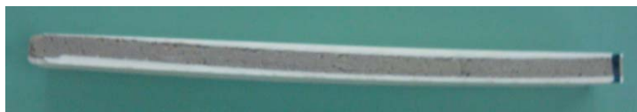
Slika 8.19. Prikaz ispitnog tijela s jednoliko raspoređenom smolom s obje strane PUR pjene
