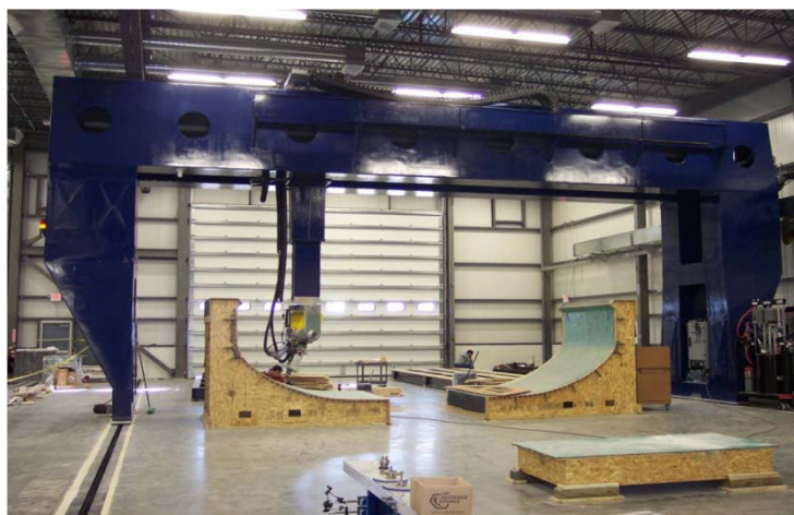
Slika 6.3. Upotreba automatizirane robotske ruke na vodilici za postupak štrcanja vlakana na kalupe [25]
