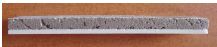
Slika 8.11. Prikaz vezivanja smole samo za donju površinu PUR pjene
