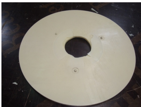
Slika 8.12. Prikaz sendvič konstrukcije dobivene centrifugalnim lijevanjem
