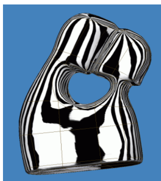
Slika 7.4. Analiza kontinuiranosti rekonstruiranog CAD modela pomoću "zebra uzorka"
