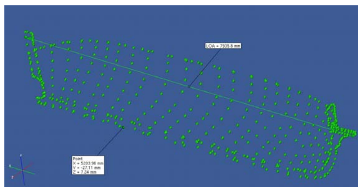
Slika 7.8. Rezultat fotogrametrijskog snimanja
