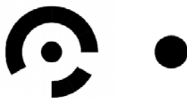
Slika 7.14. Kodirana (lijevo) i nekodirana (desno) mjerna točka
