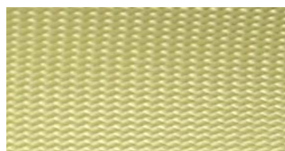
Slika 4.9. Aramidna vlakna (Kevlar)
