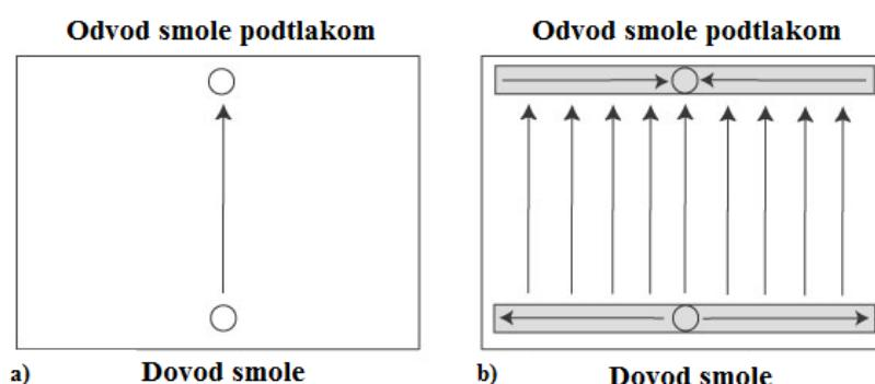
Slika 5.15. Pojednostavljeni prikaz nepravilnog i pravilnog postavljanja cijevi:
