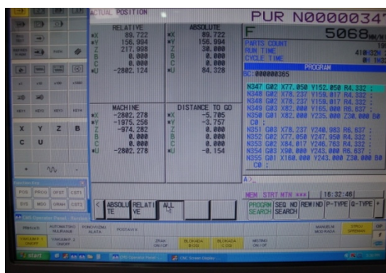
Slika 8.2. Prikaz sučelja računala peteroosne CNC glodalice
