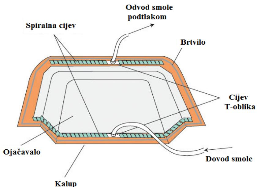
Slika 5.16. Prikaz upotrebe spiralnih cijevi kao produžetak cijevi za dovod i odvod smole [18]
