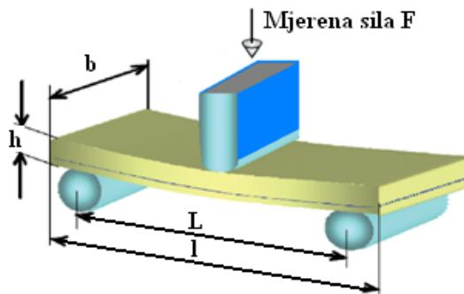
Slika 8.16. Pojednostavljeni prikaz ispitivanja savojne čvrstoće [31]
