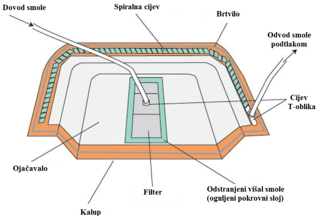
Slika 5.6.. Postupak podtlačnog ulijevanja s jednostavnim kalupom [18]
