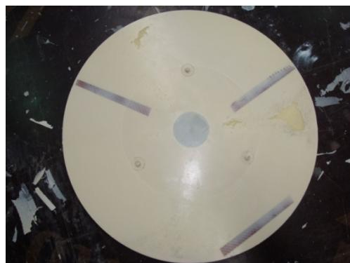
Slika 8.13. Prikaz upotrebe odstojnika pri izradi sendvič ploče
