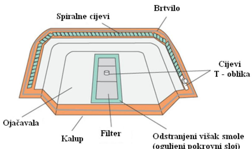
Slika 5.12. Prikaz postavljene spiralne cijevi duž ruba kalupa [18]
