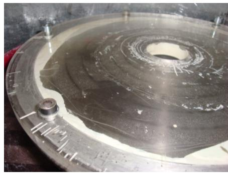
Slika 8.8 Prikaz zatvorenog kalupa uređaja za centrifugalno lijevanje
