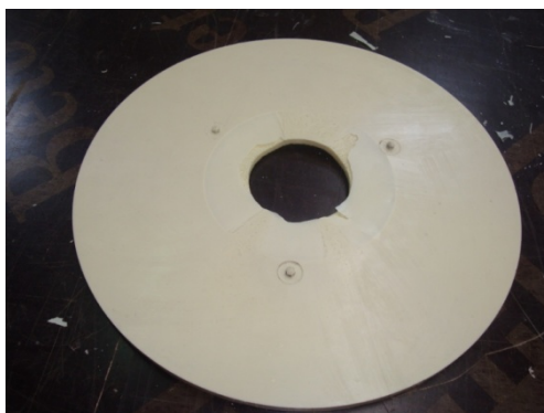
Slika 8.12. Prikaz sendvič konstrukcije dobivene centrifugalnim lijevanjem
