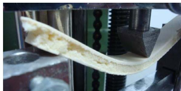
Slika 8.17. Prikaz progiba ispitnog tijela pri ispitivanju savojne čvrstoće
