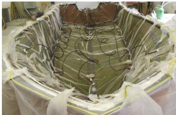
Slika 5.7. Prikaz raspodjele cijevi za dovod smole pri izradi trupa broda
