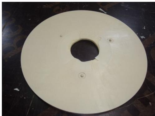
Slika 8.12. Prikaz sendvič konstrukcije dobivene centrifugalnim lijevanjem
