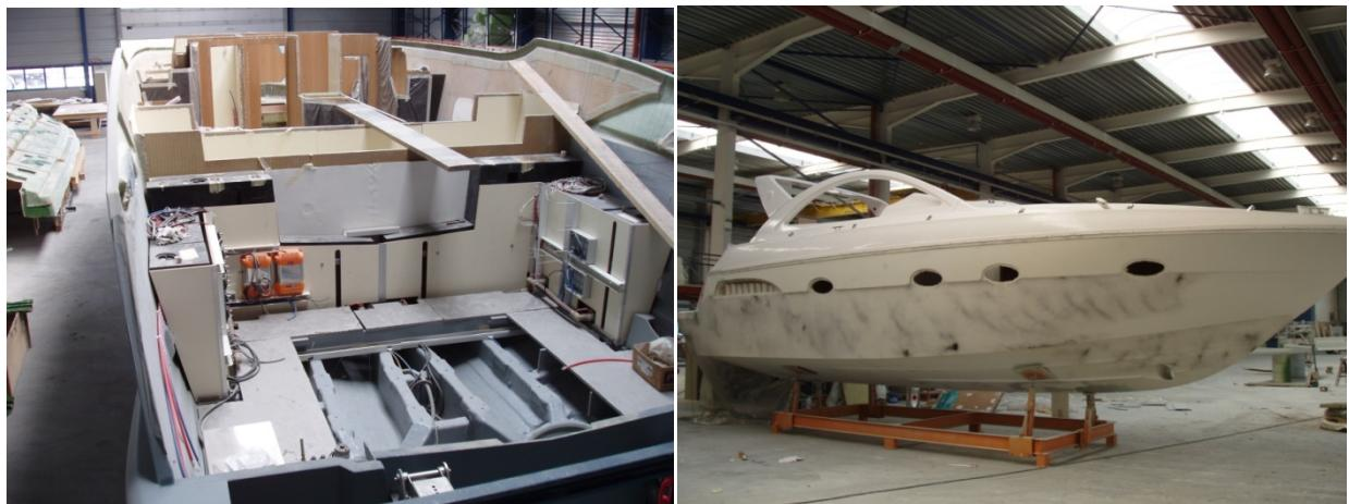
Slika 5.17. Prikaz ugradnje električnih i drugih instalacija u trup broda, te prikaz gotovog proizvoda [14]
