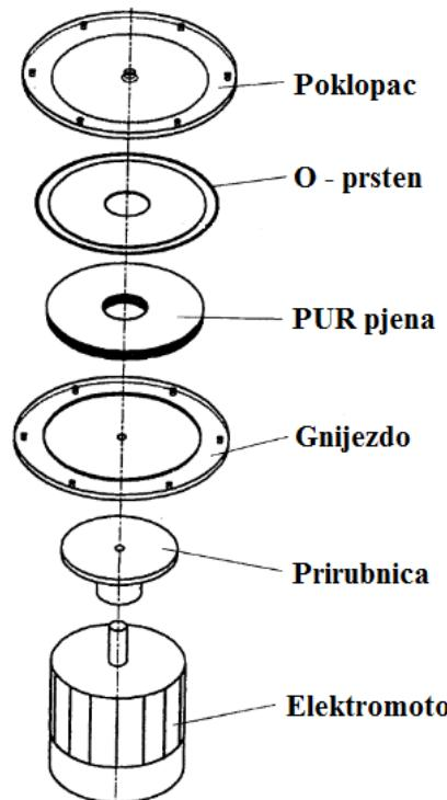
Slika 8.5. Uređaj za centrifugalno lijevanje [30]
