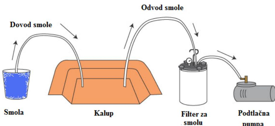
Slika 5.5. Pojednostavljeni prikaz postupka podtlačnog ulijevanja [18]
