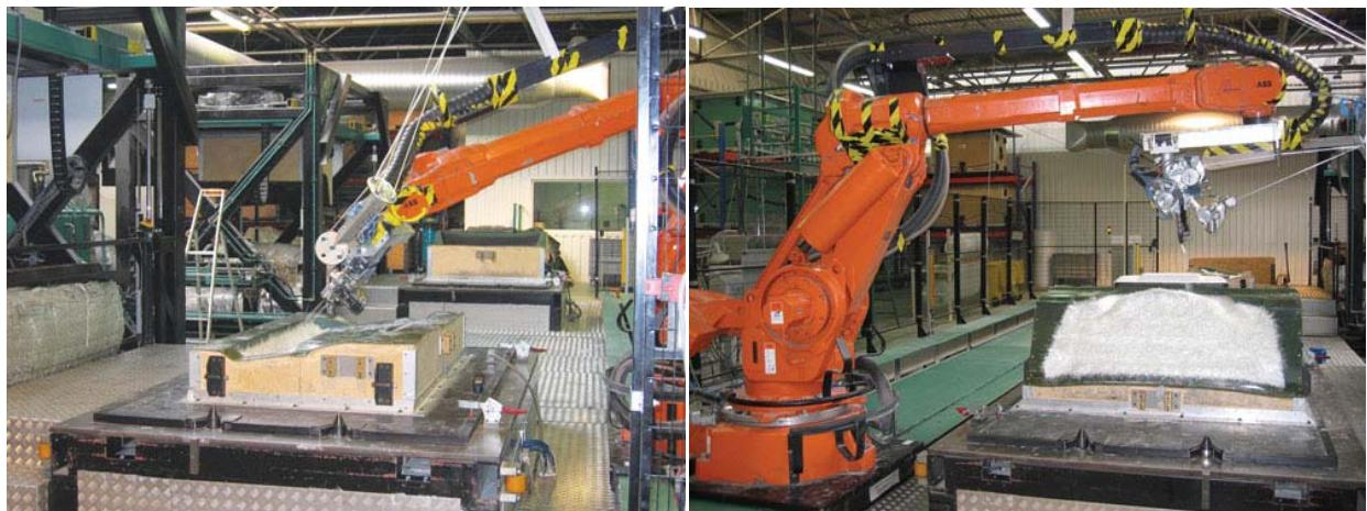
Slika 6.2. Prikaz upotrebe automatizirane robotske ruke za postupak štrcanja vlakana [26]
