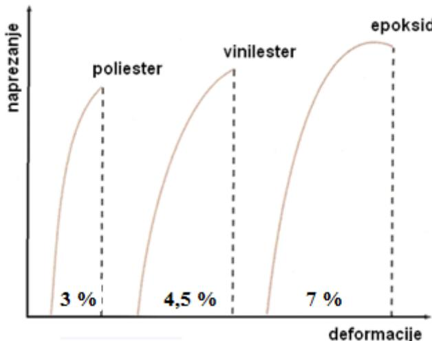
Slika 4.11. Dijagram prekidnog naprezanja-deformacija tri vrste smola [7]
