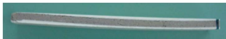
Slika 8.19. Prikaz ispitnog tijela s jednolikom raspoređenom smolom s obje strane PUR pjene
