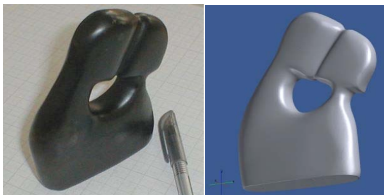
Slika 7.2.. Originalni predmet koji je potrebno rekonstruirati i rezultat 3D digitalizacije
