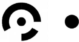
Slika 7.14. Kodirana (lijevo) i nekodirana (desno) mjerna točka
