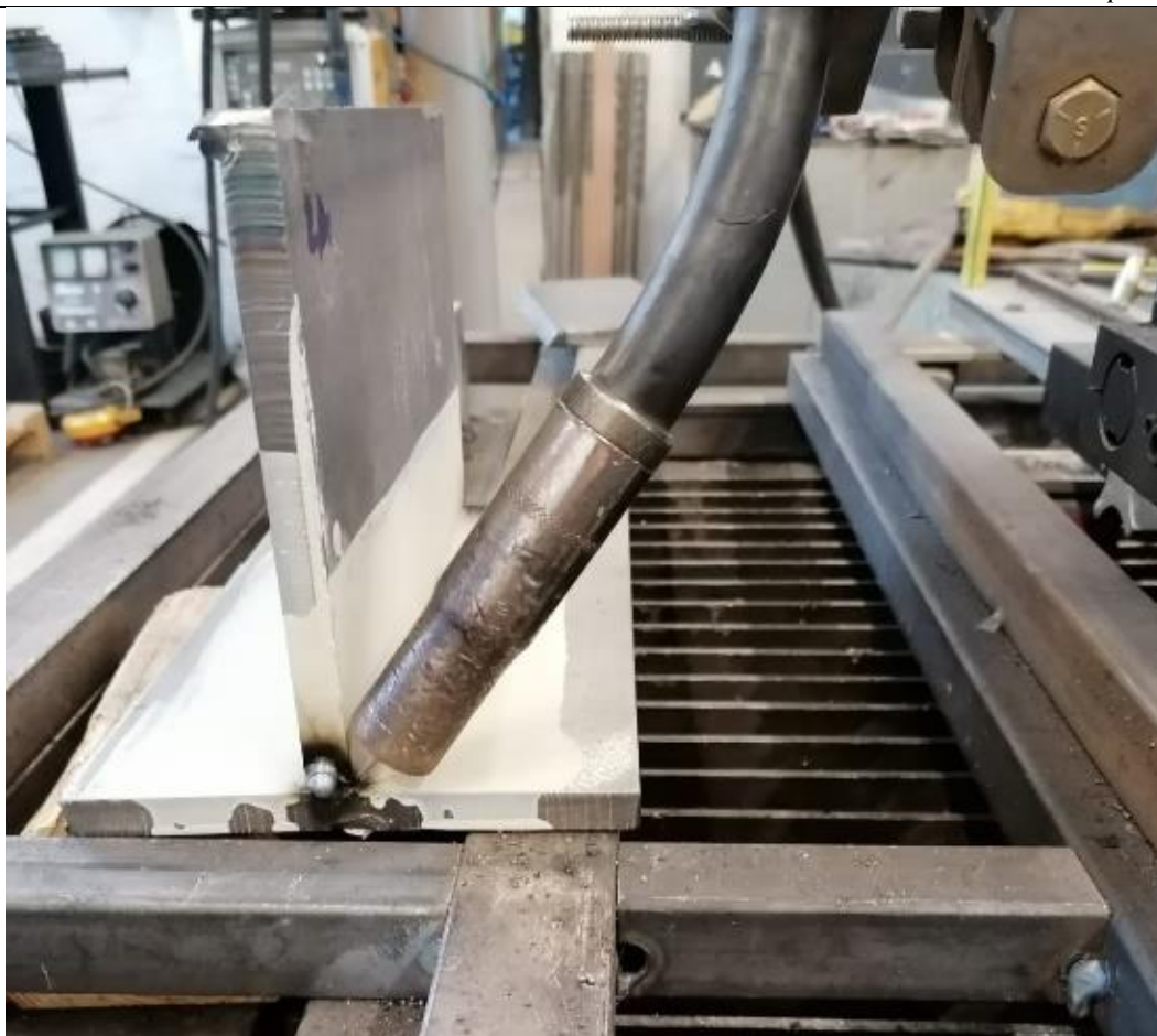
Slika 45. Položaj pištolja za zavarivanje MAG postupkom
