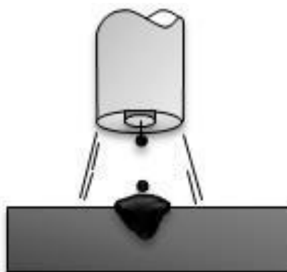
Slika 13. Shematski prikaz prijenosa kratkim spojem[21]
