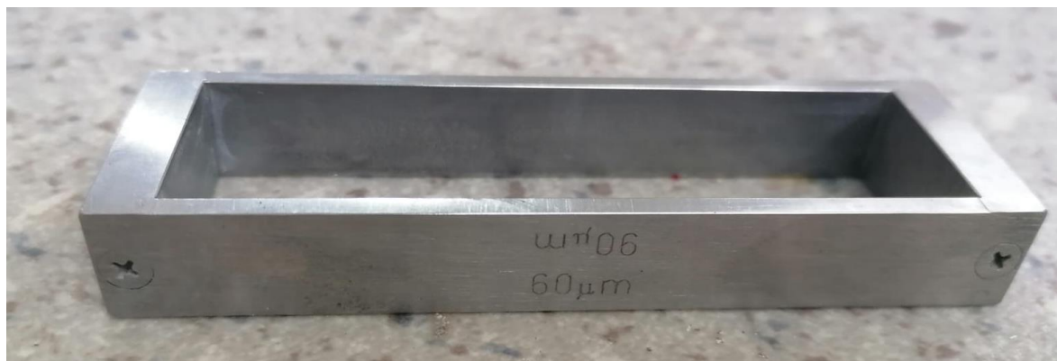
Slika 33. Kubni aplikator proizvođača Elcometer
