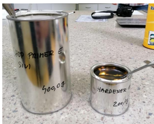
Slika 30. Dvokomponentni temeljni premaz SHOP primer E
