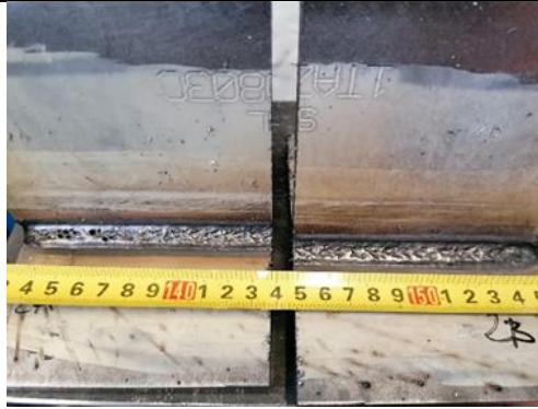
Slika 55. Uzorci 2A i 2B za ispitivanje savijanjem
