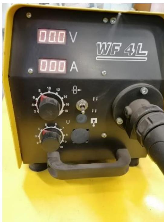
Slika 48. Postavljeni parametri FCAW zavarivanja
