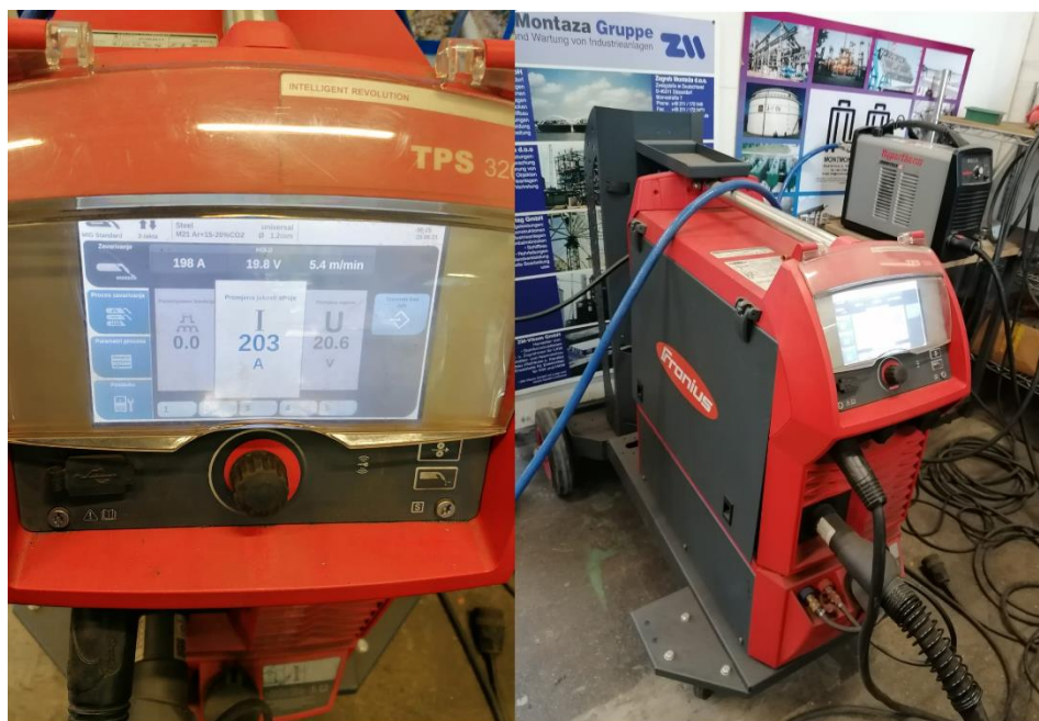
Slika 40. Fronius TPS 320i i pripadajući parametri zavarivanja
