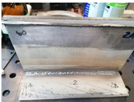
Slika 52. Podjela uzorka 2 na dijelove za ispitivanje
