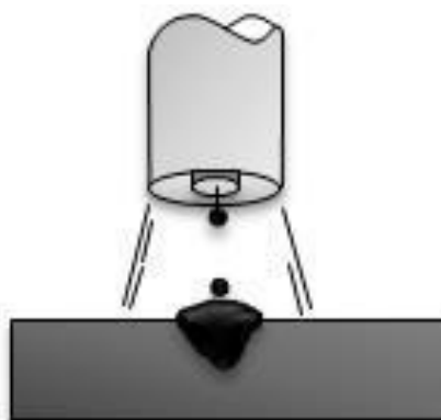
Slika 13. Shematski prikaz prijenosa kratkim spojem[21]
