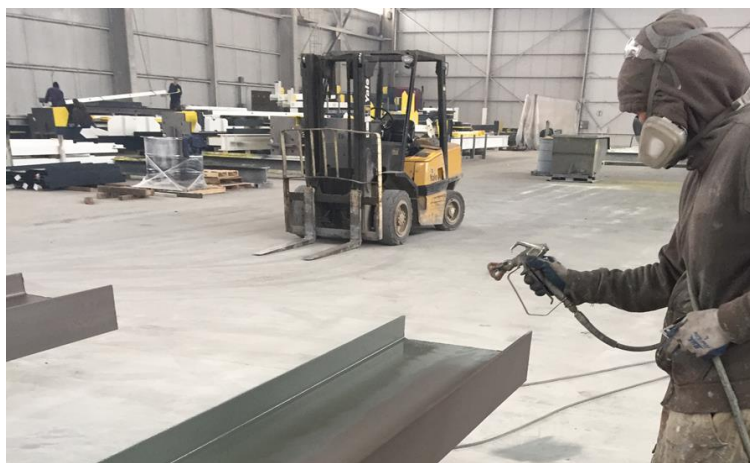
Slika 5. Ručno nanošenje cink – epoksi temeljnog premaza u brodograđevnoj industriji[14]
