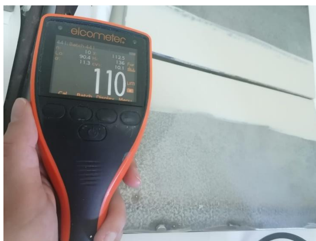
Slika 38. Prikaz rezultata mjerenja debljine pomoću uređaja Elcometer 456/4
