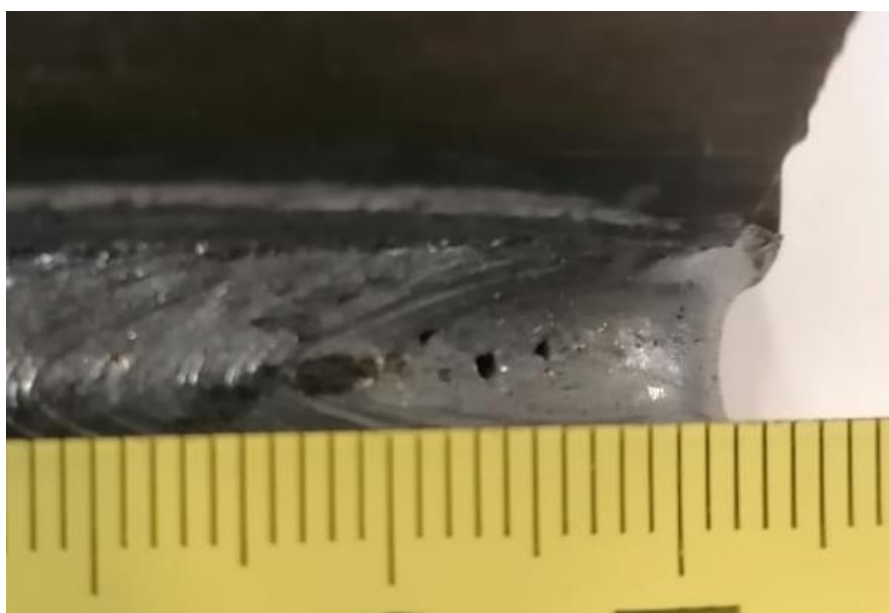
Slika 46. Nepravilnost na uzorku 1A'
