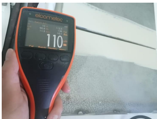
Slika 37. Postupak mjerenja debljine premaza
