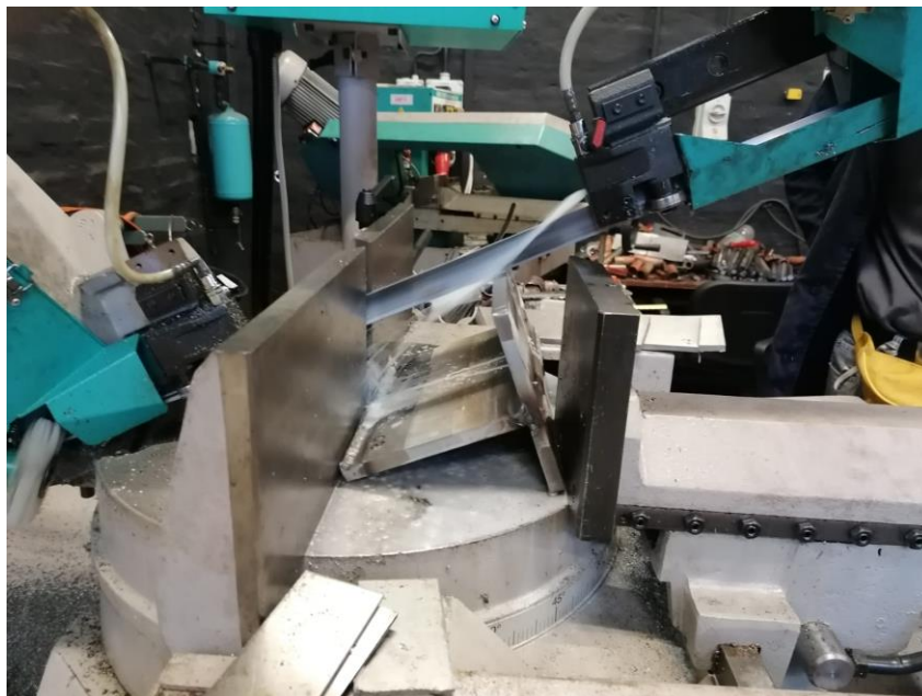
Slika 53. Izrezivanje uzoraka za ispitivanje
