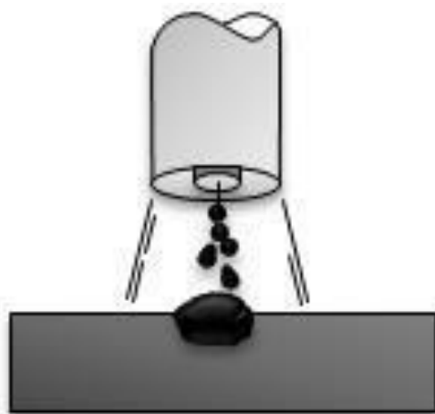
Slika 15. Shematski prikaz za prijelazni luk[21]
