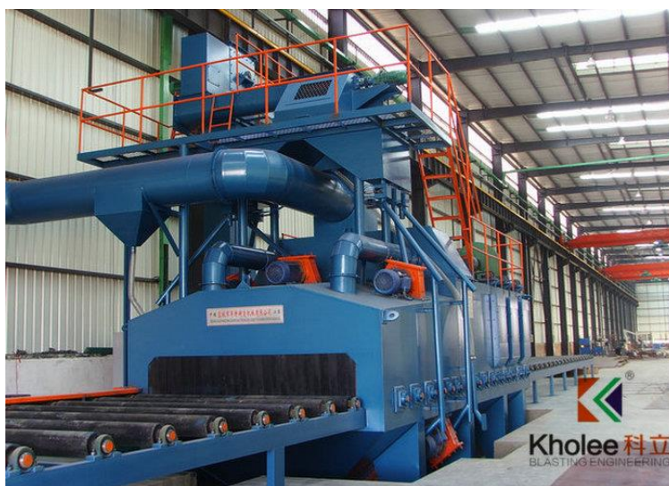
Slika 2. Sačmarenje pomoću automatiziranog stroja u brodogradnjoj industriji[11]
