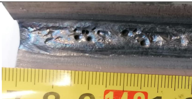
Slika 50. Nepravilnosti na uzorku 2A
