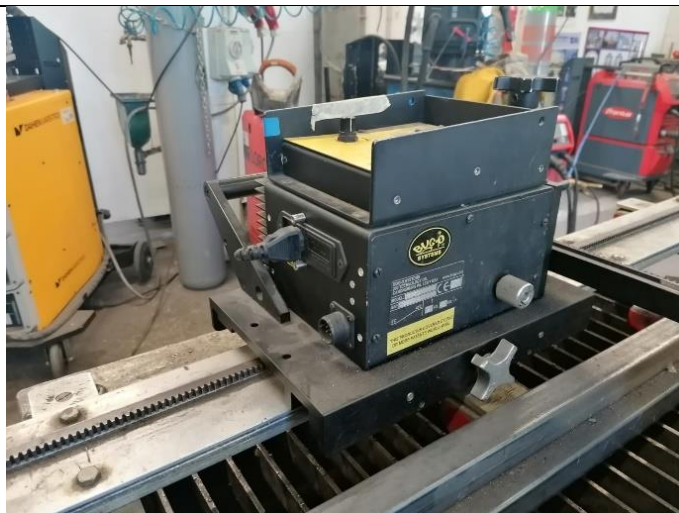
Slika 43. „Bugo Systems“, uređaj za automatiziranje postupka zavarivanja
