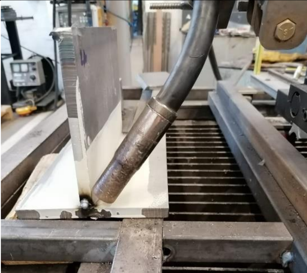
Slika 45. Položaj pištolja za zavarivanje MAG postupkom
