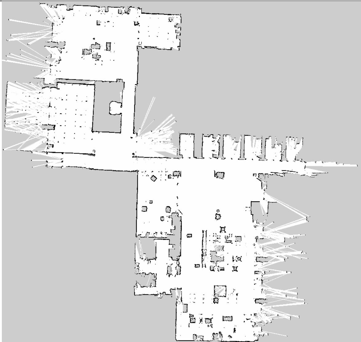
**Slika 31.** Tlocrt *CRTA*-e snimljen mobilnim robotom
