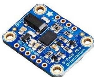
**Slika 13. Prikaz IMU-a Bosch BNO055 [10]**
