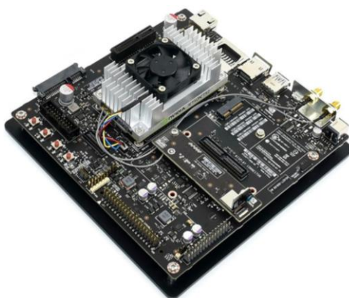
Slika 16. je Nvidia Jetson TX2 Developer Kit [12]
