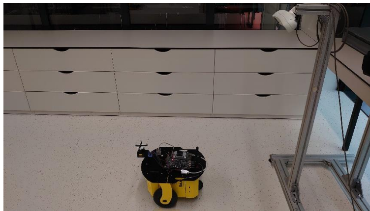
Slika 46. Postav za mjerenje točnosti lokalnih planera
