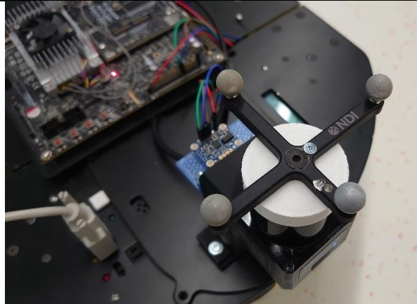
Slika 45. Pozicija markera na robotu
