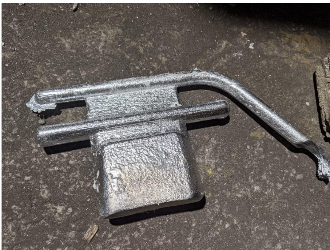
Slika 11. Odljevak za ispitivanje mehaničkih svojstava s uljevnim sustavom
