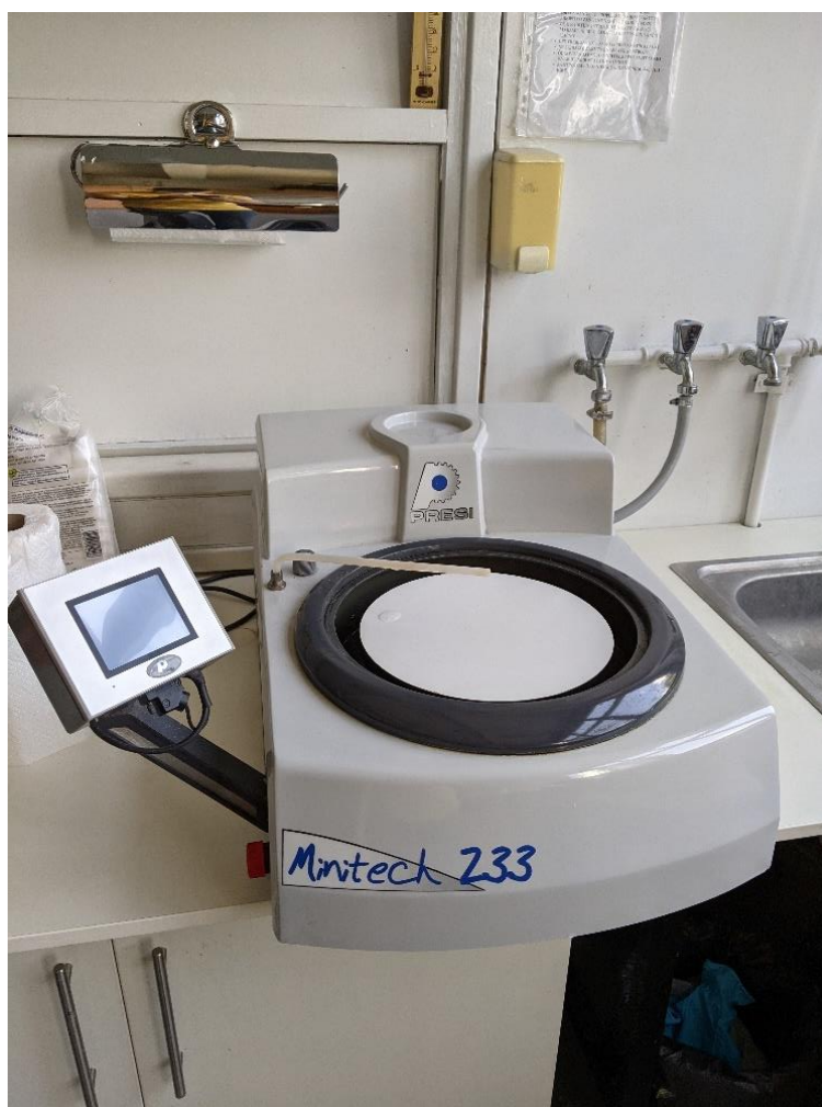
Slika 30. Uređaj za brušenje „Mintech 233“
