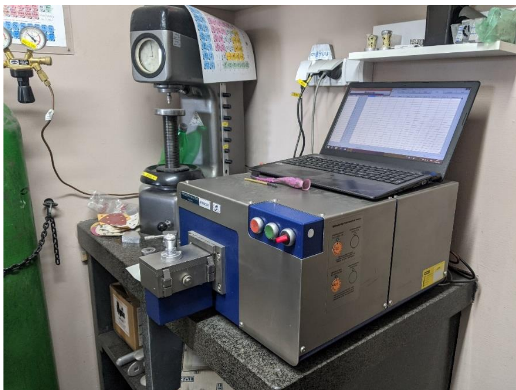
Slika 18. Uređaj za kemijsku analizu, Hitachi Foundry-Master
