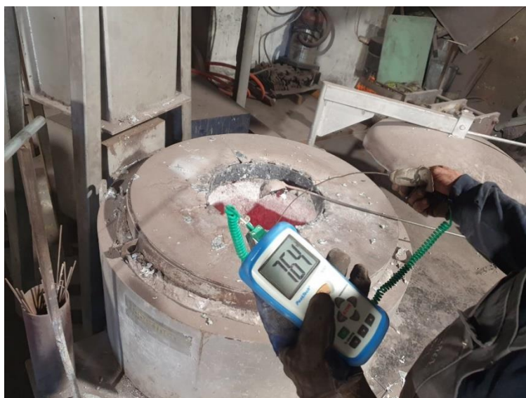
Slika 19. Provjera temperature taline u peći
