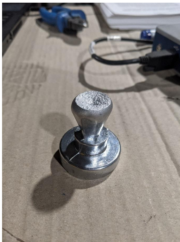
Slika 12. Odljevak za ispitivanje kemijskog sastava
