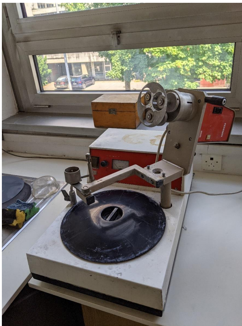
Slika 31. Uređaj za poliranje „Struers DAP-V“
