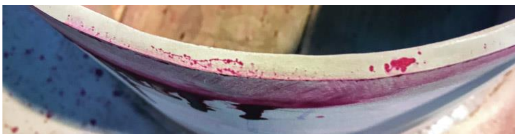
Slika 18. Ispitivanje penetrantom crvenog pigmenta [21]
