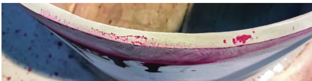
Slika 18. Ispitivanje penetrantom crvenog pigmenta [21]
