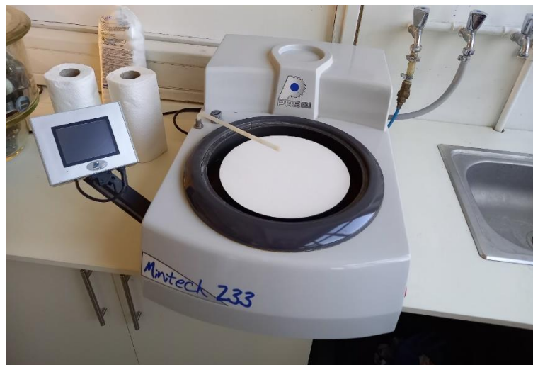
Slika 29. Uređaj za ručno poliranje Presi Minitech 233
