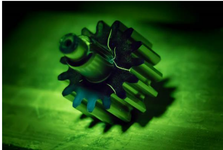
Slika 19. Ispitivanje fluorescentnim penetrantom [22]
