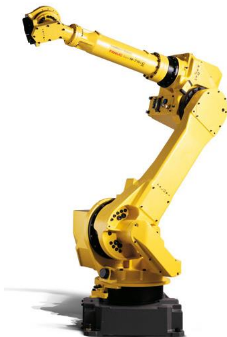
Slika 35. Šesteroosni robot Fanuc M-710iC/50 [18]
