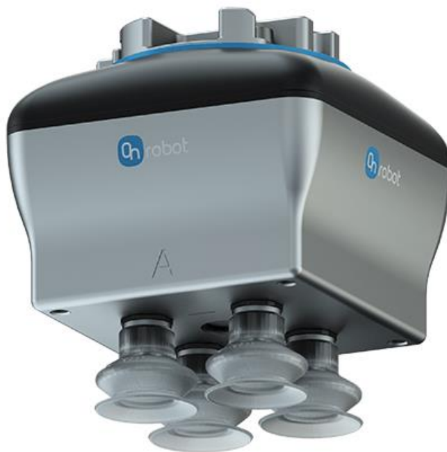
Slika 37. Vakuumska hvataljka kapaciteta 15 kg [19]
