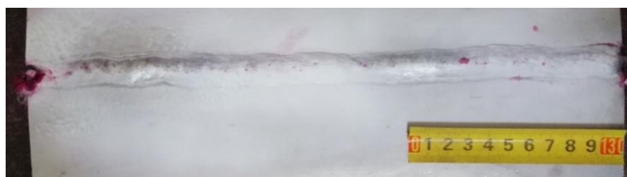
Slika 51. Korijen zavara sa nanesenim penetrantom i razvijачem
