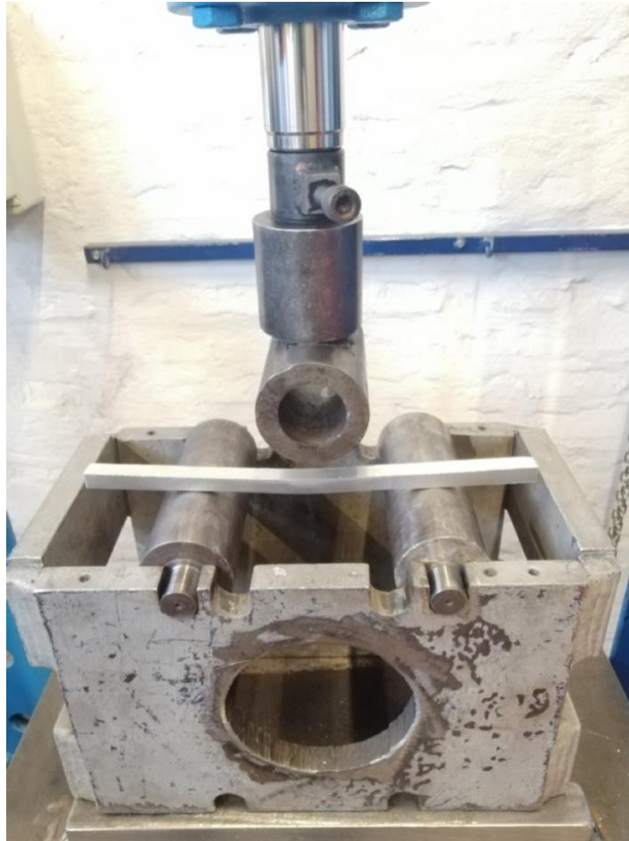
Slika 55. Prikaz ispitivanja savijanjem u Laboratoriju za zavarivanje na FSB-u
