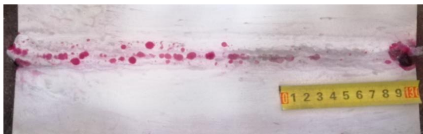
Slika 52. Lice zavora sa nanesenim penetrantom i razvijачem
