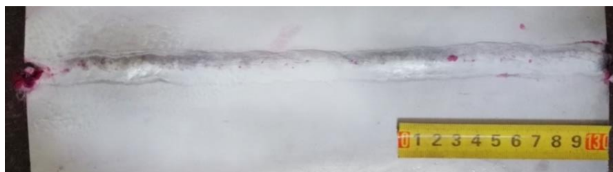
Slika 51. Korijen zavara sa nanesenim penetrantom i razvijачem
