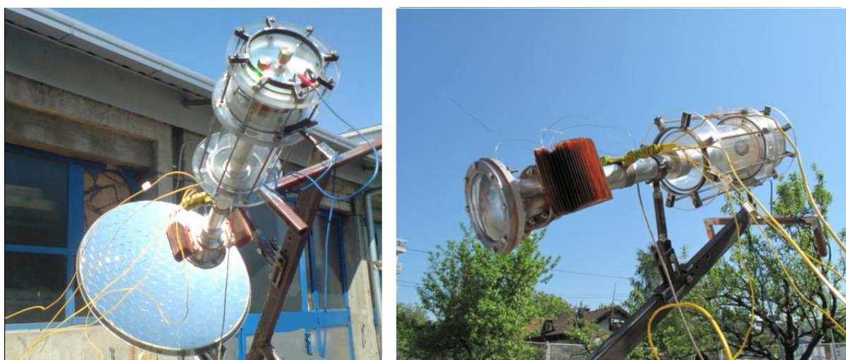
Slika 51. Termoakustički generator u radu sa koncentriranim sunčevim zračenjem
