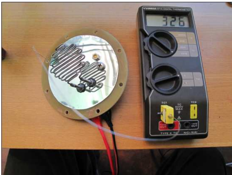
Slika 22. Mjerenje karakteristika električnog grijača
